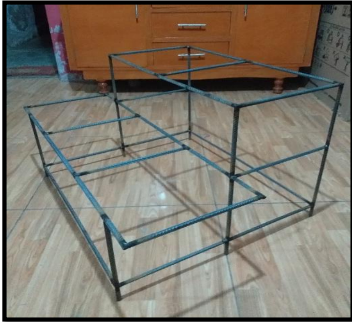
Figura 32. Base del biofiltro.
