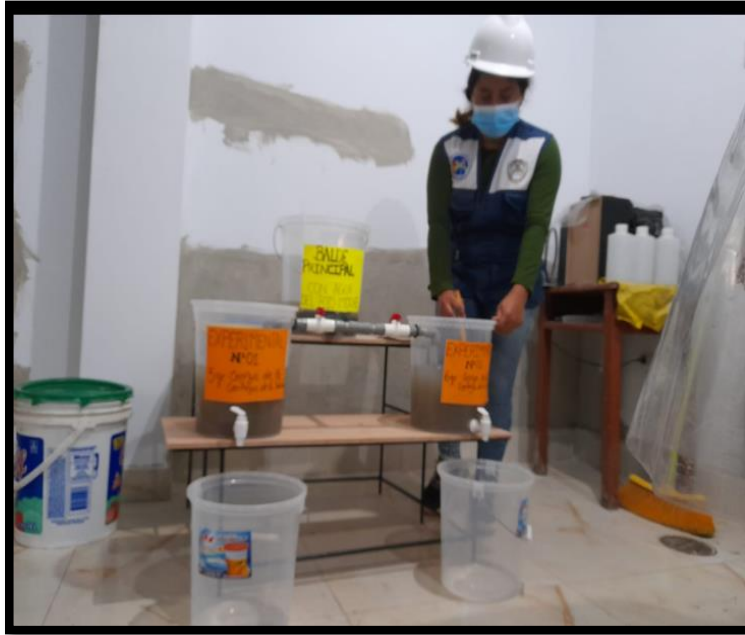
Figura 59. Removiendo las cenizas de sábila con el agua del Experimental N°02
