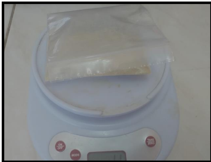
Figura 22. Se tomó 17.5 gr de corteza de sábila molida para el ensayo de Análisis térmico diferencial.
