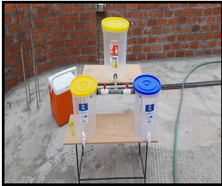
Figura 33. Instalación del biofiltro.
