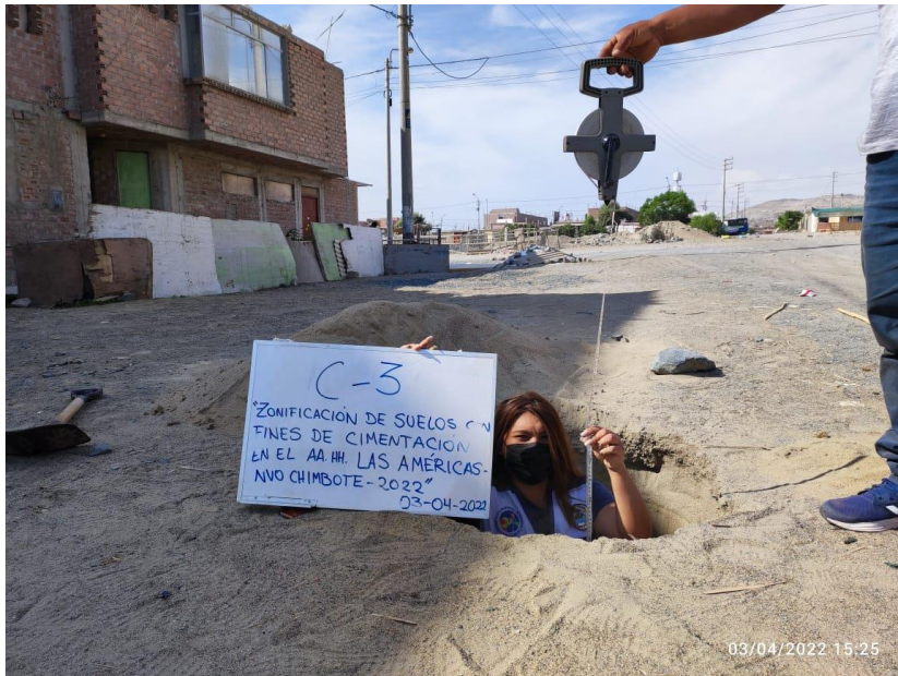
FOTO N°6: EXCAVACIÓN DE LA CALICATA 3
