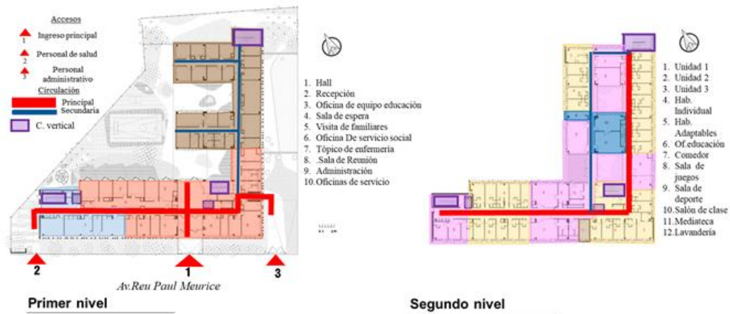
Figura 36. Relación funcional entre ambientes, accesos, zonas y circulación del Centro de Bienestar para niños y adolescentes. Fuente: Archidaly.
