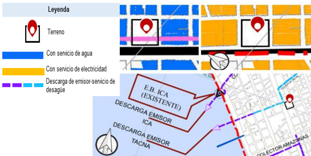
Figura 13. Plano de cobertura de agua potable, electricidad y de desagüe. Fuente: PDU.
