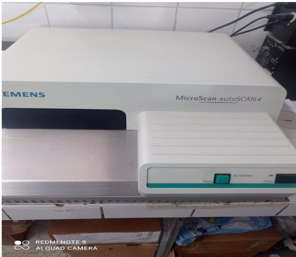
Equipo MicroScan AutoSCAN4 para lectura de antibiogramas e identificación de microorganismos automatizados
