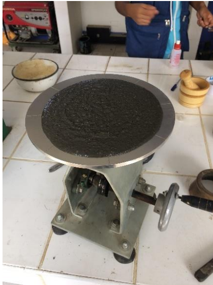
figura 16: Colocación de la mezcla en la mesa de Fluidos
