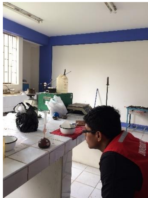
figura 22: Llenado de la Combinación de la mezcla de Cemento + Ceniza de Cáscara de Arroz.
