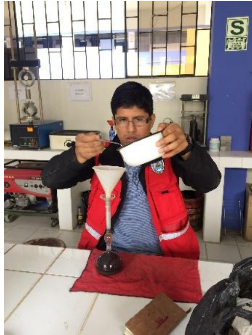
figura 22: Llenado de la Combinación de la mezcla de Cemento + Ceniza de Cáscara de Arroz.
