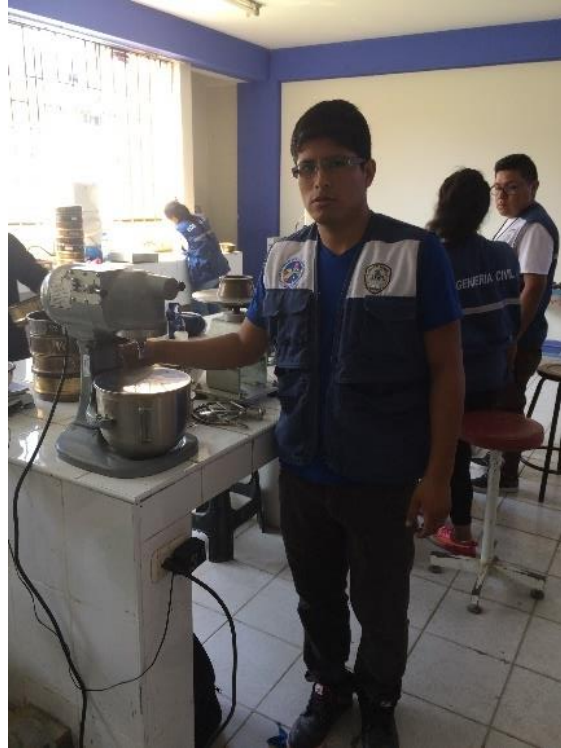
figura 15: Mezcladora de materiales
