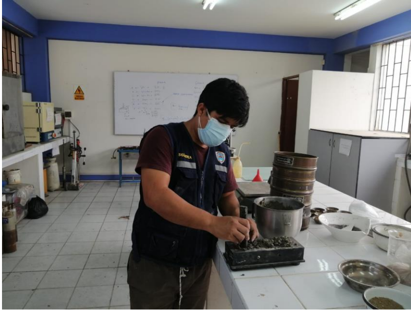
figura 26: Vaciado de la mezcla en los moldes en el Laboratorio de la USP – Ensayo de Permeabilidad.
