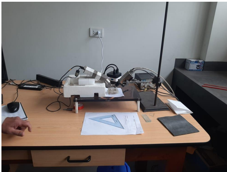
figura 28: Facultad de Ciencias físicas – Laboratorio de Arqueometría Equipo de Espectro FRXDE – Ensayo de Florescencia – UNSM.
