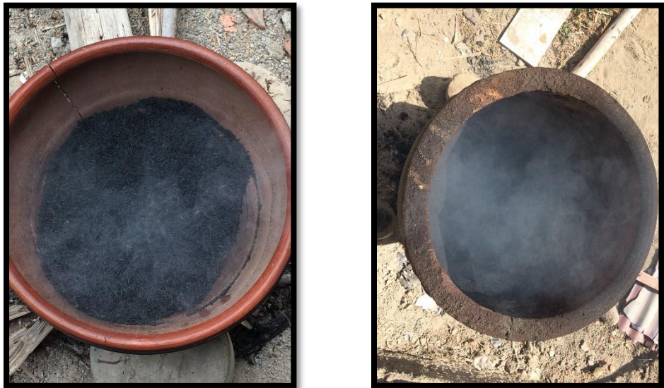
Figura 04: Pre calcinación del arroz en una olla de barro con briqueta.
