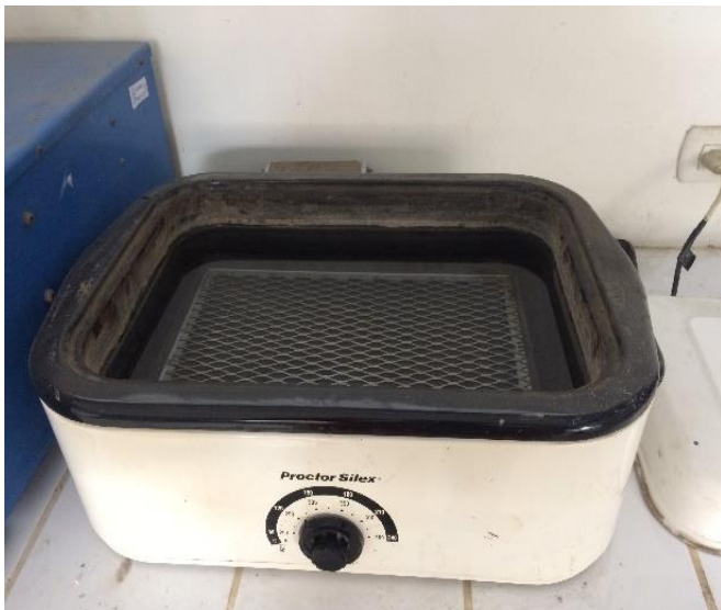
figura 21: Aparato del Baño María y Le Chatelier para el ensayo del Nuevo Cemento (CENIZA DE CÁSCARA DE ARROZ + CEMENTO) Peso Específico Relativo
