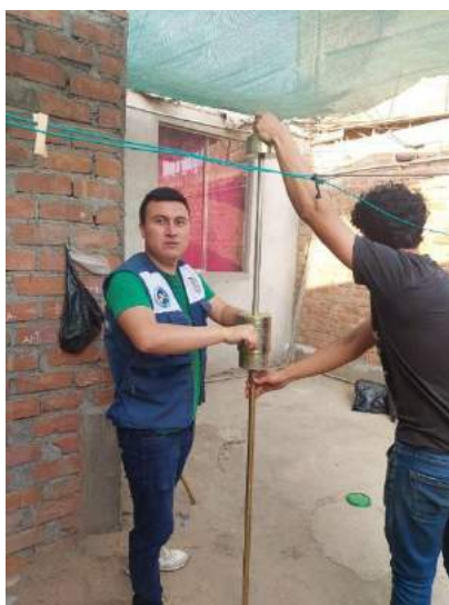
Figura 7 Realización del DPL en la vivienda de Jr. Atahualpa Mz. A Lt. 19
