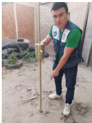
Figura 3 Ensayo de Penetración Dinámica Ligera - DPL
