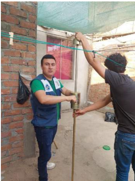
FOTO N° 4 y 5: Procediendo a realizar el ensayo de DPL en las viviendas con ayuda del técnico del laboratorio AGAMES E.I.R.L.
