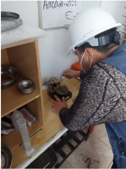
FOTO N° 2: Ensayando la muestra de suelo para determinar si presenta límite líquido.
