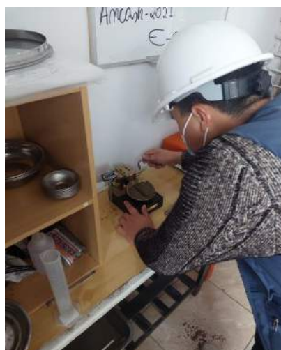
Figura 6 Realización de ensayo de consistencia
