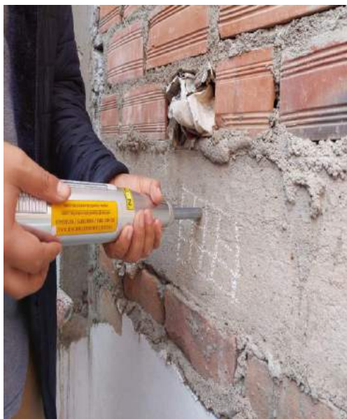
FOTO N° 6: Esclerometría aplicada a la viga en la vivienda 1 que está ubicada en Jr. Los Alamos Mz. N Lt. 6
