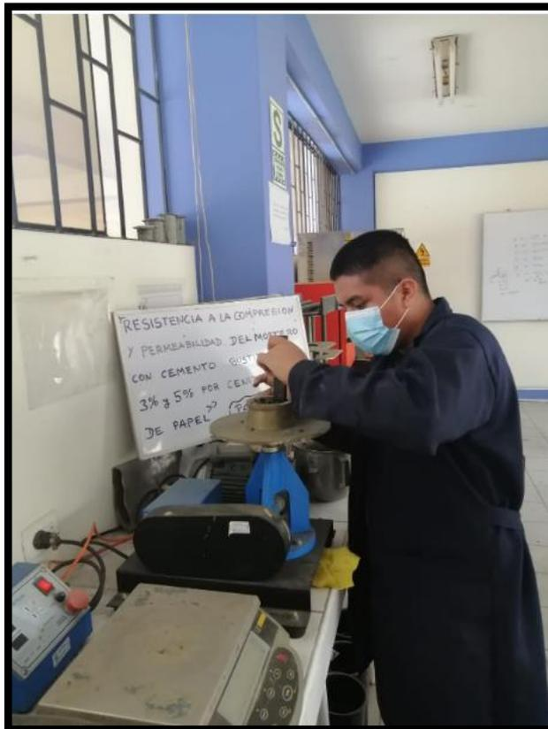
**Figura 15.** Se procede a realizar levemente el ensayo en la mesa de flujo
