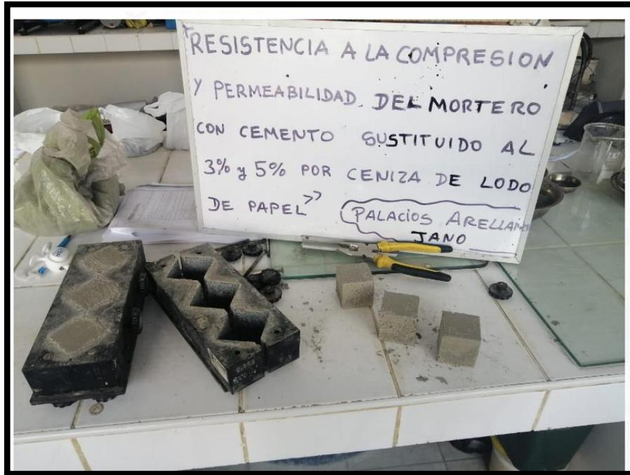
**Figura 22.** Desencofrado de los morteros realizados
