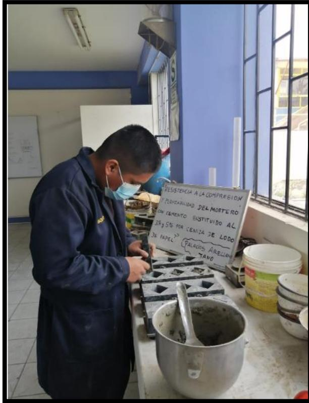
**Figura 20.** Se aplica presión para una mejor dosificación
