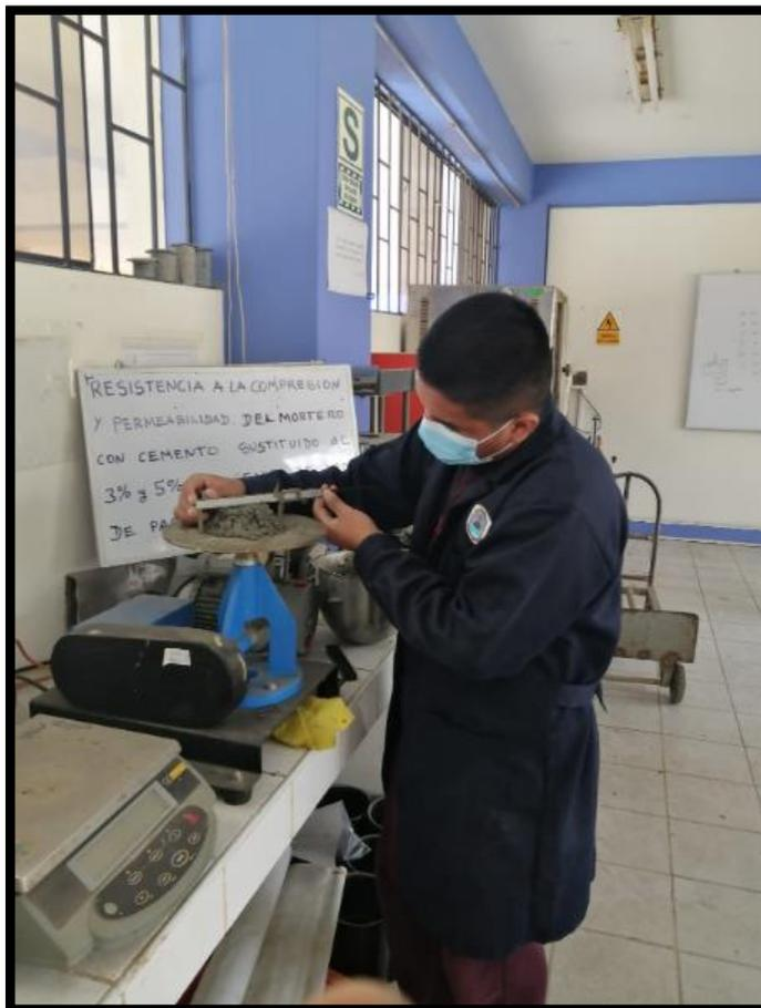
**Figura 17. Medición de la muestra con el vernier**
