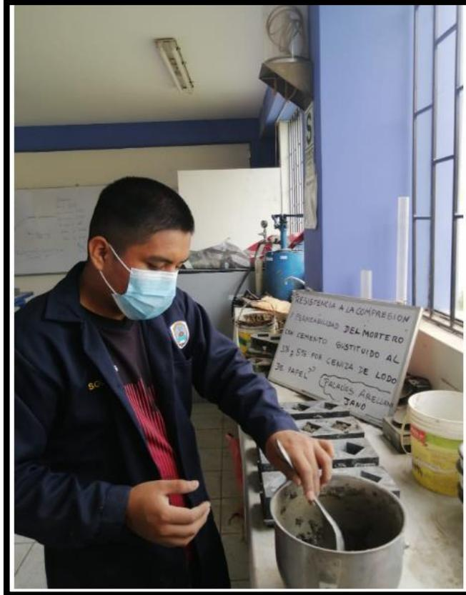
**Figura 18.** Se procede a vaciar la muestra en los moldes de mortero
