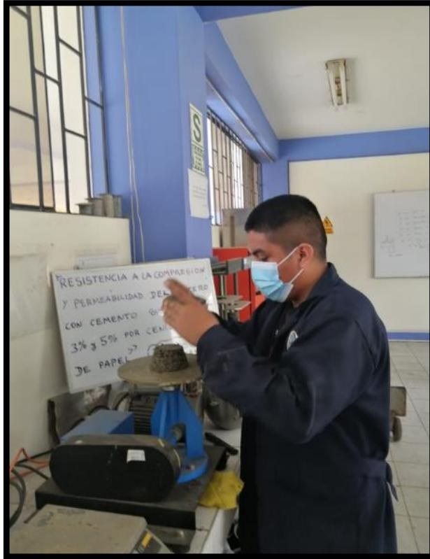
**Figura 16. Se retira el molde para evaluar la muestra**
