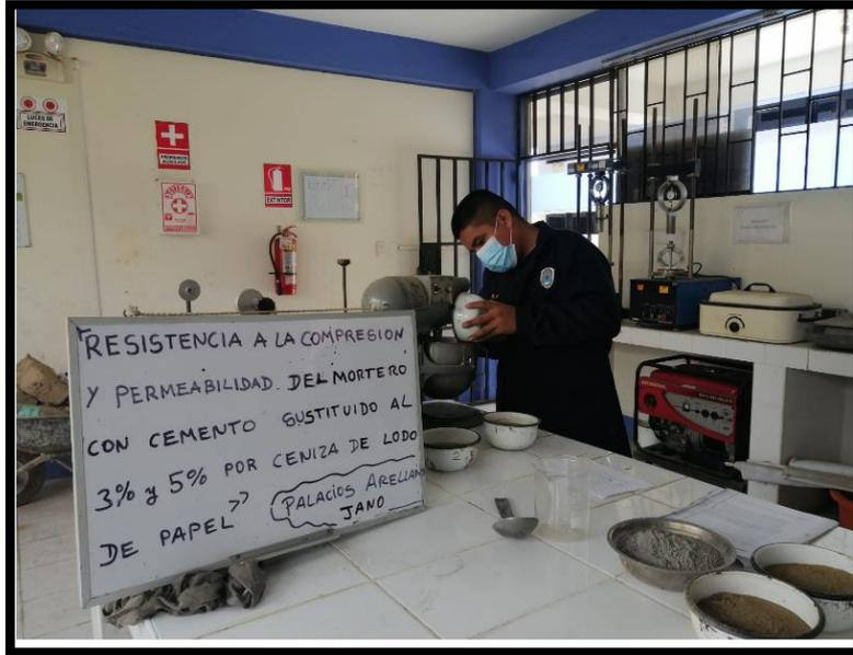
**Figura 12.** Se coloca los agregados a la mescladora.
