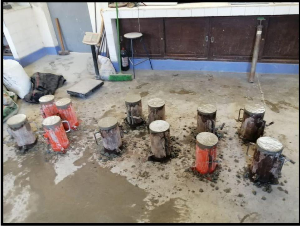
*Figura 19.* Probetas terminadas lista para su tiempo de fragua
