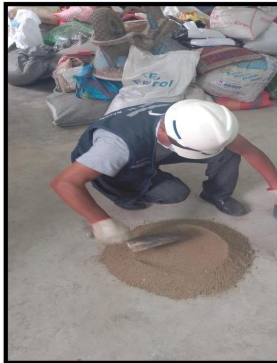
**Figura 14.** Cuarteo del agregado fino para hacer el ensayo de P.U. compactado y seco
