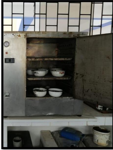
*Figura 9.* Agregados en el horno para hacer el ensayo
