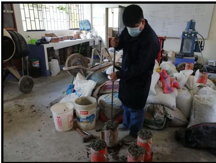
*Figura 18.* Chuseado del concreto para el concreto
