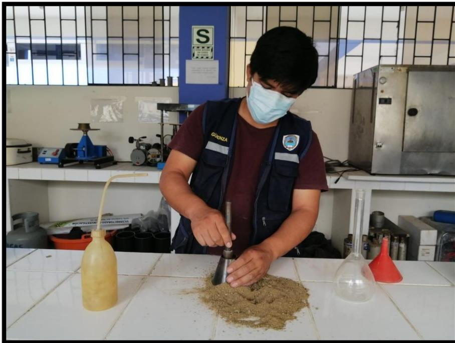
*Figura 10.* Peso unitario suelto y seco
