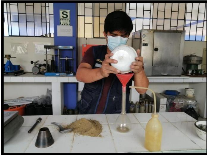
*Figura 11.* Peso unitario suelto y seco
