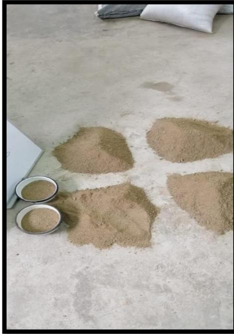
*Figura 15.* Muestras del agregado fino en la tara
