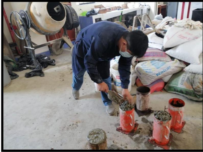
*Figura 17.* Vaciado de concreto a las probetas
