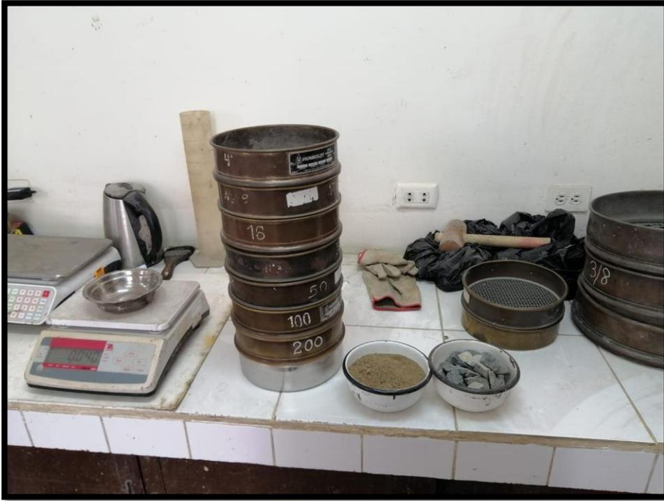
*Figura 7.* Muestras pasantes del tamizaje del agregado fino y grueso
