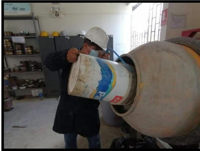
*Figura 16.* Vaciado del agregado fino al trompo
