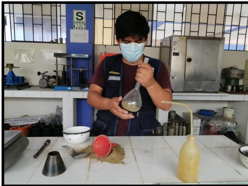
*Figura 12.* Peso unitario suelto y seco
