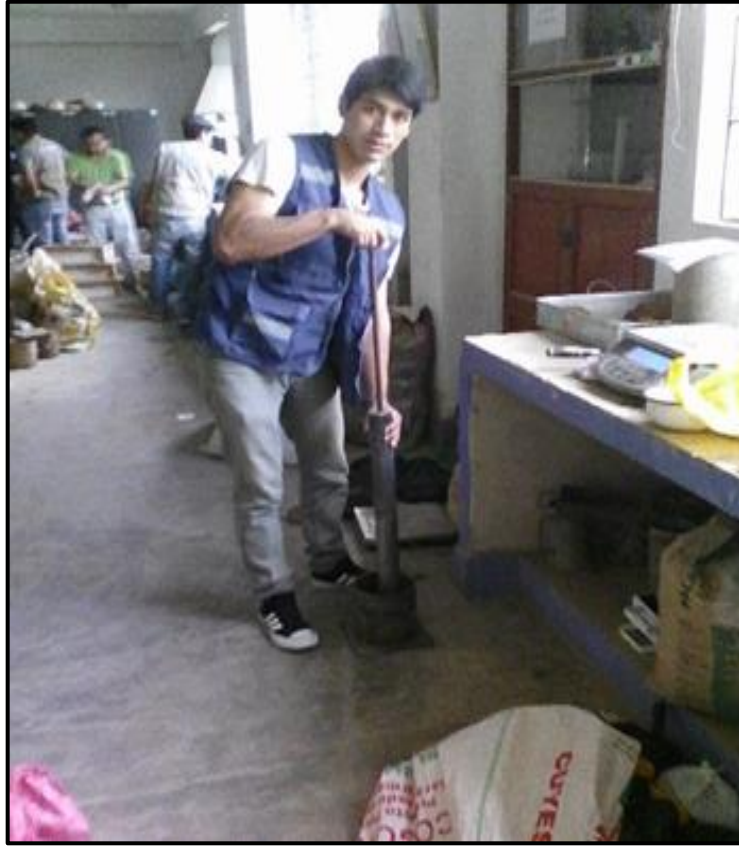
Figura 47: Compactando con el pisón , 56 golpes por capa
