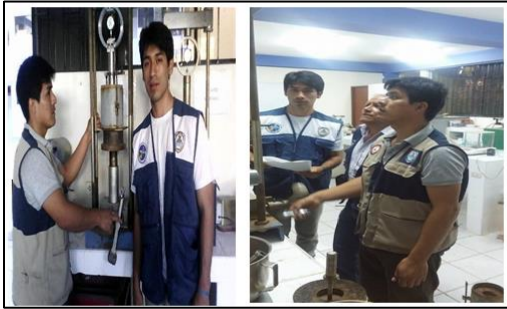
Figura 51: Obteniendo las lecturas de dial en la máquina de penetración de CBR
