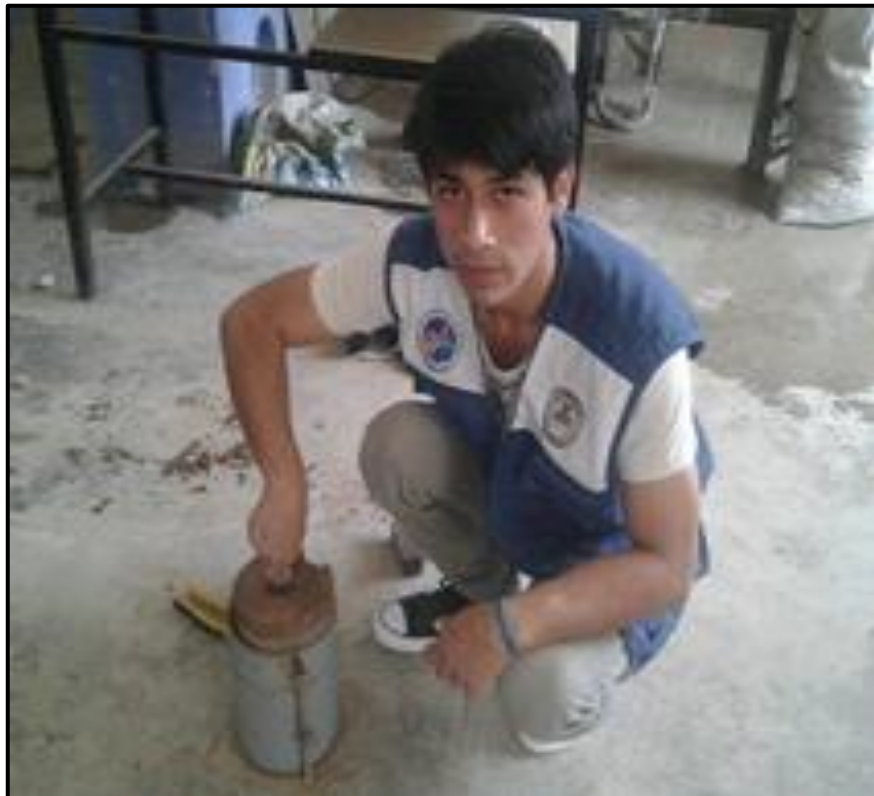
Figura 49: Colocando los pesos en los moldes para poder calcular la sobrecarga
