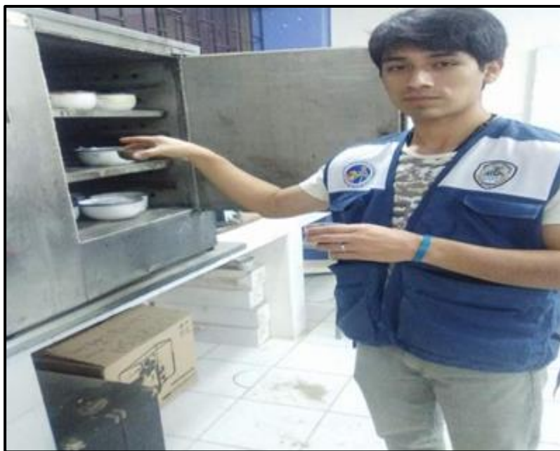
Figura 42: Colocando las muestras húmedas en el horno para su respectivo secado
