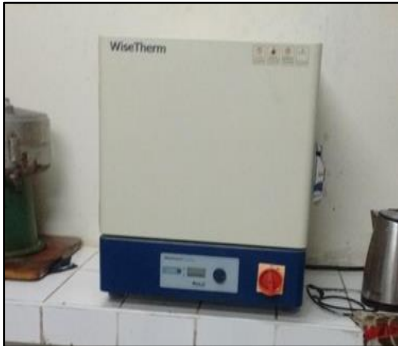
Figura 36: Quemado de la ceniza de cáscara de arroz (pre - calcinada) a una temperatura de 300° C
