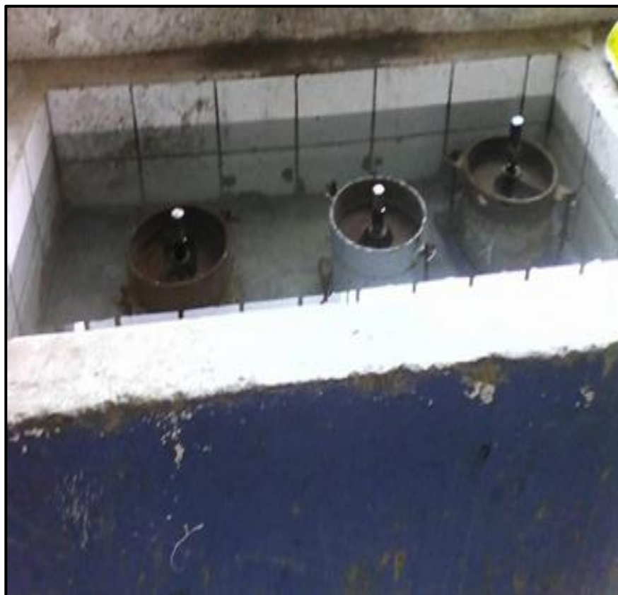
Figura 50: Realizando el curado de las muestras por un tiempo de 96 horas
