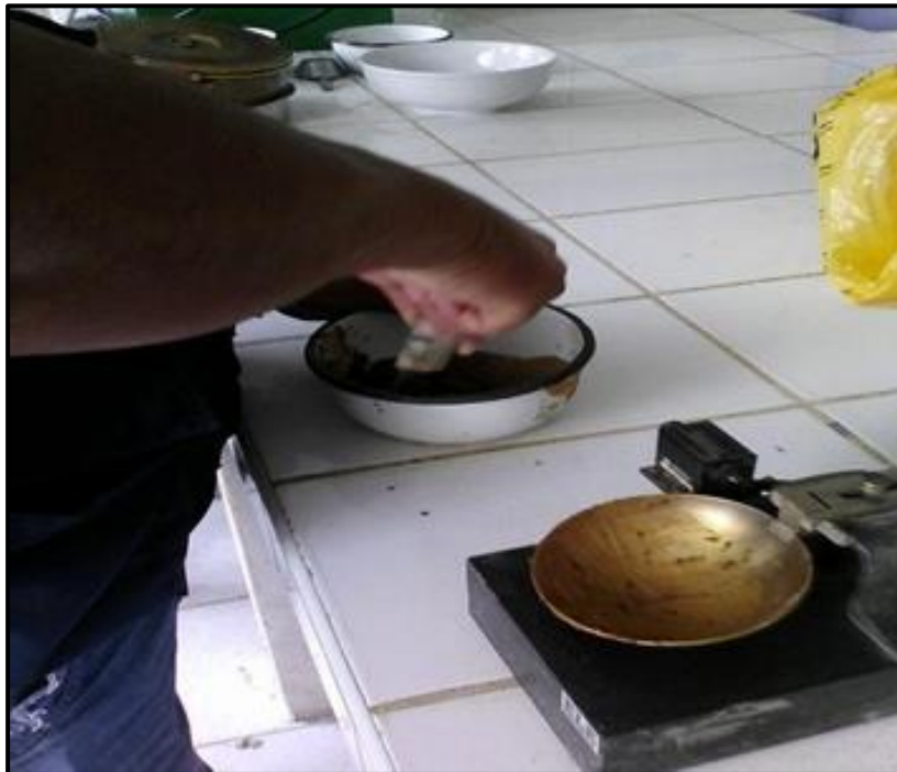
Figura 39: Amasando la muestra con agua para poder conseguir una pasta homogénea
