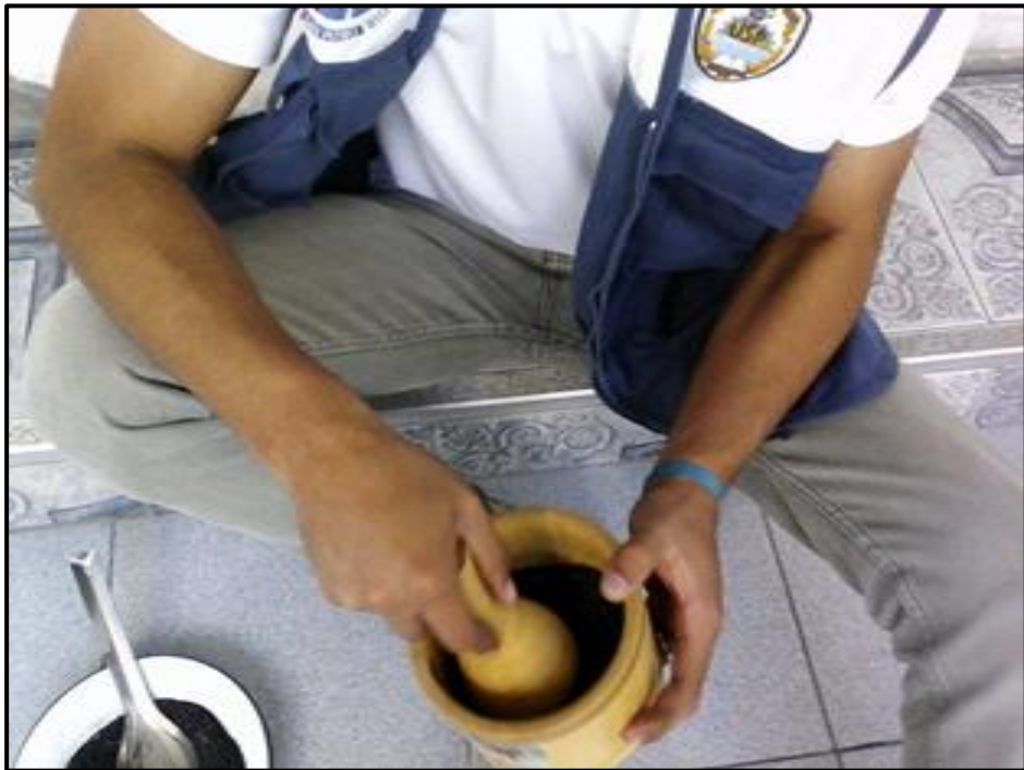
Figura 35: Moliendo la ceniza de cáscara de arroz (pre - calcinada)
