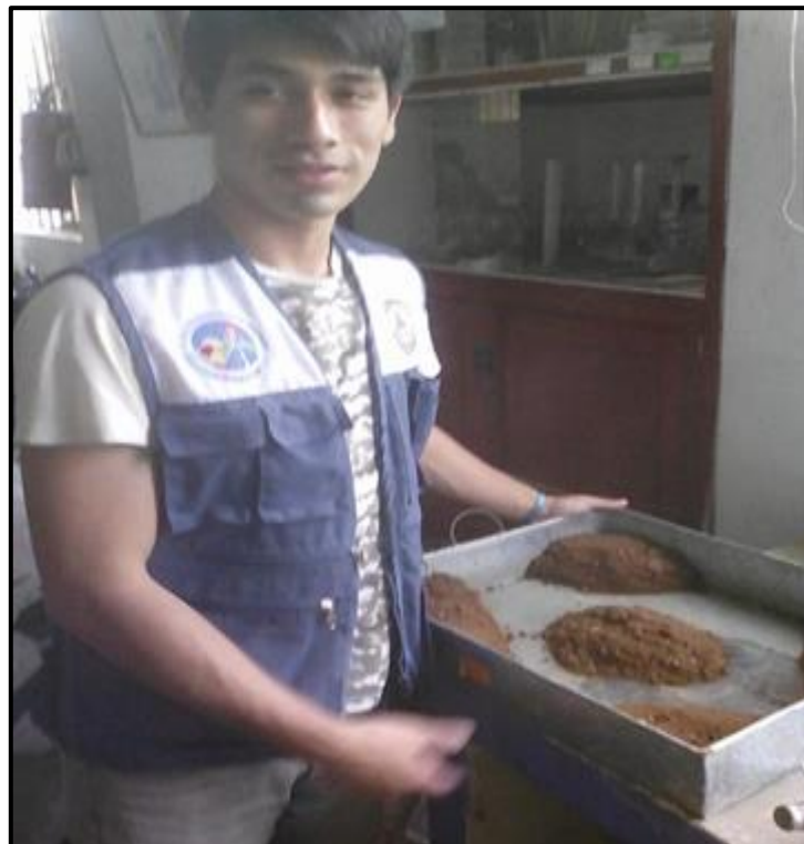
Figura 46: Separación del afirmado en cinco capas para poder realizar la compactación.
