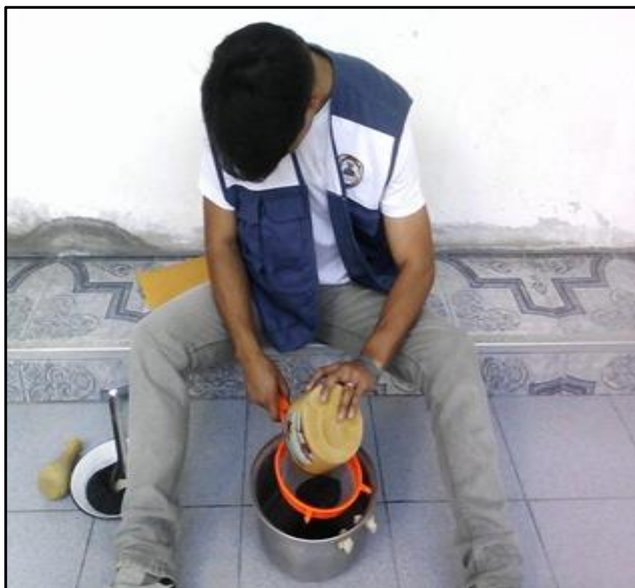
Figura 35: Tamizando la ceniza de cáscara de arroz (pre - calcinada) haciendo uso de la organza
