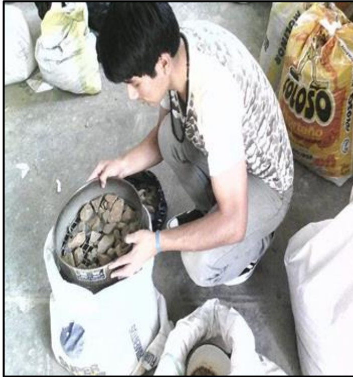
Figura 44: Realizando el tamizado del afirmado
