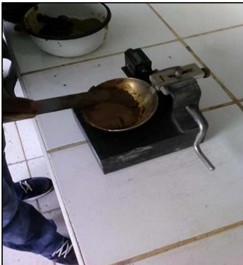
Figura 40: Colocando la muestra dentro de la cuchara de casagrande
