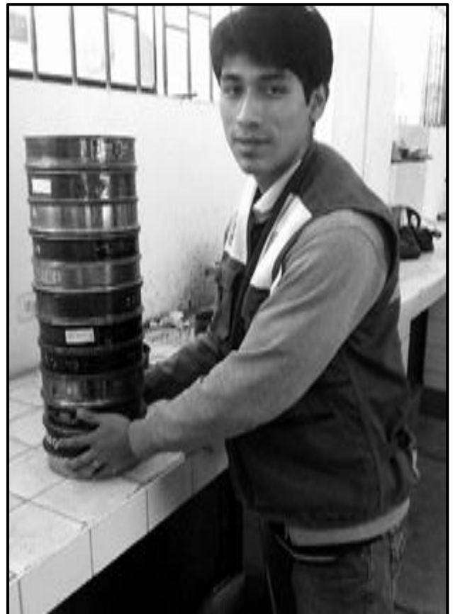
Figura 37 y 38: Realizando el Ensayo de Granulometría del afirmado de la cantera Sol de Huarney
