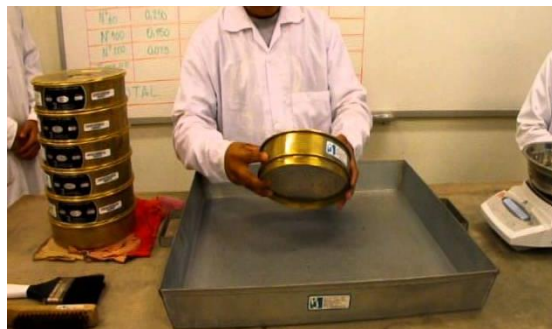
Figura N°4: Procedimiento del análisis granulométrico
