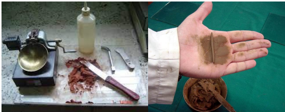
Figura N°5: Procedimiento de límites de consistencia
