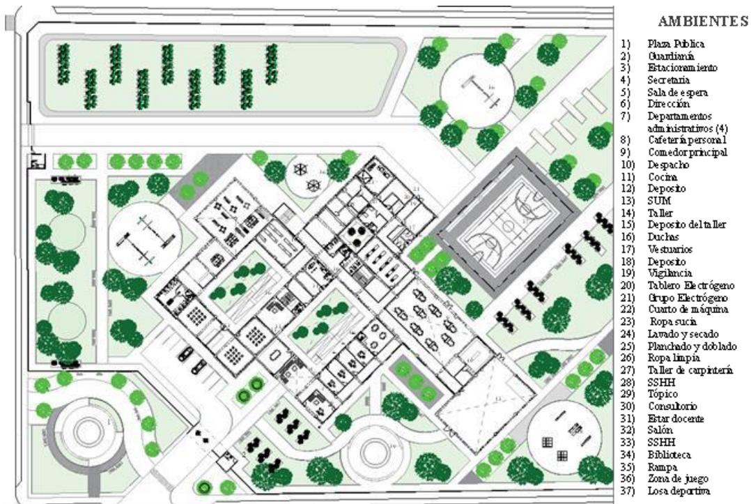
Figura 48. Planta de distribución de primer nivel del proyecto.
