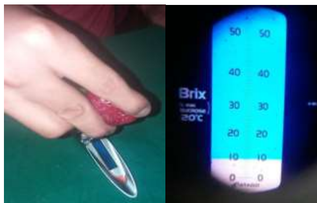
Figura 11. Medición de grados brix en el refractómetro de mano
