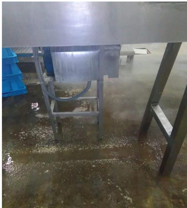
11. **Sellado de Envases.** Peligros: tablero cerca de la máquina, pisos resbalosos, peligro de partes en máquina de movimiento, ambiente de temperatura caliente, ruido, trabajo prolongado de pie
