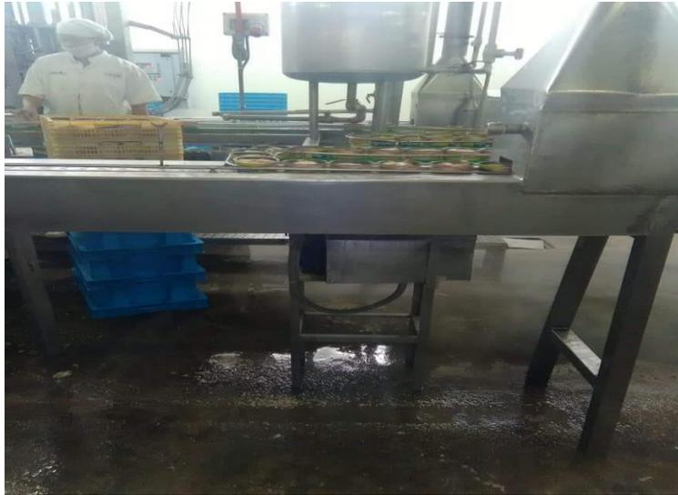
10. **Exhausting.** Peligros: tablero eléctrico sin protector, pisos resbalosos, ambiente de temperatura caliente, ruido, trabajo prolongado de pie, epp inadecuado (guantes)
