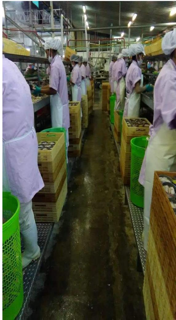
9. **Líquido de Gobierno.** Peligros: tubos de vapor sin protectores, pisos resbalosos, ambiente de temperatura caliente, ruido, trabajo prolongado de pie, epp inadecuado (guantes)
