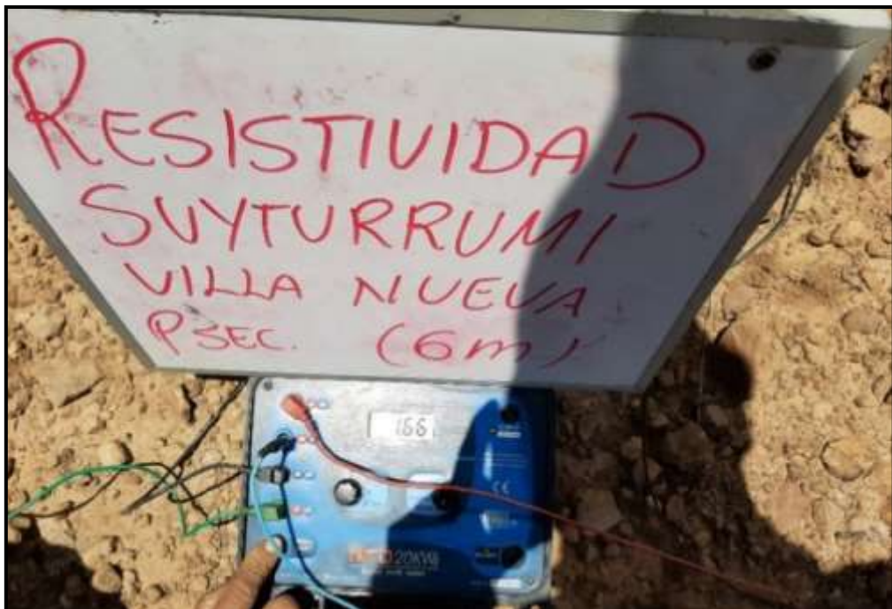
Figura 484. Resultado de prueba de resistividad en la línea Suyturrumi Bajo y Villa Nueva a 6 metros de distancia.
