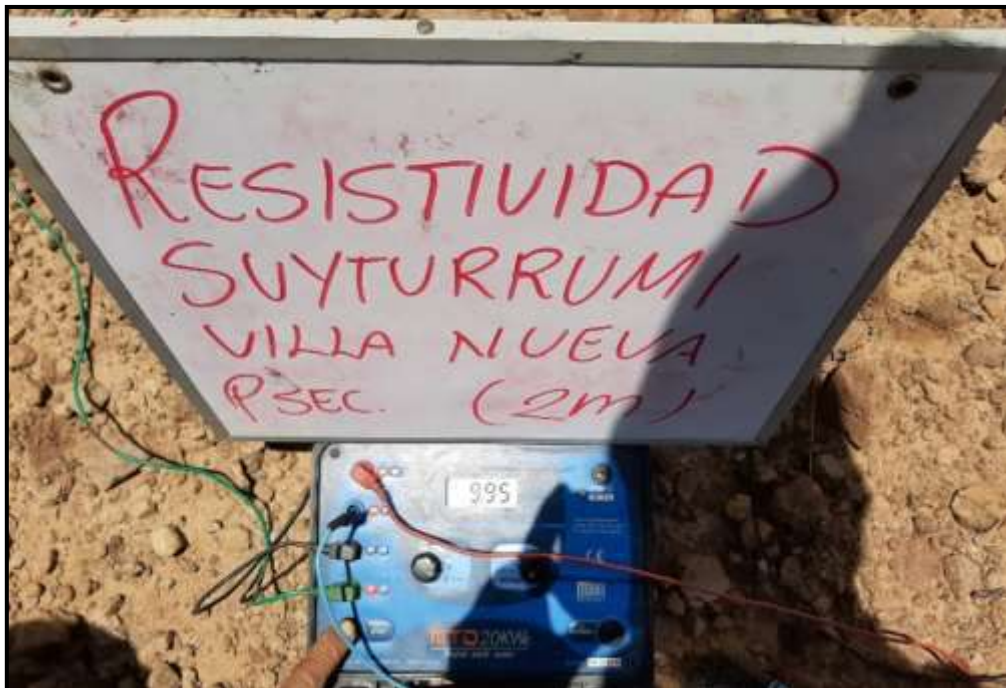
Figura 482. Resultado de prueba de resistividad en la línea Suyturrumi Bajo y Villa Nueva a 2 metros de distancia.
