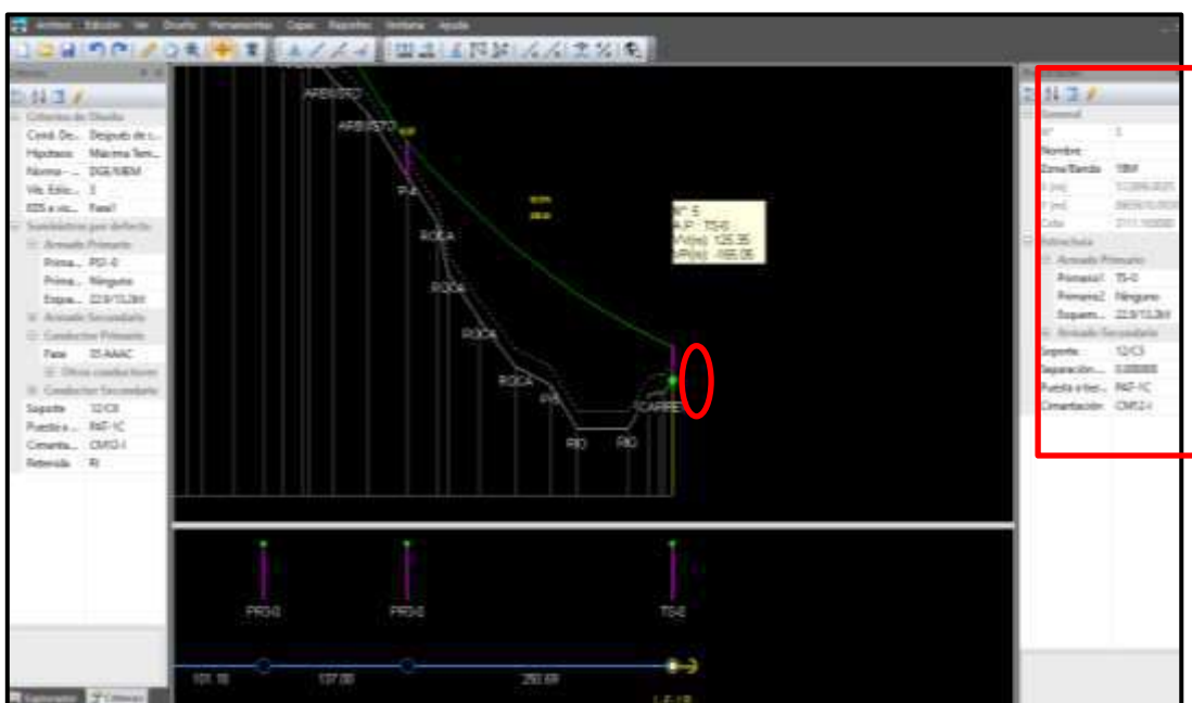
Figura 245. Distribución de un armado fin de línea Fuente: Elaboración propia, software Red Lin
