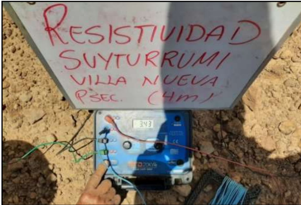
Figura 483. Resultado de prueba de resistividad en la línea Suyturrumi Bajo y Villa Nueva a 4 metros de distancia.
