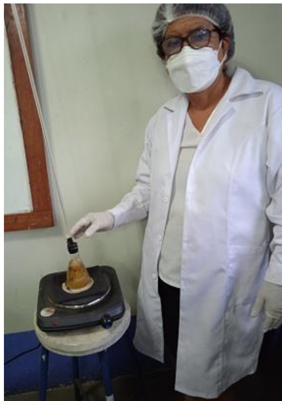
Reflujo para obtener el extracto etanólico de las flores de Taraxacum officinale L. “diente de león”
