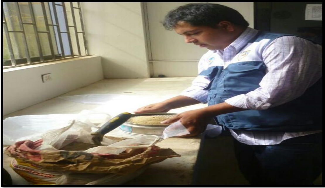
Foto n° 09 Tamisado a través de la malla n°200
