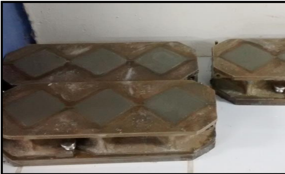
Foto n°17 llenado del mortero y apisonado manualmente.
