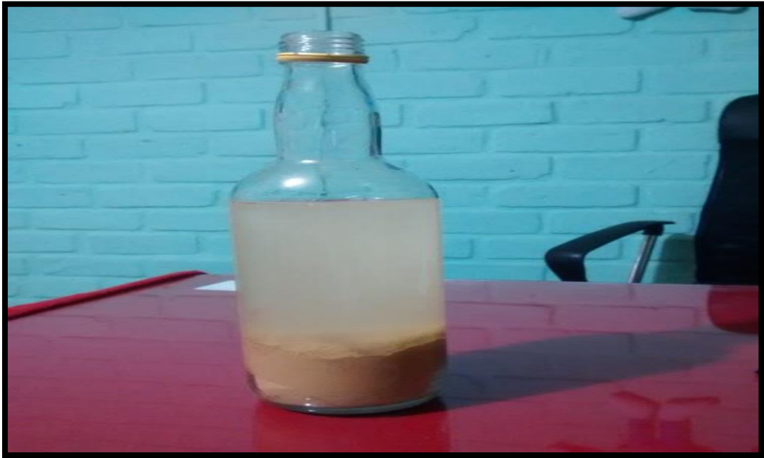
Foto n° 03 una vez removida la arcilla en la botella fue dejada reposar durante 24 horas
