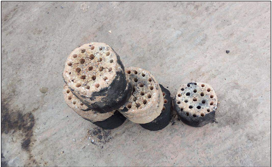
Figura 14 Obtención de muestras de ceniza de briqueta
