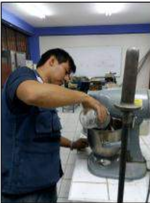
Figura 18 Preparación de la mezcla de mortero
