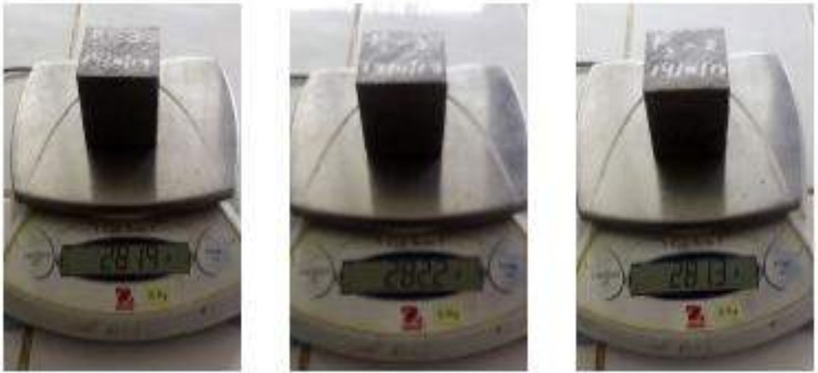
Figura 21 Unidades de mortero patrón
