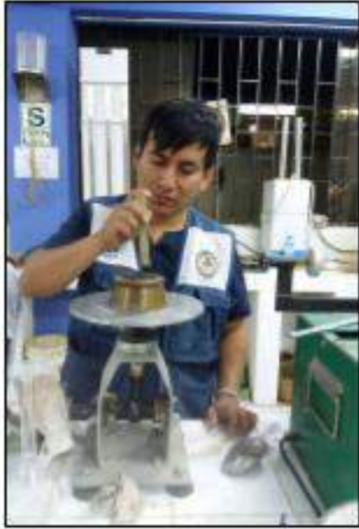
Figura 19 Ensayo de fluidez patrón
