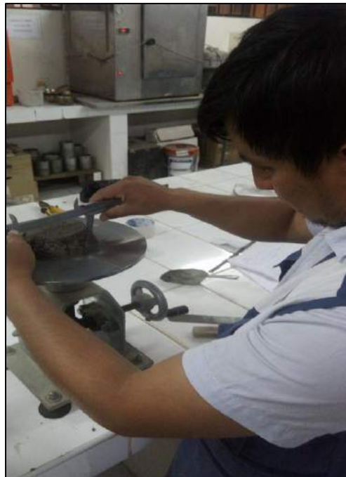
Figura 20 Ensayo de fluidez experimental
