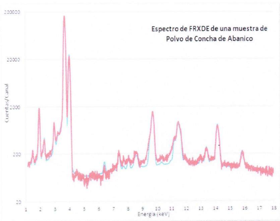
Figura 1. Espectro de FRXDE de una muestra de polvo de concha de abanico en escala semi logarítmica. Incluye el pico de Ar del aire y los picos de rayos-X de Au dispersados por la muestra. La curva en azul muestra el espectro simulado
