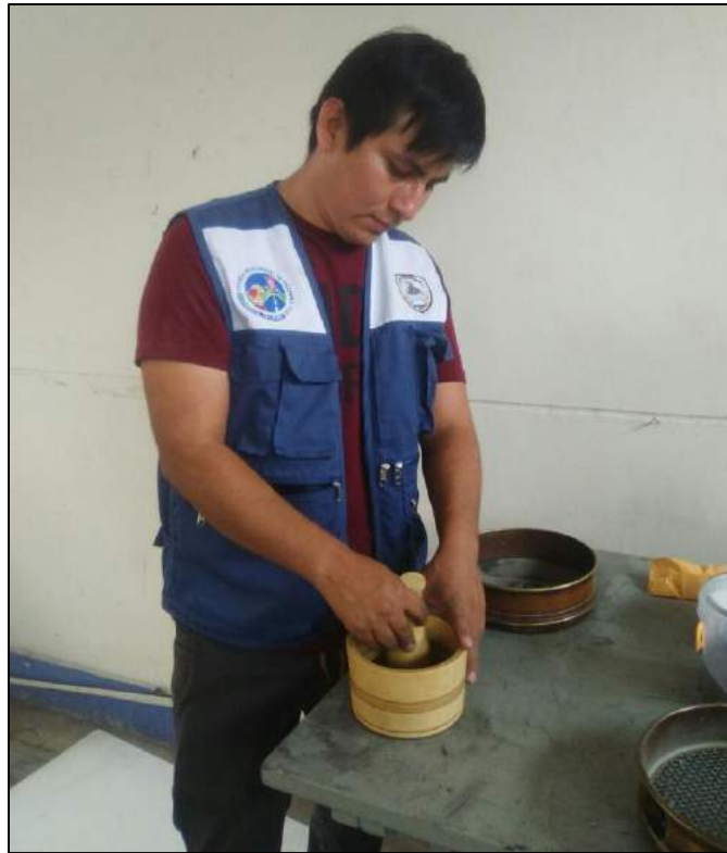
Figura 16 Activación mecánica de las muestras de Briqueta y concha de Abanico
