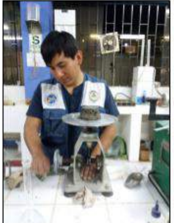
Figura 19 Ensayo de fluidez patrón
