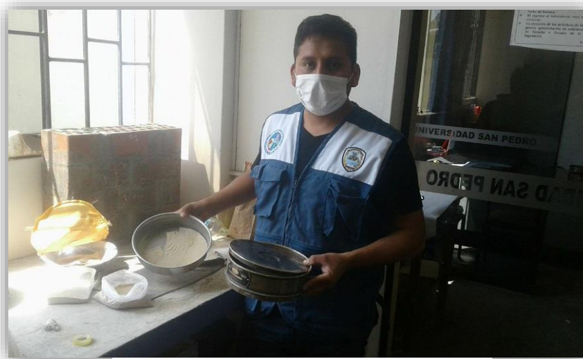
Figura 16. Proceso de la obtención del polvo pasando por la malla N° 200
