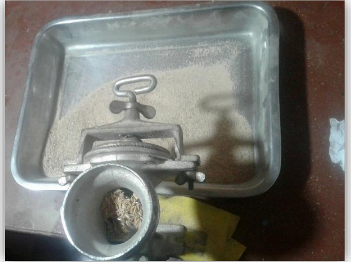
Figura 14. triturado de la cascara de arroz mediante una maquina manual
