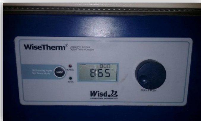
Figura 10. Material llevado a 800 °C por 4 horas en el horno
