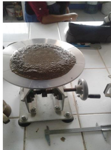
Figura 25. Procedimiento de 25 giros a la manija, en un tiempo de 15 segundos
