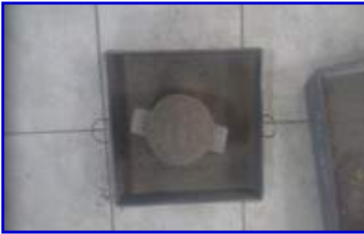
Foto 19. Se muestra el llenado del recipiente en la ultima capa con agregado fino.
