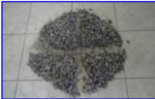
Foto 49. Se observa el cuarteo de una muestra de agregado grueso, con el fin de tomar una muestra representativa.
