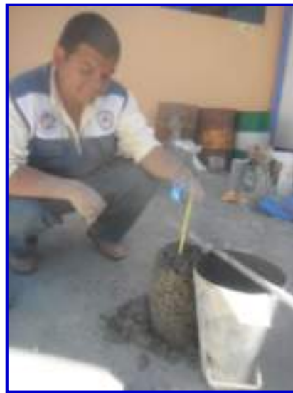
Foto 56. Se observa la finalización del ensayo de slump de la mezcla
