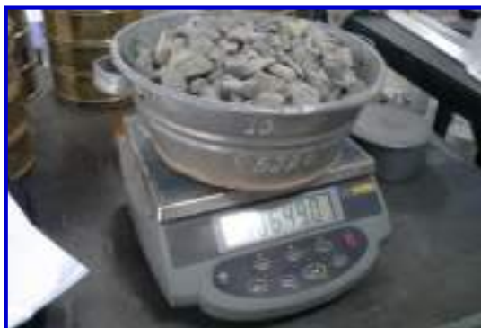
Foto 51. Después se pesó la muestra de piedra chancada tomada.
