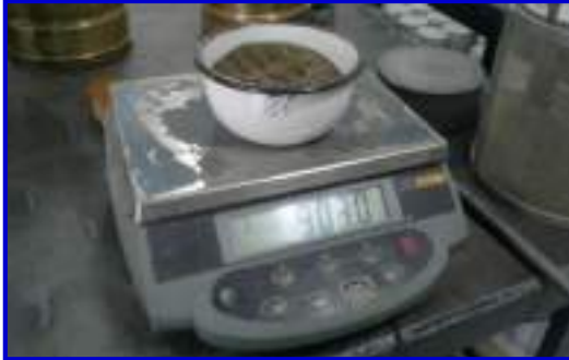
Foto 14. Se observa el peso de la muestra 01 inc. recipiente destinada para humedad.
