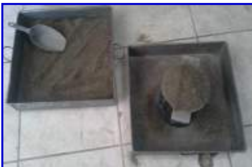
Foto 17. Se muestra el llenado del recipiente con el agregado fino.
