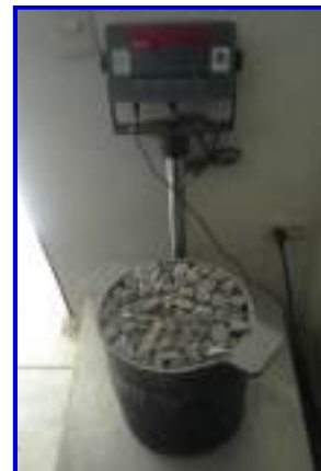
Foto 38. Luego se peso la muestra inc. el molde, de forma que se repitió el mismo proceso 3 veces.
