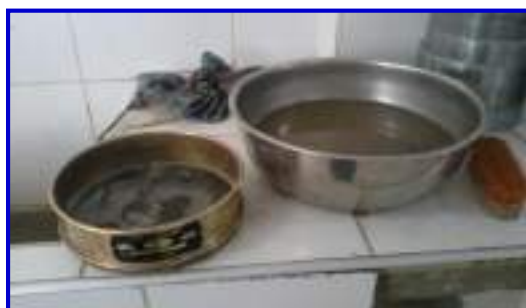
Foto 28. Posteriormente se hizo el lavado de la misma por la malla N°200.
