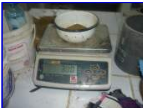
Foto 22. Se observa el peso de 300 gr. de una de las muestras de arena.
