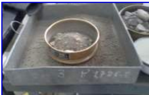
Foto 26. Se observa el tamizado previo del material por la malla N°4
