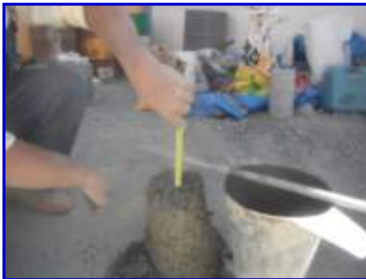
Foto 55. El asentamiento medido resultó 3.00", resultando dentro del rango esperado.
