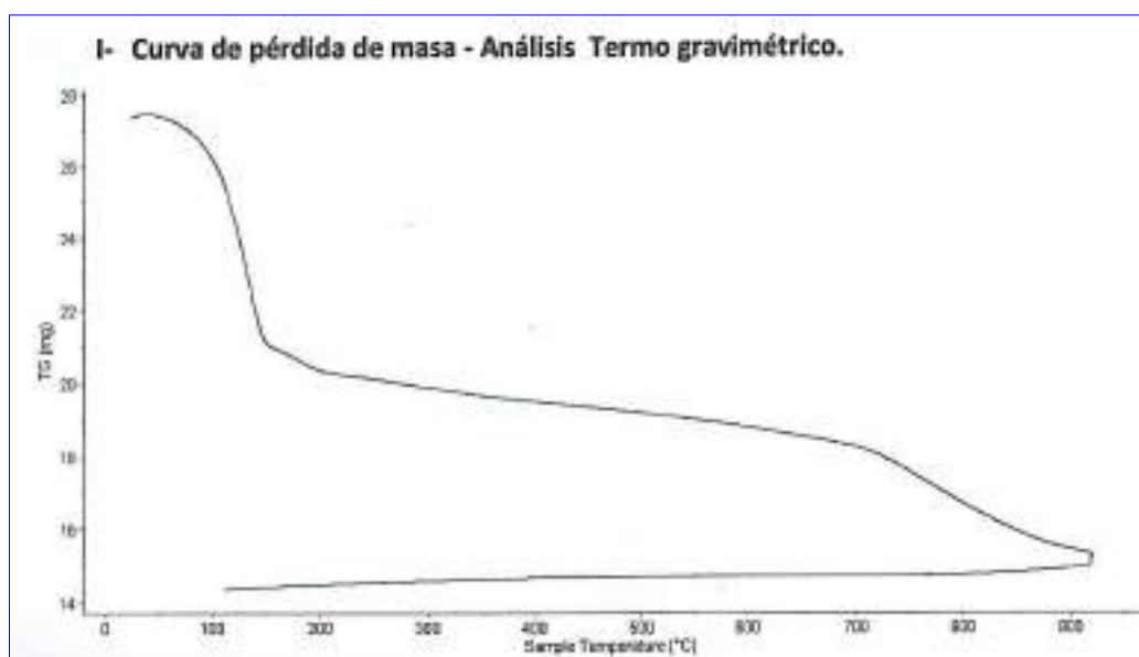
Figura 2: Resultados obtenidos del ensayo de análisis termogravimétrico TGA de las cenizas de cáscara de coco en estado prequemado.
