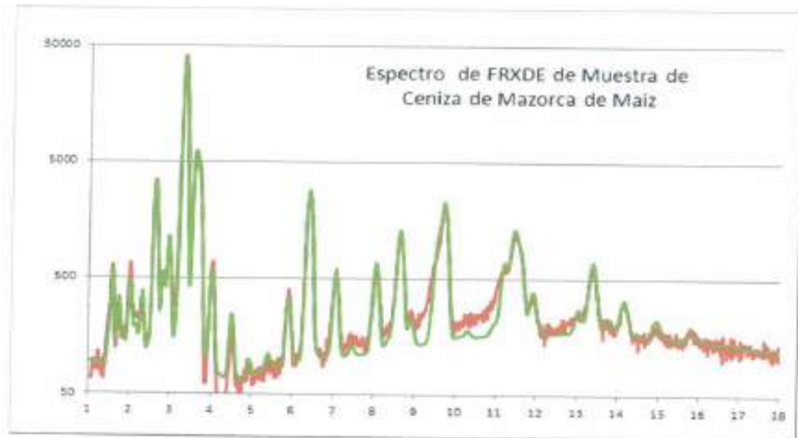
Figura 2. Espectro de FRXDE de una muestra de ceniza de mazorca de maíz. Incluye el pico de Ar del aire y los picos de rayos-X de Au dispersados por la muestra. La curva en verde muestra el espectro simulado
