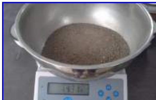
Foto 27. Se observa el peso de la muestra después de pasar la malla N°4.
