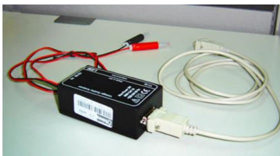
Figura 7. Equipo testigo registrador de tensión. Fuente: http://www.osinergmin.gob.pe/empresas/electricidad/calidad/NTCSE/suministro (15/07/2016)
