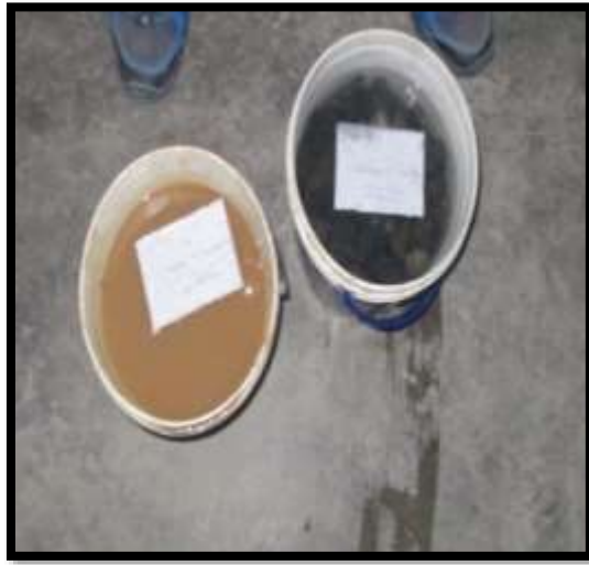
Figura 18: Muestras de agregados en agua para ensayo de gravedad específica y absorción
