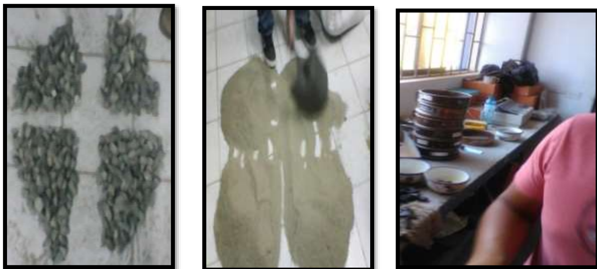
Figura 16: Ensayo granulométrico de los agregados.
