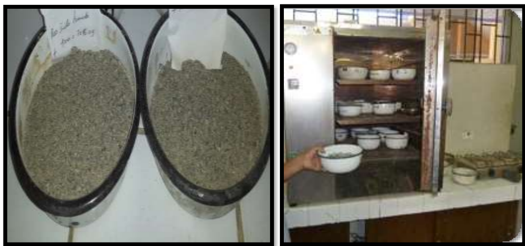
Figura 17: Muestras del agregado para el Ensayo de contenido de humedad.
