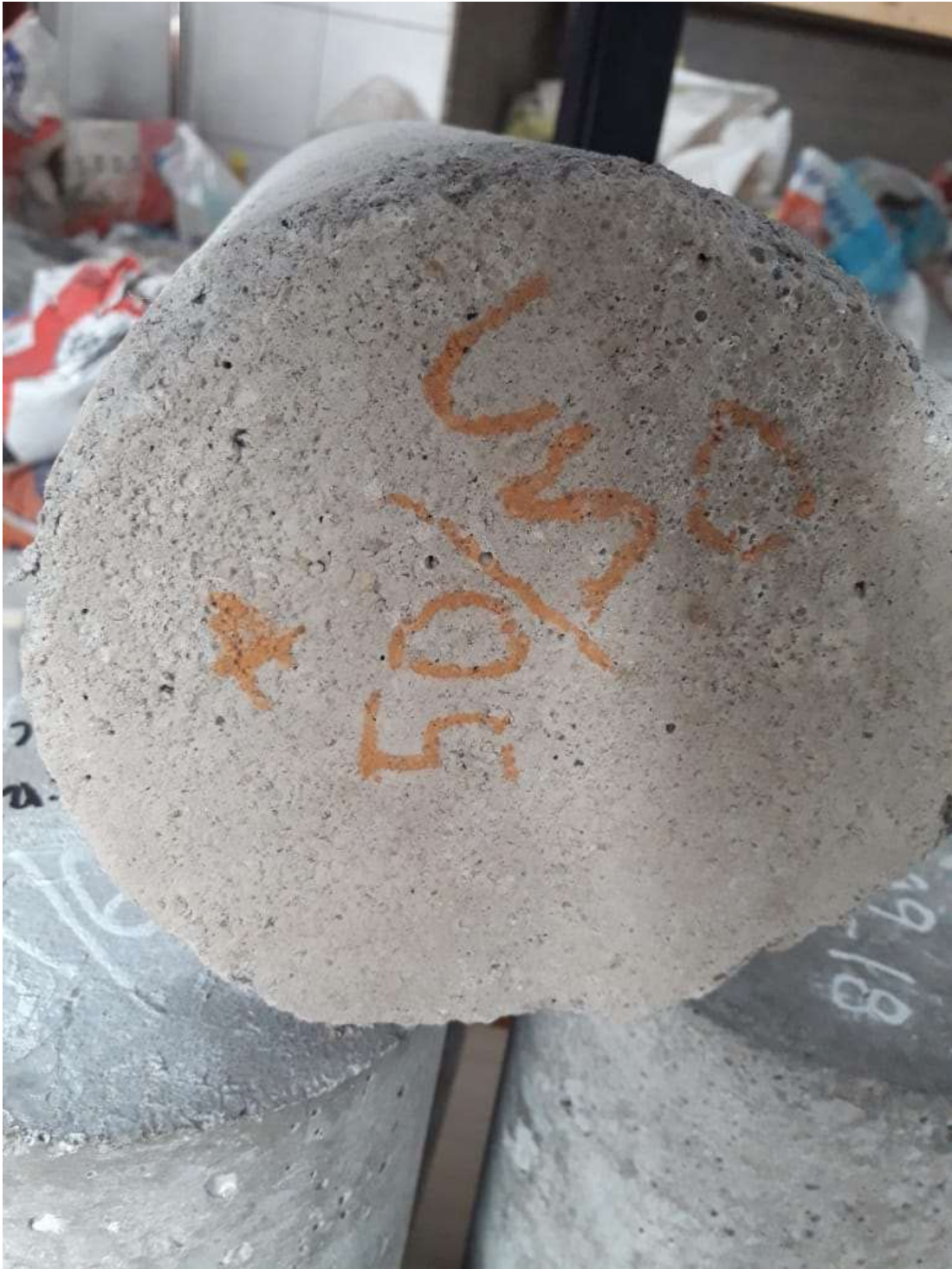
Figura 26: Probeta Experimental ensayada a la edad de 7 días
