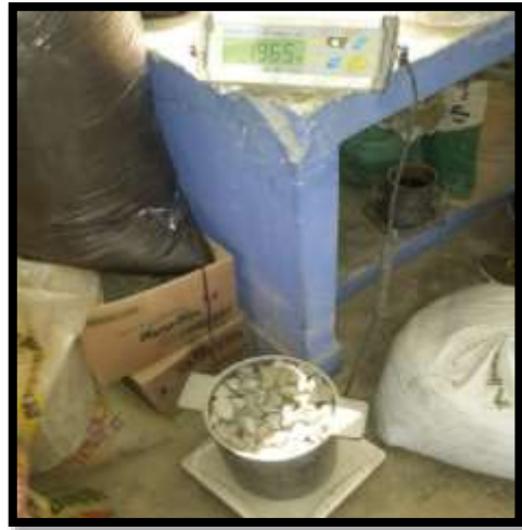
Figura 14: Ensayo de Peso Unitario del Agregado Grueso.
