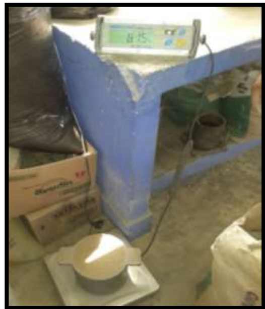
Figura 15: Ensayo de Peso Unitario del Agregado Fino.
