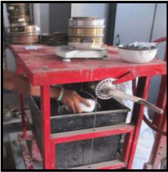
Figura 19: Pesado de muestra seca en agua para ensayo de gravedad específica
