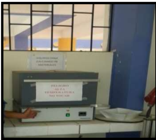
Figura 12: activación mecánica y térmicamente de la arcilla
