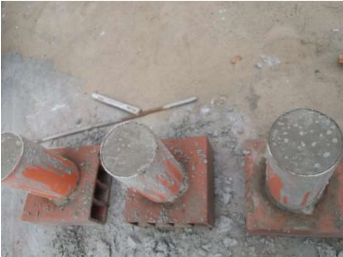
Figura 33: Resistencia del concreto sistematizado con sustitución del 30% de Arcilla/Cemento de Cuzca de la Provincia de Corongo - Ancash
