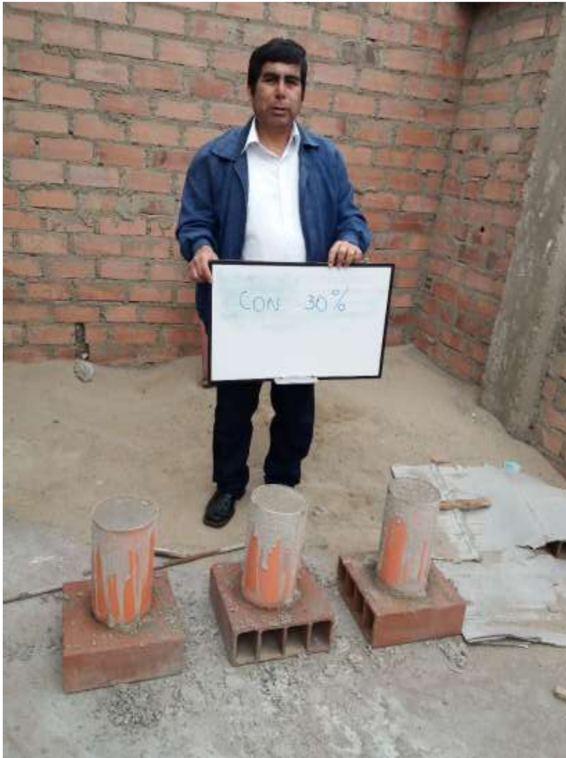
Figura 32: Resistencia del concreto sistematizado con sustitución del 30% de Arcilla/Cemento de Cuzca de la Provincia de Corongo - Ancash
