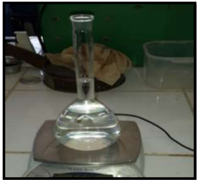
Figura 20: Pesado de picnómetro con agua para
