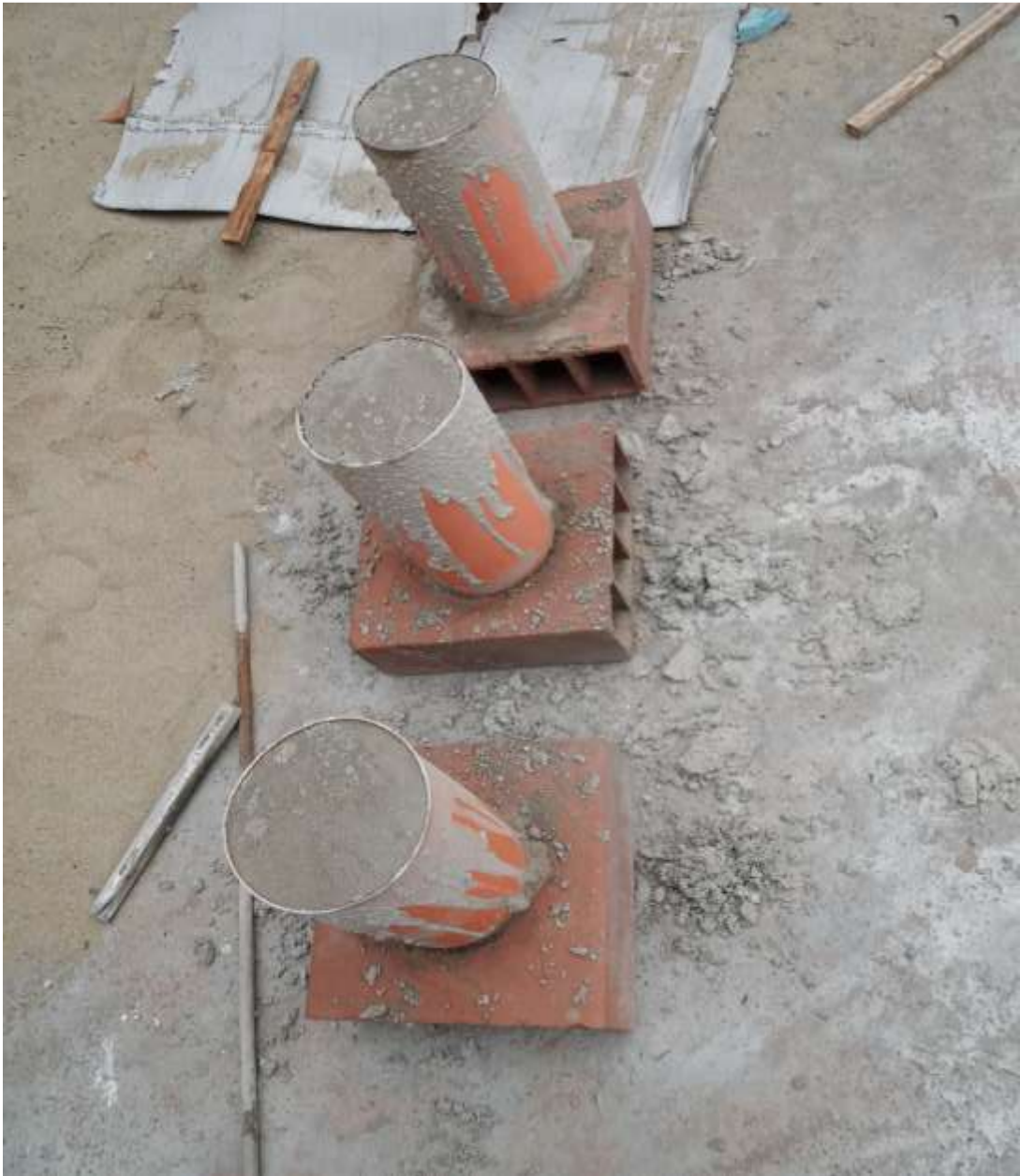
Figura 29: Resistencia del concreto sistematizado con sustitución del 50% de Arcilla/Cemento de Cuzca de la Provincia de Corongo - Ancash
