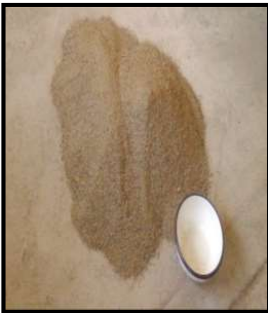
Figura 15: Ensayo de Peso Unitario del Agregado Fino.
