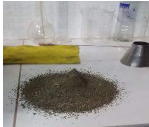
Figura N°24: Material desmoronado Fuente: Elaboración Propia
