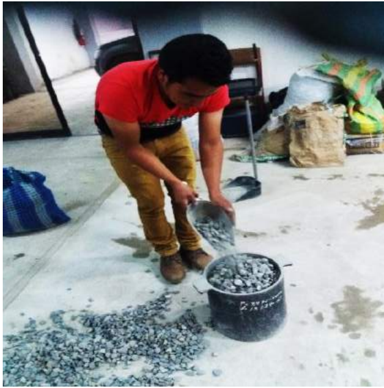
Figura N°17: Llenado del Confitillo Fuente: Elaboración Propia.
