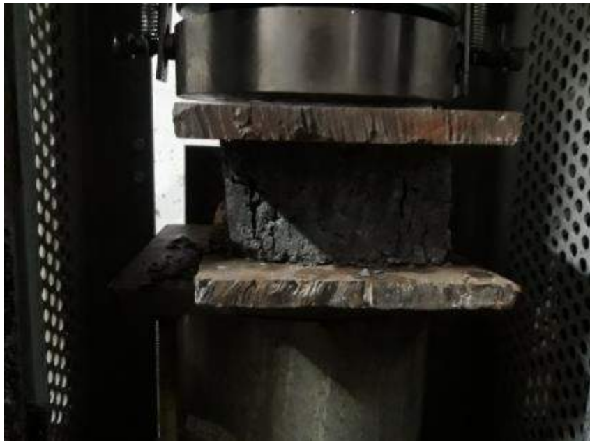
Figura N°49: Se observa el ensayo a compresión de los adoquines de concreto
