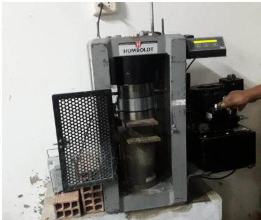
Figura N°50: Se observa la rotura del adoquín en la maquina mecánica para compresión
