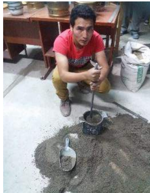
Figura N°20: Varillado del A. Fino Fuente: Elaboración Propia
