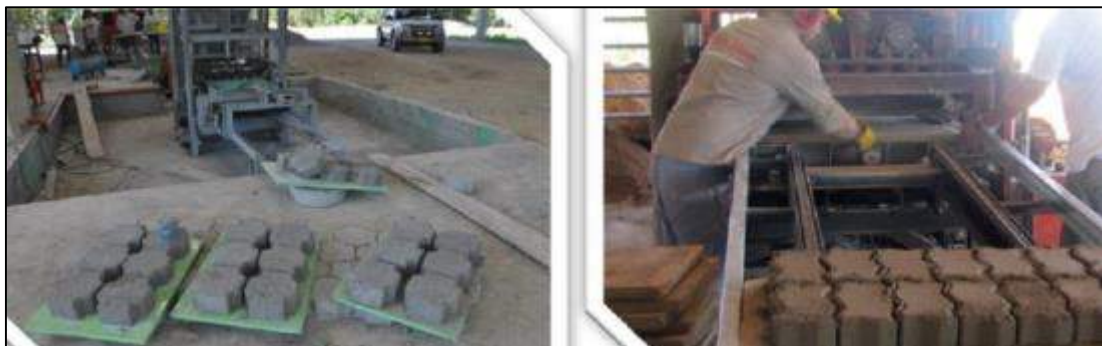
Figura N° 3: Fabricación mecanizada de grandes lotes de adoquines
