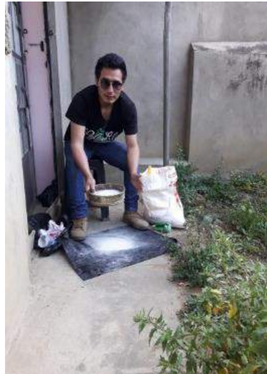
Figura N°40: Tamizado del vidrio Fuente: Elaboración propia
