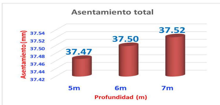
Gráfica 39: Asentamiento Total de un pilote aislado
