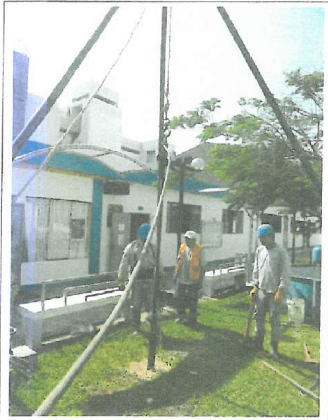
Foto N°01: Vista de ubicación del SPT-01, presencia de arena limosa (SM), arena mal graduada con limo (SP-SM) arena mal graduada (SP), suelto a compacto, húmedo a saturado, de color beige oscuro a gris. Nivel freático a 1.10m de profundidad.
