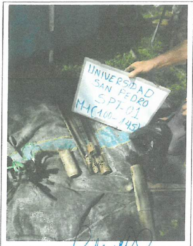
Foto N°02: Vista del SPT-01, muestra de 1.00 a 1.45 m, presencia de arena limosa (SM), suelto, húmedo a saturado de color gris oscuro.
