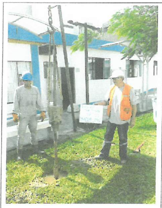
Foto N°05: Vista del SPT-01, prueba de resistencia la penetración de 3.00 a 3.45m.
