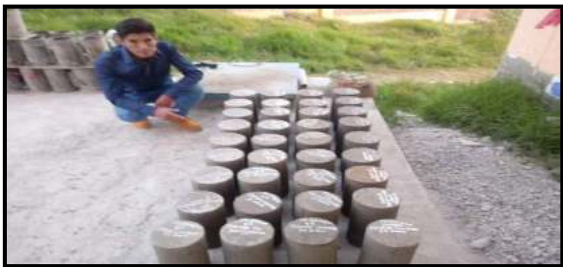
Foto 33: desencofrado de los testigos para luego ser curado.
