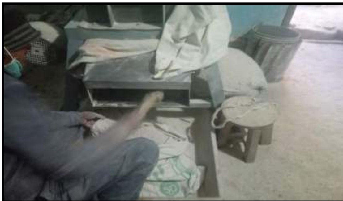
Foto 18: antes de llenar la cascara de huevo se procede a limpiar el molino.
