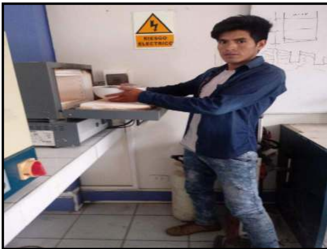
Foto 24: colocando la muestra en el horno de mufla para su calcinación.
