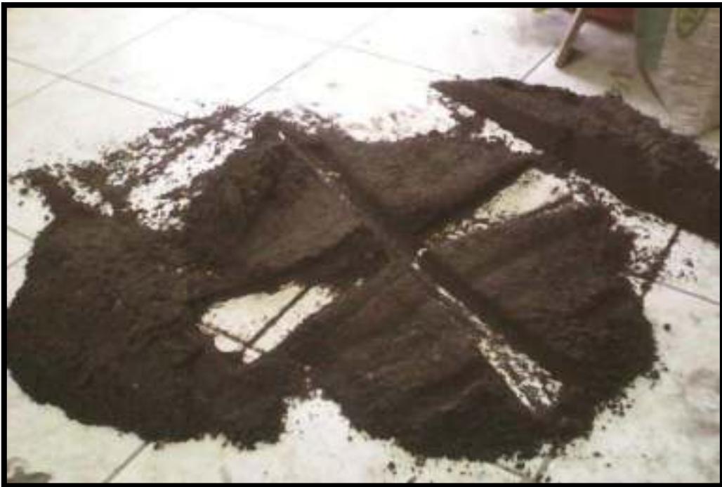
Foto 06: Cuarteando el agregado grueso para la granulometría.
