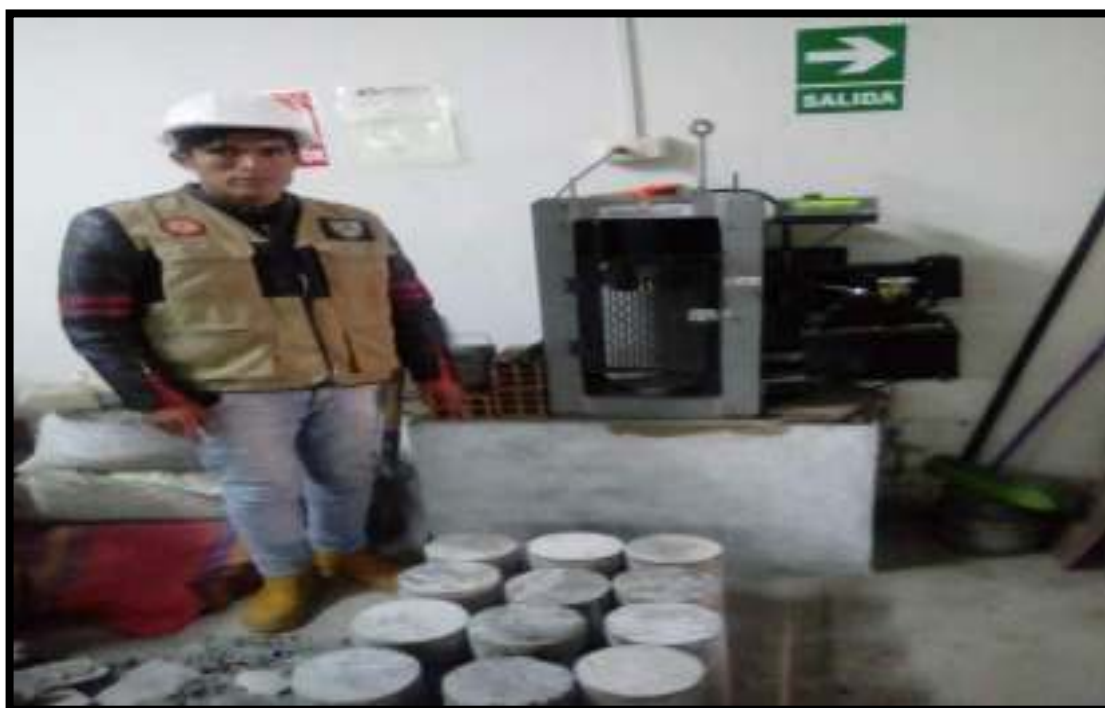
Foto 36: La probeta en la máquina para el ensayo a compresión.
