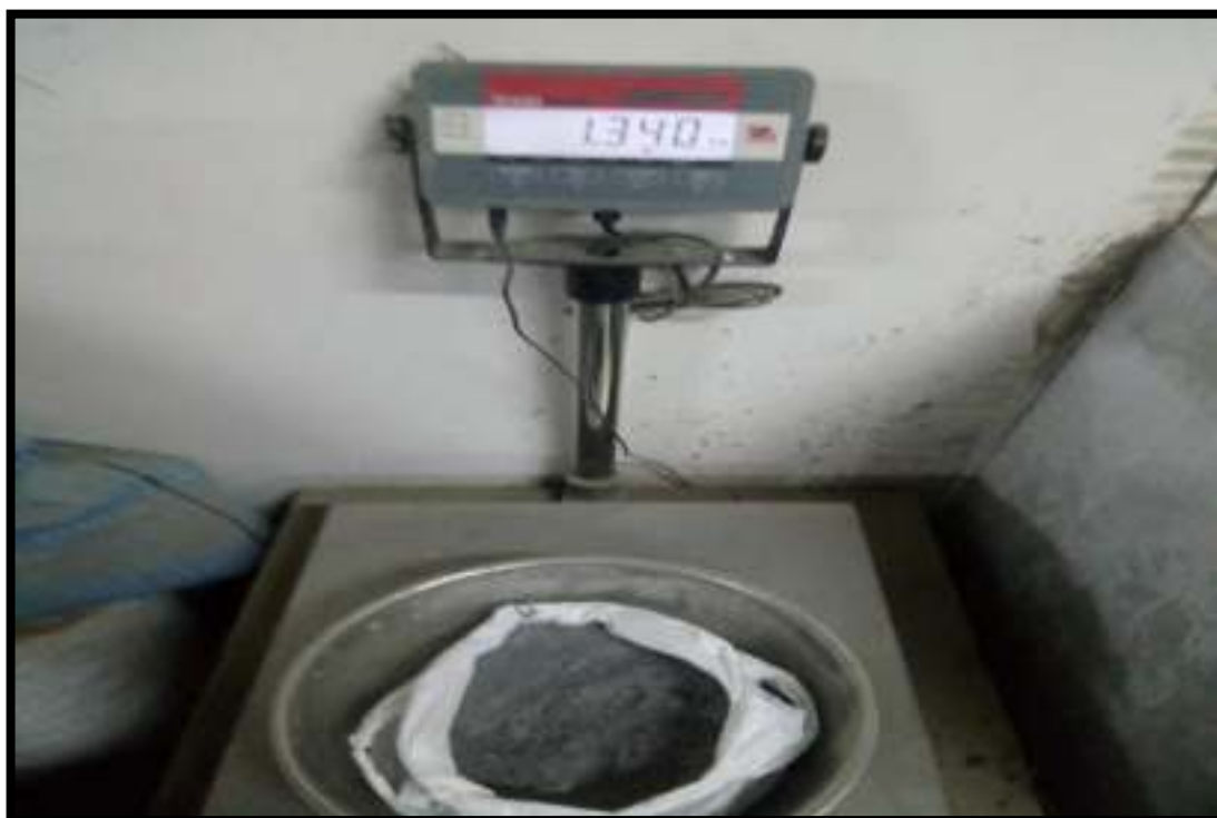
Foto 28: pesando la ceniza de cascara de huevo de acuerdo al diseño de mezcla
