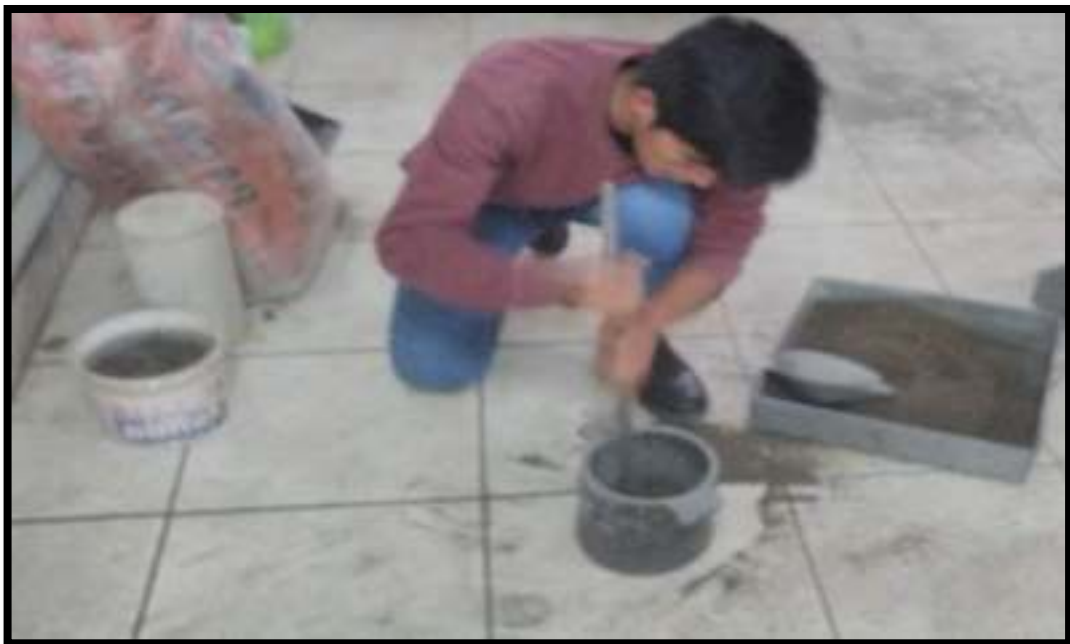
Foto 08: Densidad compactada de la arena.
