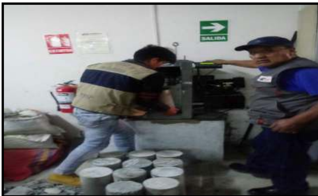
Foto 36: La probeta en la máquina para el ensayo a compresión.
