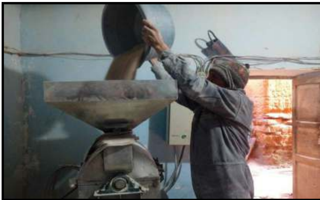
Foto 19: llenamos al molino para ser triturado.
