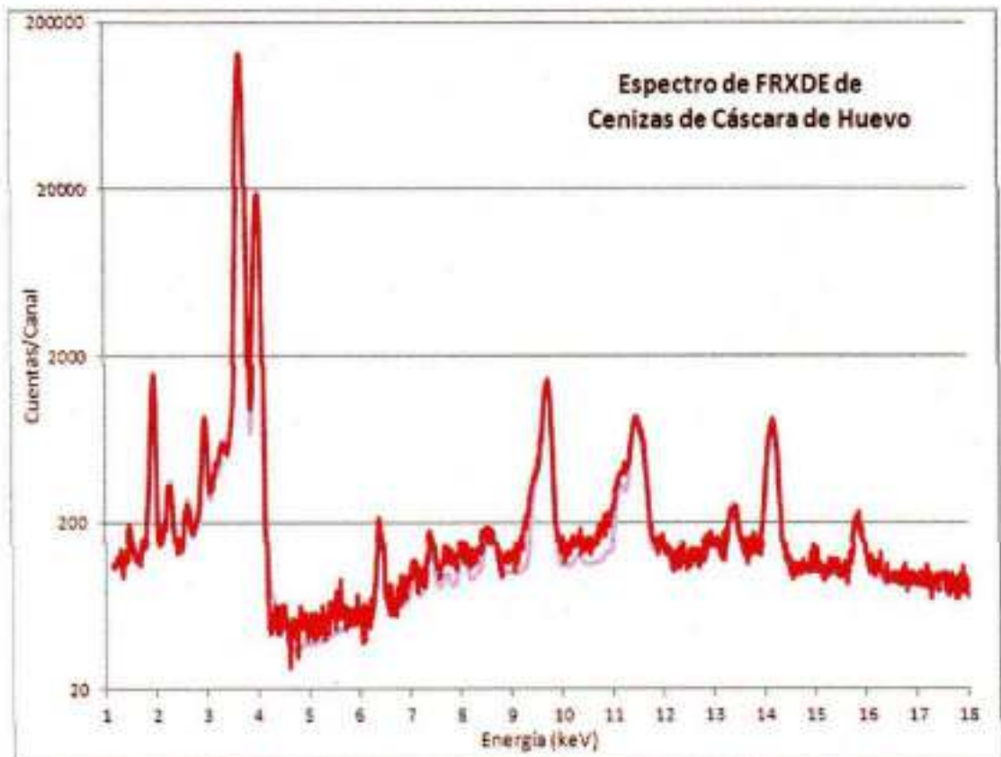
Figura 1. Espectro de FRXDE de cenizas de cáscara de huevo molido en escala semi-logarítmica. Incluye el pico de Ar del aire y los picos de rayos-X de Au dispersados por la muestra. La curva en azul muestra el espectro simulado
