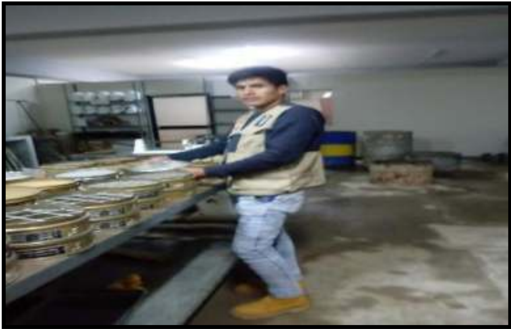
Foto 07: Tamizando el agregado grueso para la granulometría.
