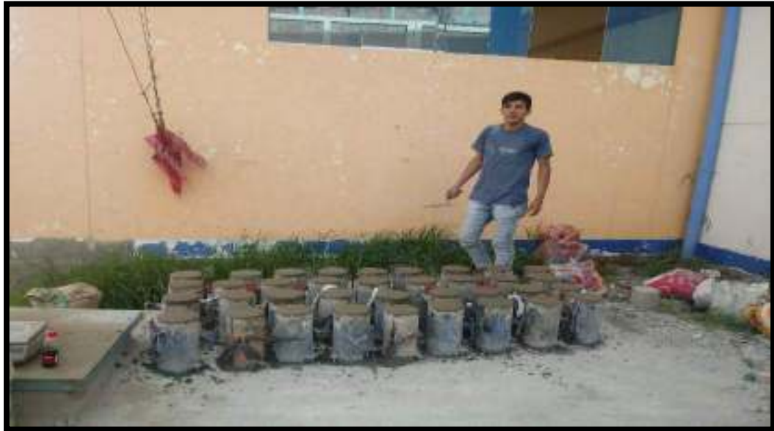
Foto 32: probetas culminadas tanto patrón y los porcentajes de la ceniza de cascara de huevo.
