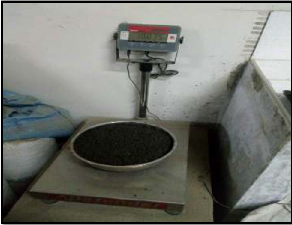
Foto 26: pesando los agregados para la dosificación
