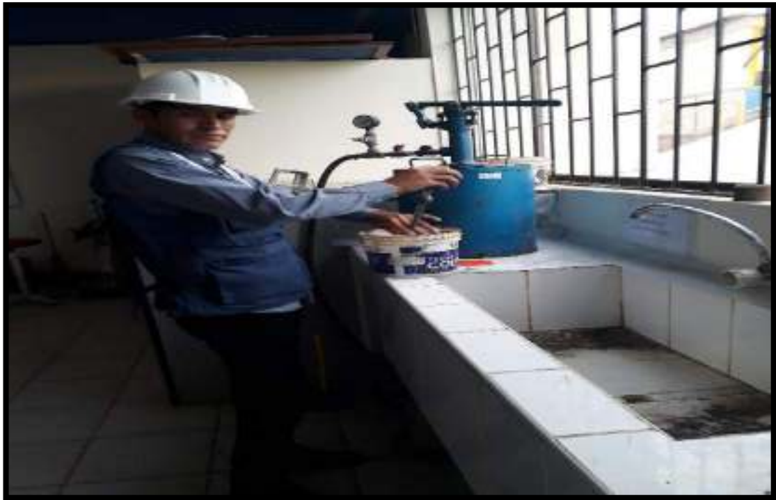
Foto 25: Ensayo de peso específico de la ceniza de cascara de huevo
