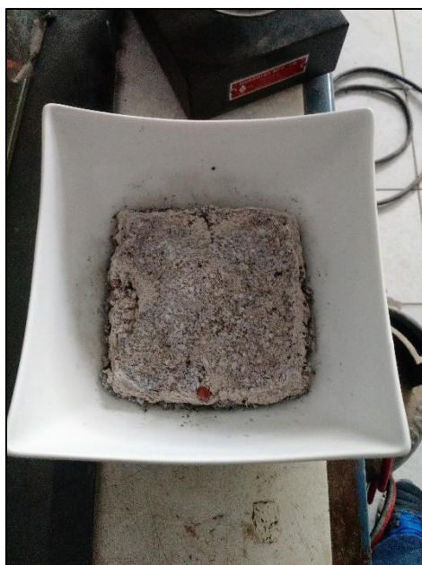
FIGURA N°9: Material saliendo de la de la calcinación a 750°C
