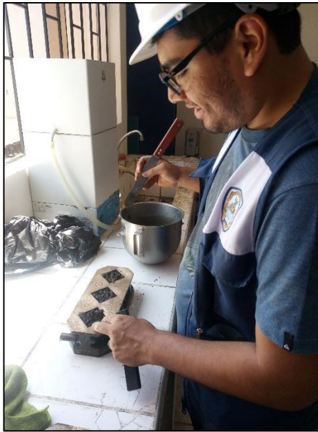
FIGURA N°17: Vaciado de mezcla hacia molde (3 cubos).
