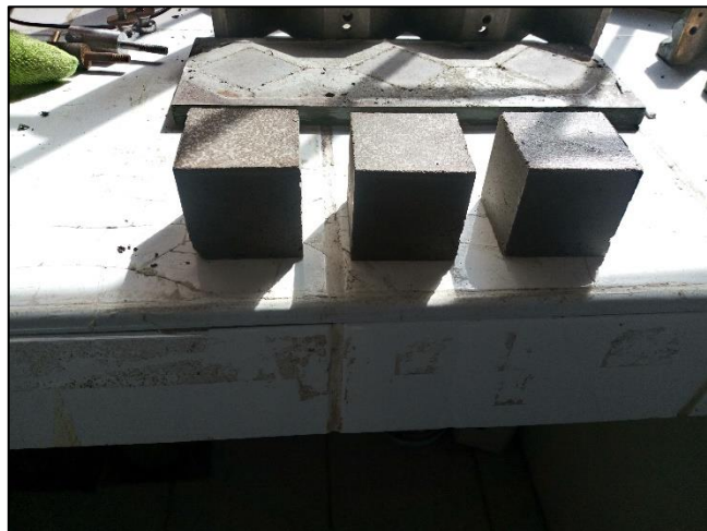
FIGURA N°18: Desencofrado de morteros experimentales (3 cubos).
