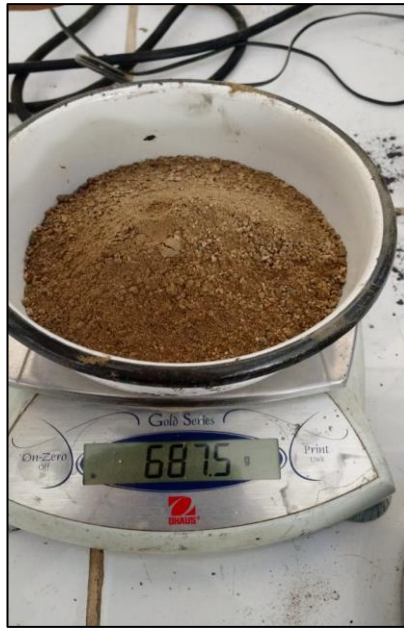
FIGURA N°14: Peso de la Arena manufacturada para la elaboración de una tanda de morteros (3 cubos).
