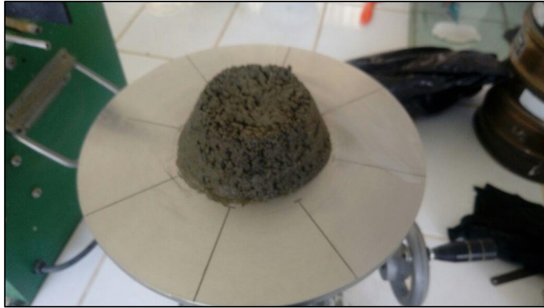
FIGURA N°19: Elaboración de Ensayo de Fluidez.
