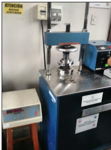
FIGURA N°21: Laboratorio N°1 de ensayo de materiales – UNI. Para el ensayo de Resistencia a Compresión de los morteros patrones y experimentales.
