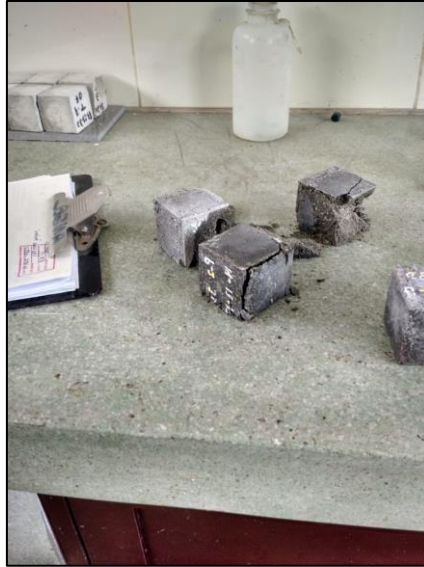
FIGURA N°22: Laboratorio N°1 de ensayo de materiales – UNI. Morteros patrones después del ensayo.
