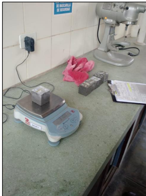
FIGURA N°22: Laboratorio N°1 de ensayo de materiales – UNI. Morteros patrones después del ensayo.
