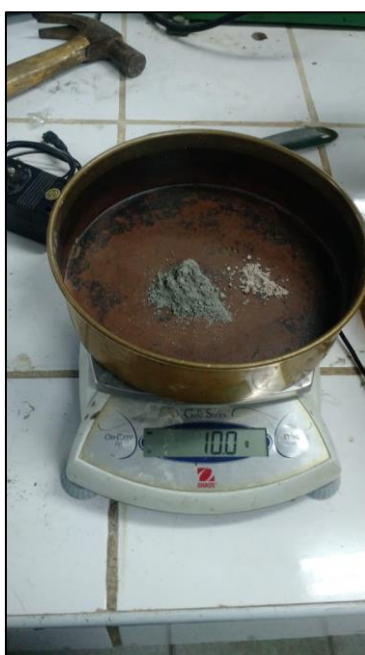
FIGURA N°11: Haciendo la combinación cemento con paja de cebada para el análisis de Ph
