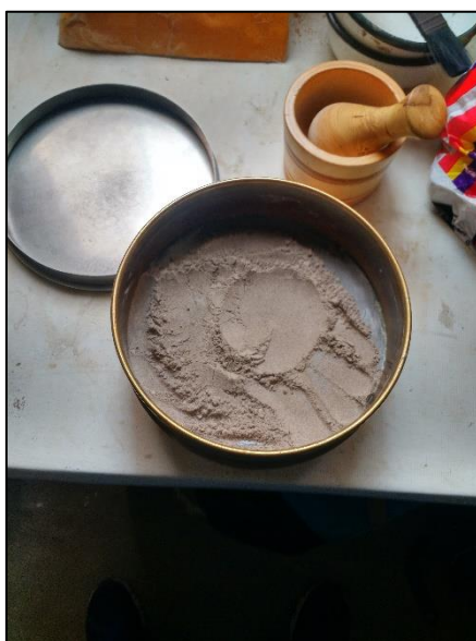
FIGURA N°10: Tamizando por malla N°200 el material para llevar a ensayar
