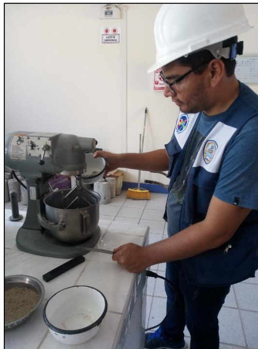
FIGURA N°16: Elaboración de mezclado de morteros (3 cubos).
