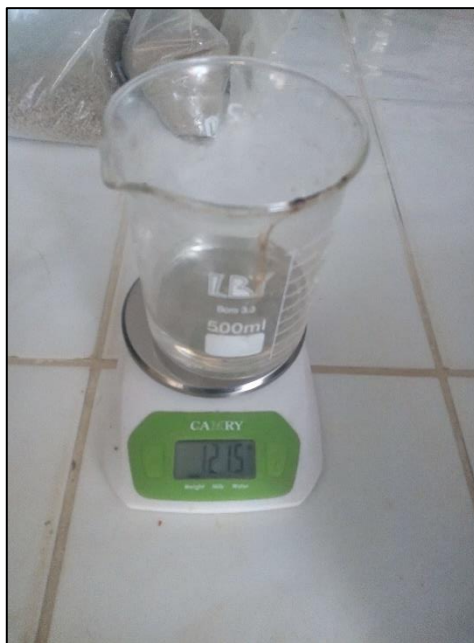
FIGURA N°15: Peso de la Agua para la elaboración de morteros (3 cubos).
