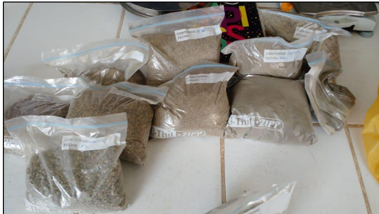
FIGURA N°13: Arena Manufacturada separada por malla para la elaboración de morteros
