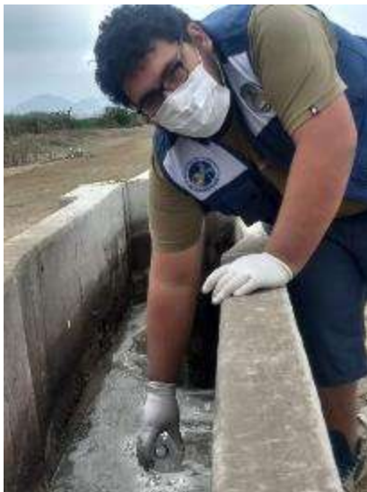
Figura 28: Extracción de agua residual. Fuente: Elaboración propia.
