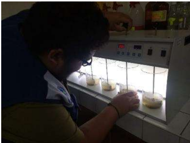
Figura 32: Método de las jarras Fuente: Elaboración propia.
