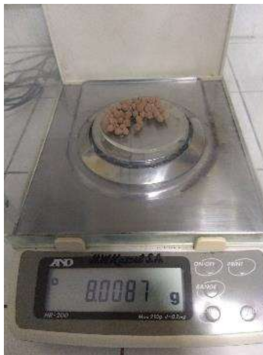
Figura 30: Pesado de esferas biofiltrantes. Fuente: Elaboración propia.
