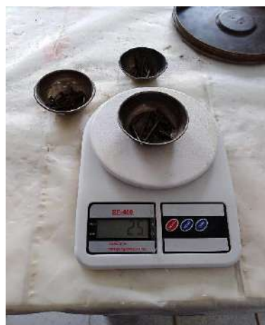
Imagen 19: Ensayo de Límites de Atterberg – Límite plástico.
