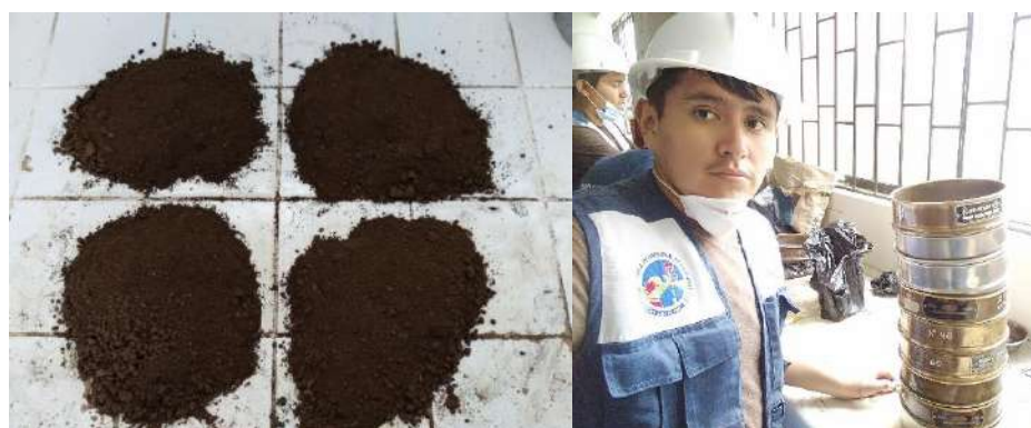
Imagen 16: Análisis granulométrico por tamizado (ASTM D422)
