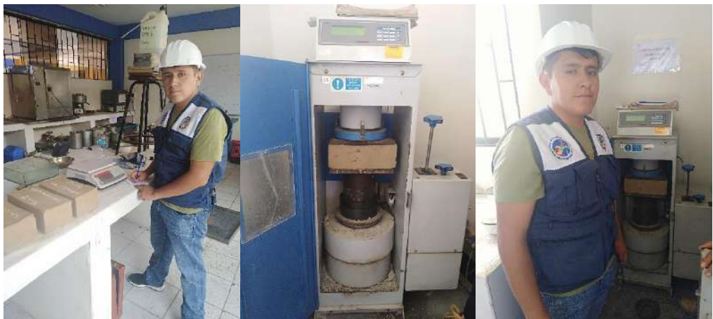
Imagen 23: Ensayo de resistencia a la compresión - Edad 10 días
