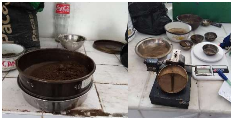
Imagen 18: Ensayo de Limites de Atterberg – Limite Liquido.
