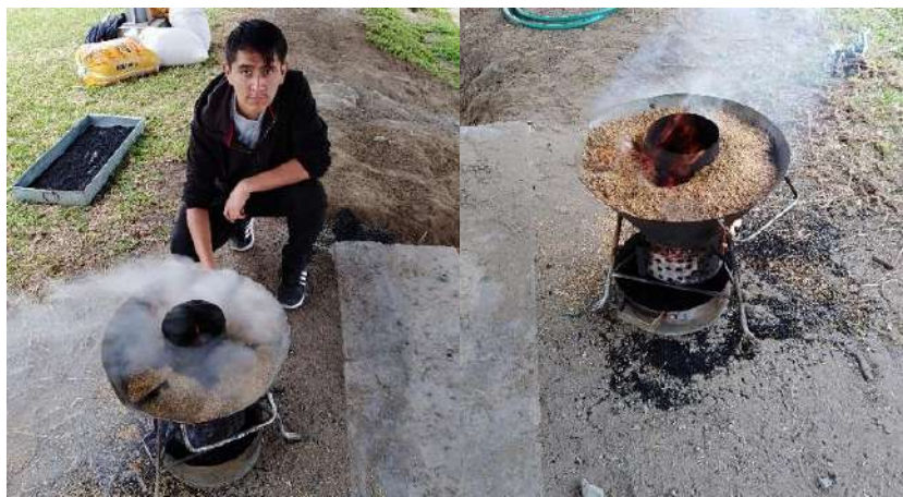
Imagen 14: Calcinación de la cascara de arroz en el horno piloto
