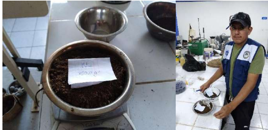
Imagen 17: Ensayo de contenido de humedad (ASTM D2216-71)
