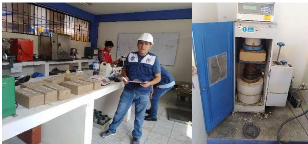
Imagen 24: Ensayo de resistencia a la compresión - Edad 20 días
