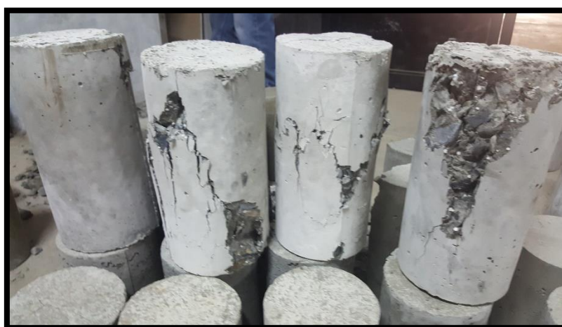
Fotografía N° 20: Ensayo de resistencia a la compresión para probetas de 14 días de edad.
