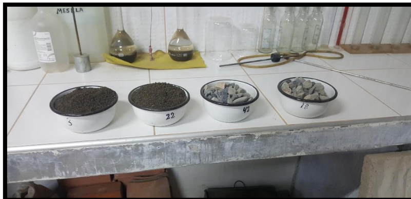
Fotografía N° 03: Muestras para determinación del contenido de humedad de los agregados.
