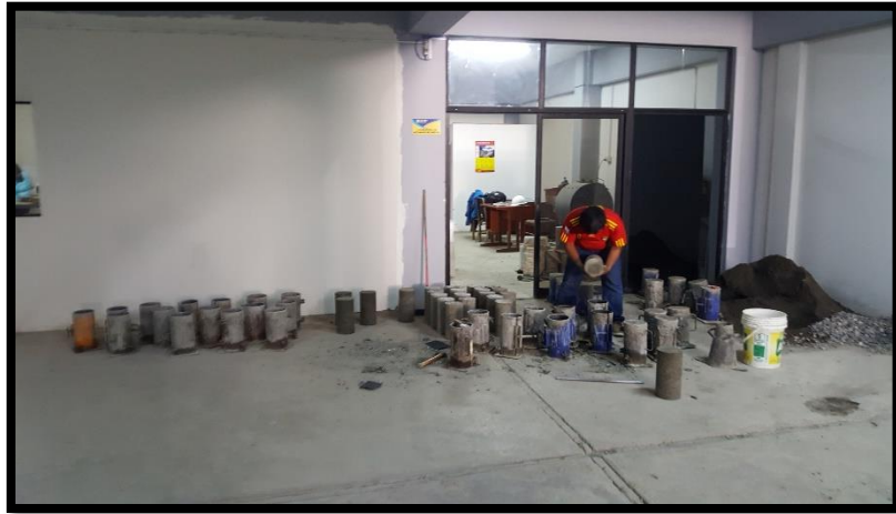
Fotografía N° 13: Desencofrado de probetas para curación del concreto.
