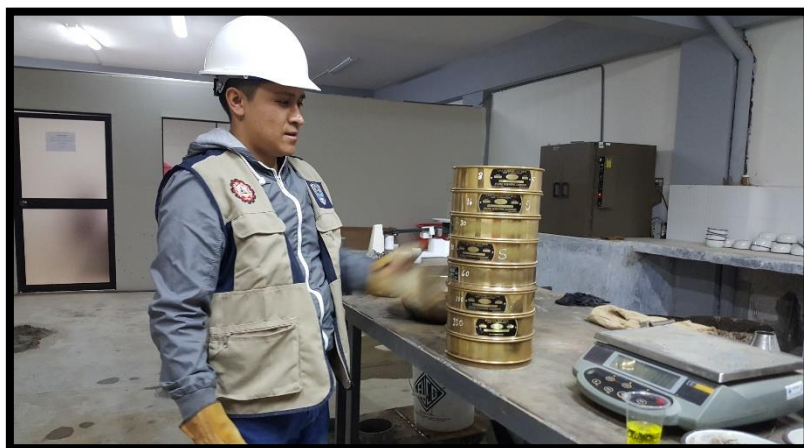
Fotografía N° 09: Análisis granulométrico de los agregados.
