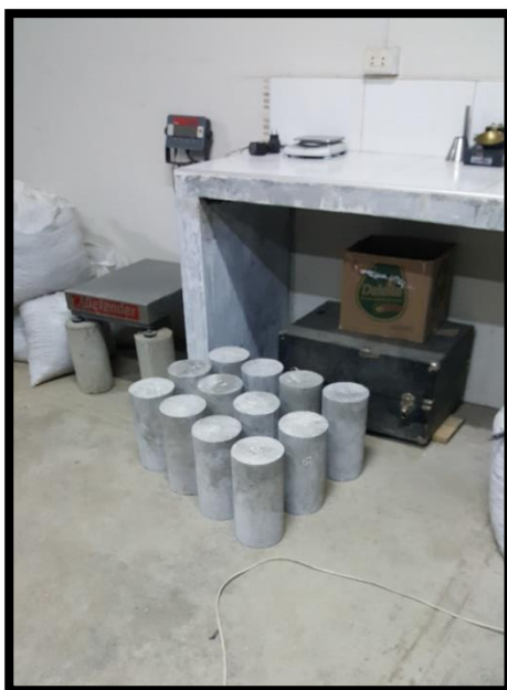
Fotografía N° 15: Secado al aire de probetas de concreto para ensayo de resistencia a los 07 días.
