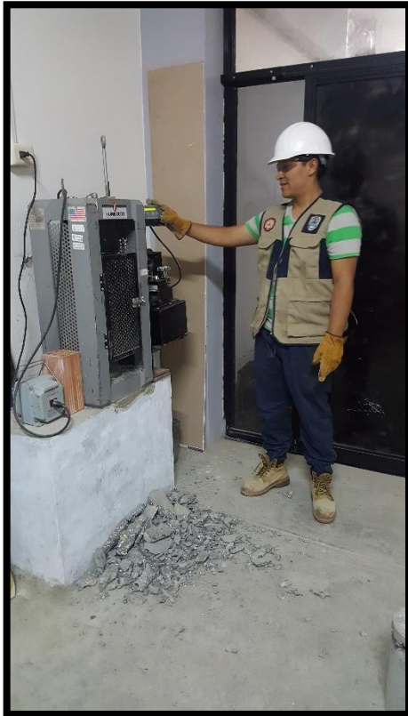
Fotografías N° 23 y 24: Ensayo de resistencia a la compresión para probetas de 28 días de edad.
