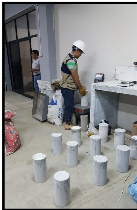
Fotografía N° 22: Pesado de probetas de concreto para determinación de “peso volumétrico” o densidad del concreto a los 28 días.
