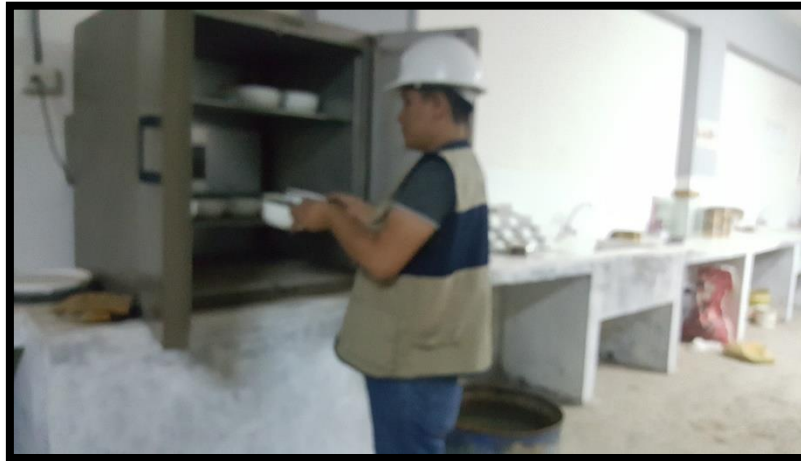
Fotografía N° 04: Llevando las muestras al horno para la determinación del contenido de humedad de los agregados.
