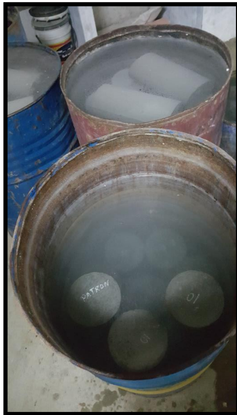
Fotografía N° 14: Curación de probetas de concreto.
