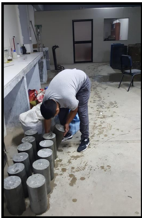
Fotografía N° 19: Secado al aire de probetas de concreto para ensayo de resistencia a los 14 días.
