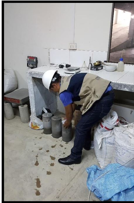
Fotografía N° 21: Secado al aire de probetas de concreto para ensayo de resistencia a los 28 días.
