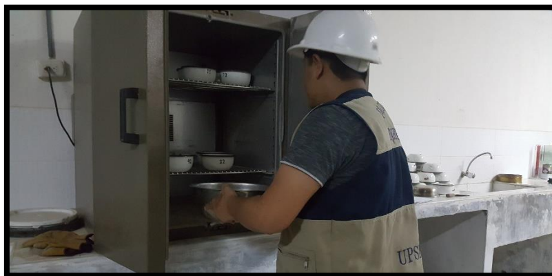
Fotografía N° 05: Preparación del agregado grueso para la determinación de la absorción y peso específico.
