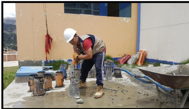
Fotografía N° 11: Procedimiento para determinación del SLUMP.
