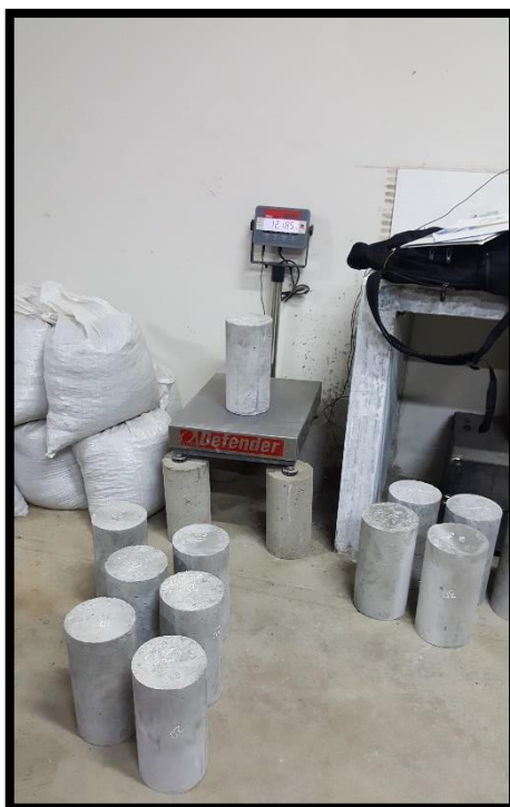
Fotografía N° 16: Pesado de probetas de concreto para determinación de “peso volumétrico” o densidad del concreto.
