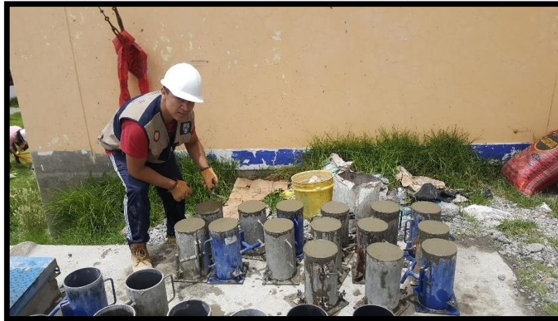
Fotografía N° 10: Procedimiento para preparación de probetas de concreto f'c=280\text{kg/cm}^2 .
