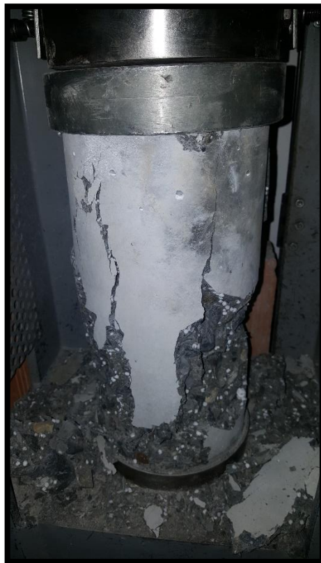
Fotografías N° 25 y 26: Ensayo de resistencia a la compresión para probetas de 28 días de edad.
