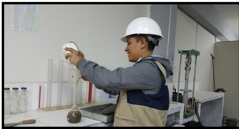
Fotografías N° 08: Procedimiento con el Pictómetro para la determinación la absorción y peso específico del agregado fino.
