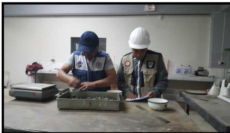
Fotografía N° 05: Preparación del agregado grueso para la determinación de la absorción y peso específico.
