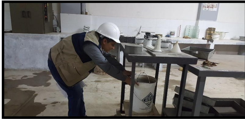
Fotografías N° 06 y 07: Procedimiento para la determinación de la absorción y peso específico del agregado grueso.
