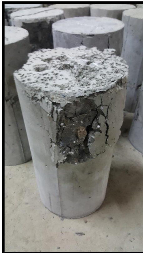
Fotografías N° 17 y 18: Ensayo de resistencia a la compresión para probetas de 07 días de edad.
