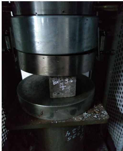
Ruptura de los morteros
