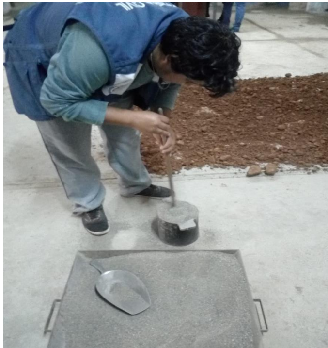
Elaboración de peso unitario compactado
