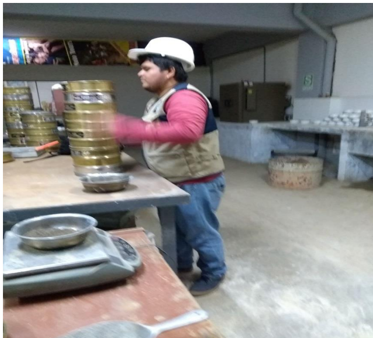
Tamizando por las mallas para la granulometría
