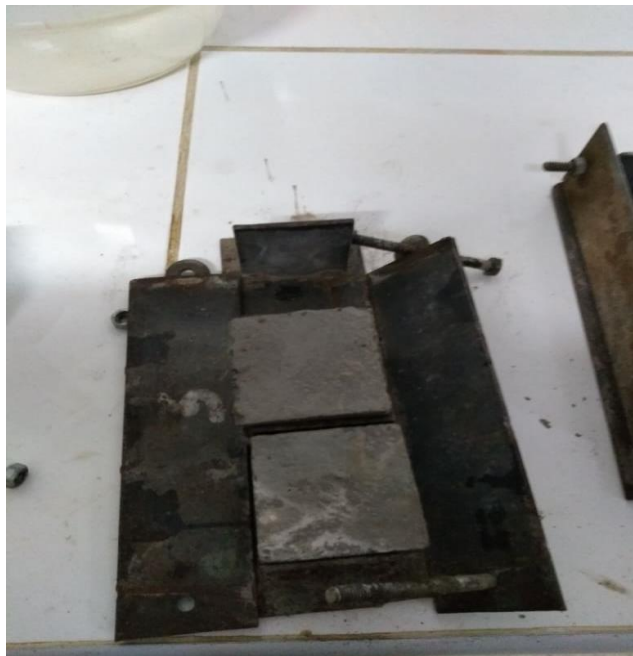
Desencofrado del mortero
