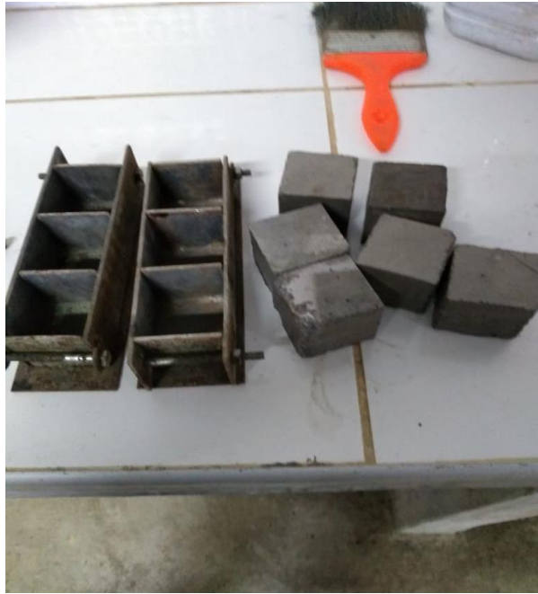
Desencofrado del mortero
