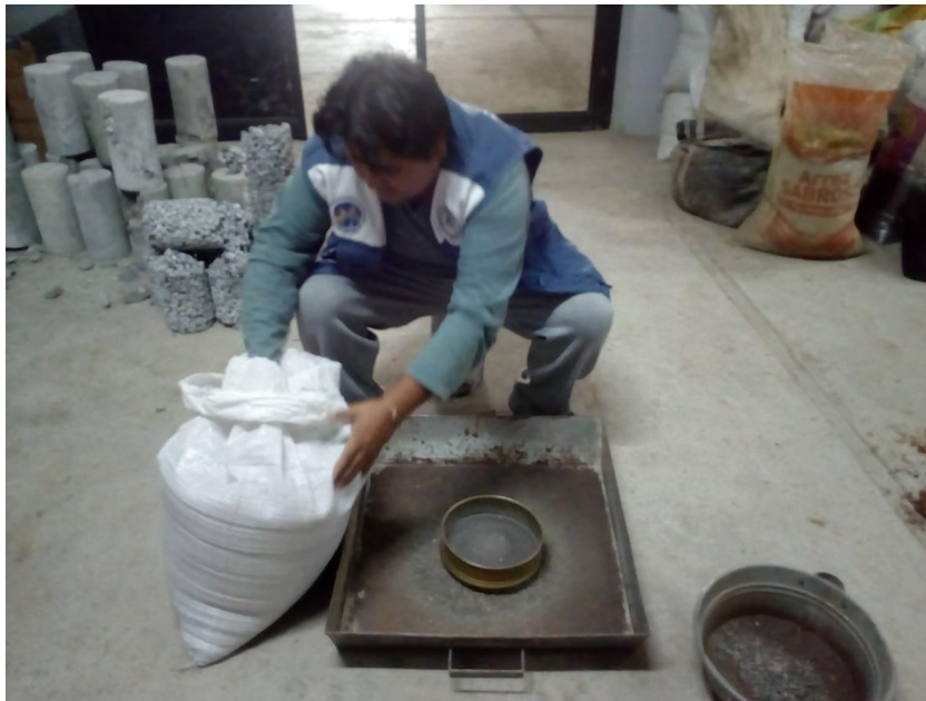
Tamizando el material por la malla N°4
