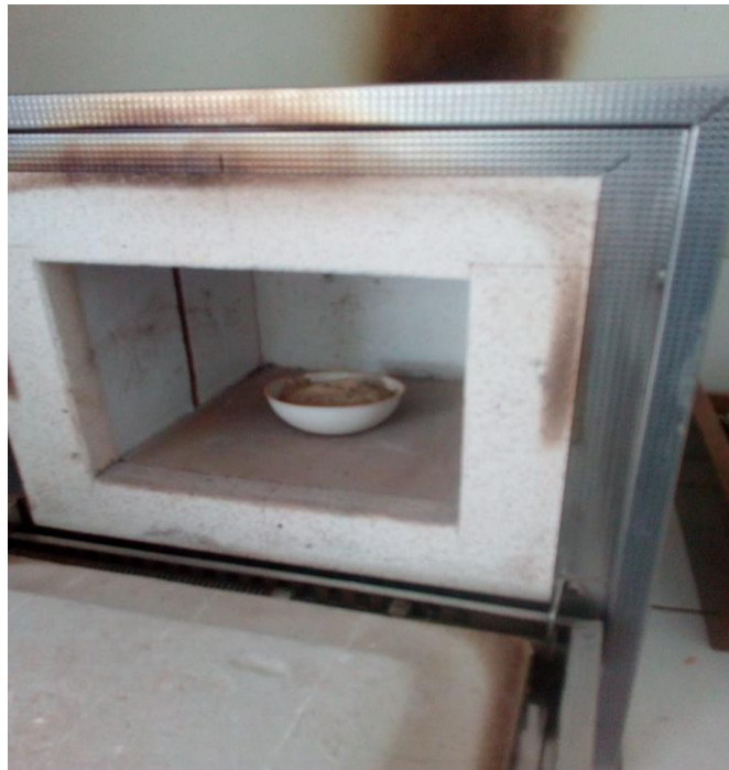
Cascara de arroz en ceniza a 430°C por 2horas
