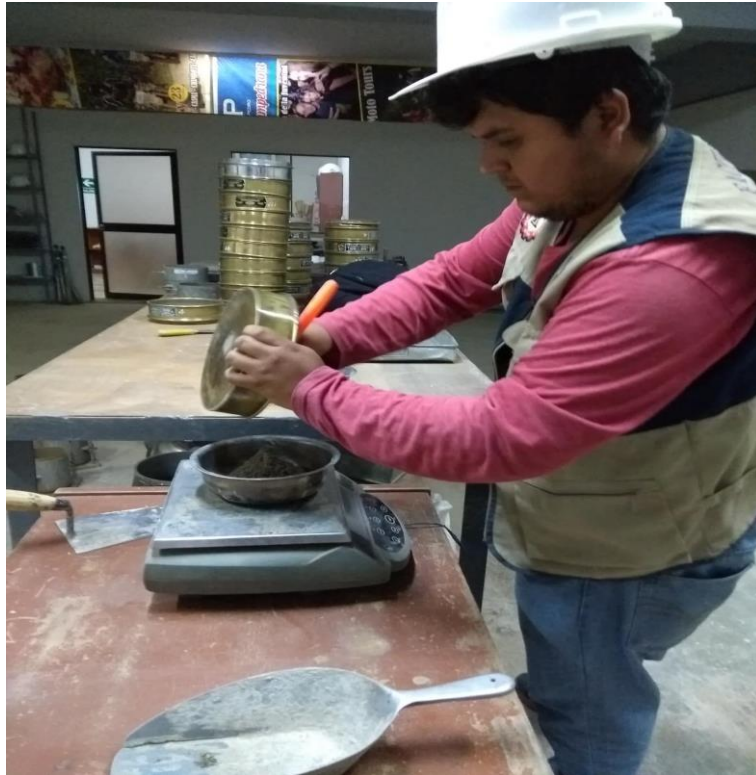
Tamizando por las mallas para la granulometría
