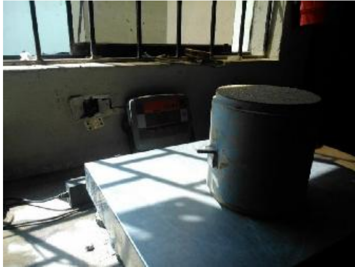
Foto 38: Se toman datos del peso y volumen del molde, También del peso del material húmedo + molde
