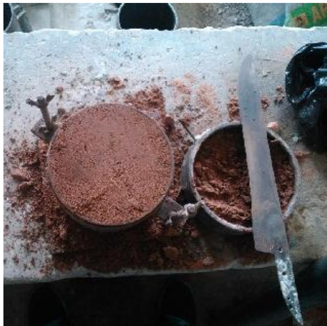
Foto 49: Se enraza al borde del molde
