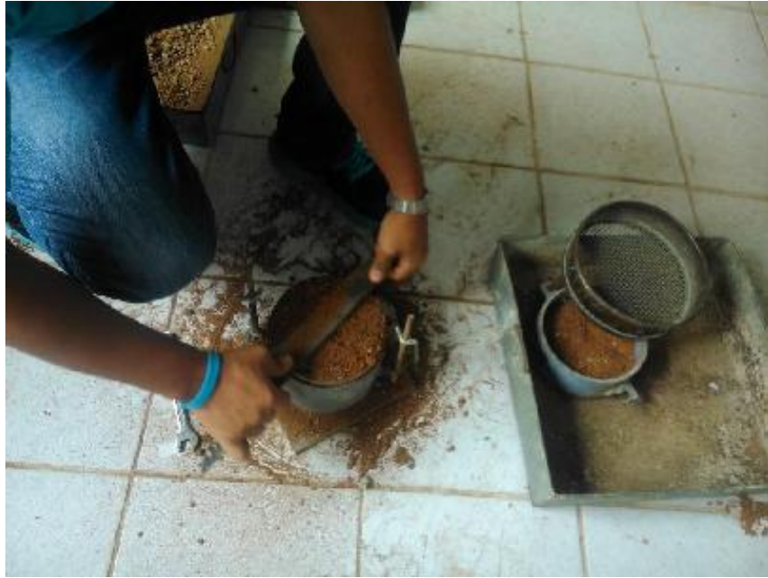
Foto 69: Se retira la corona y se enraza el material al molde.
