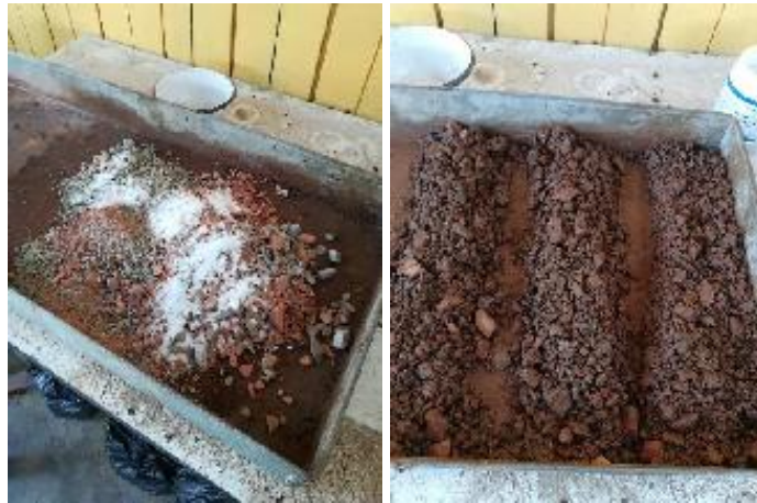
Foto 71: Se añade la cantidad de agua obtenido del proctor modificado
