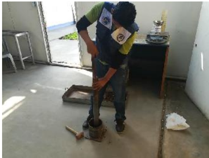
Foto 68: Proctor modificado: método C
