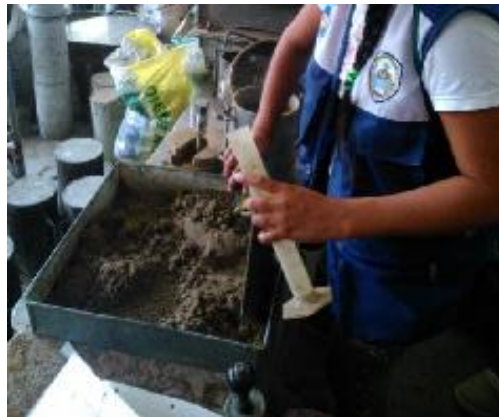
Foto 13: De las 4 bolsas de 3kg de material: Proctor Modificado
