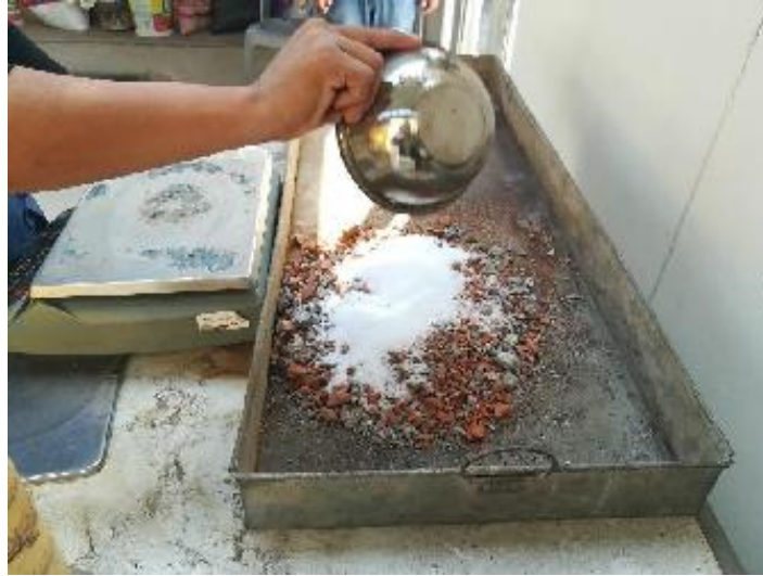
Foto 67: Mezcla del material con cloruro de magnesio, añadiendo porcentajes de 3%, 5%, 7% y 9% de agua al material
