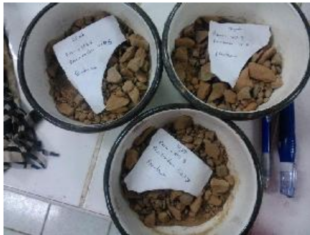
Foto 76: peso del material seco para determinar el porcentaje de absorción.
