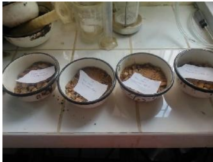
Foto 70: Luego se seca y se pesa el material seco para determinar el contenido de humedad
