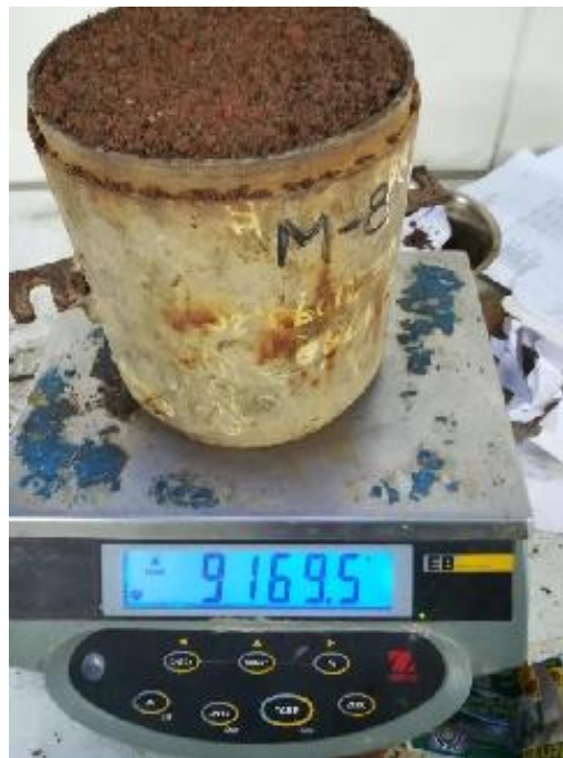
Foto 71: Se añade la cantidad de agua obtenido del proctor modificado
