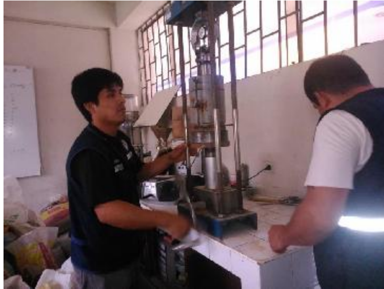
Foto 28: Con la ayuda de los técnicos del laboratorio de suelos se toman datos de la penetración a 0.1 pulg
