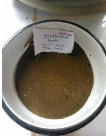
Foto 10: Lavar el material por la malla n° 200, luego secar en horno
