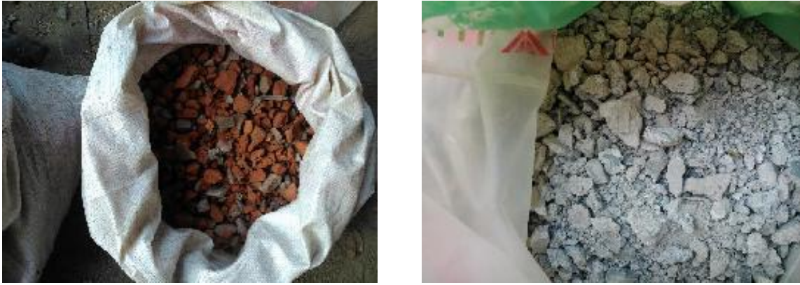
Foto 7: Almacenamiento del material granular reciclado
