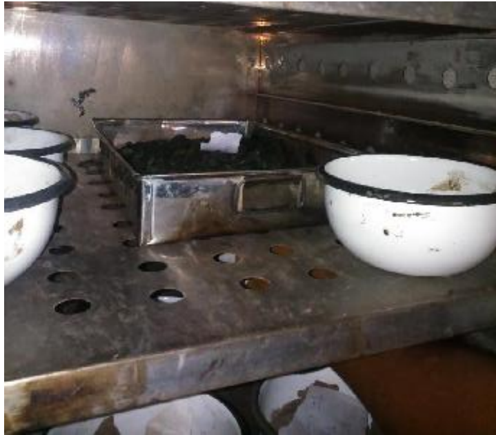
Foto 32: Se coloca al horno a secar el material
