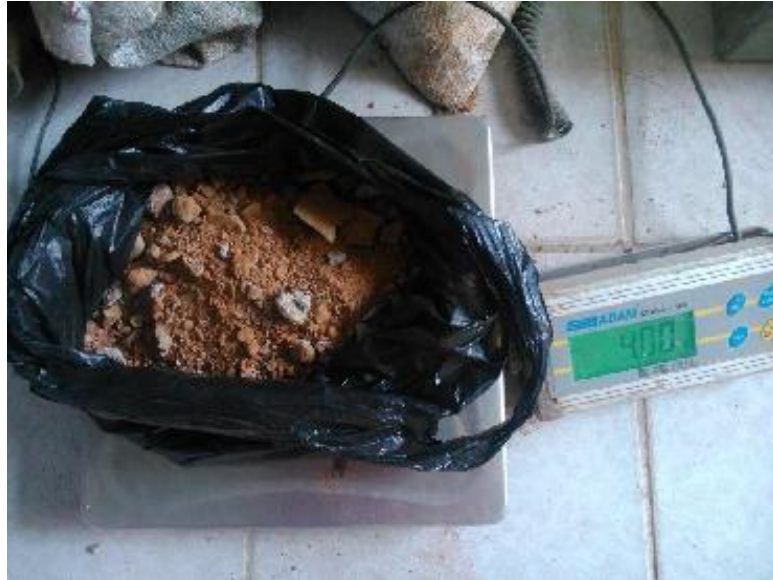
Foto 65: Peso del material para el ensayo de granulometría
