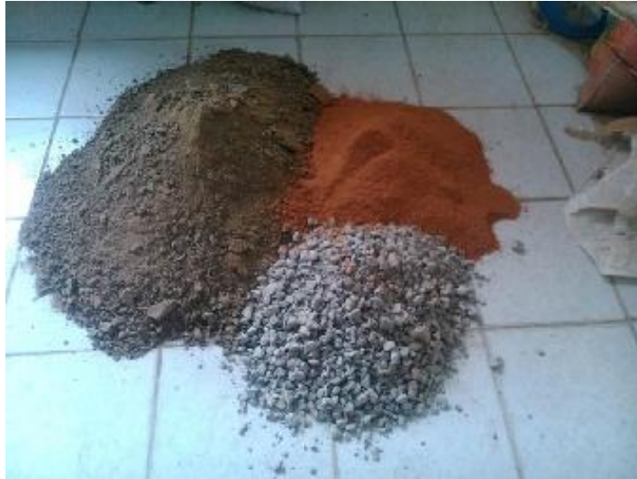
Foto 62: Afirmado, Concreto y ladrillo triturado, Se mezclaron los tres materiales
