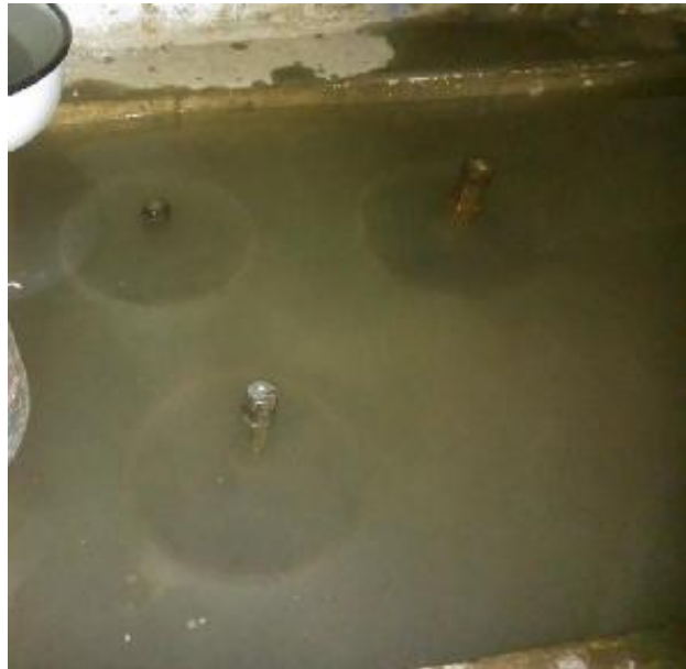
Foto 39: Se sumergen los moldes CBR por 4 a días
