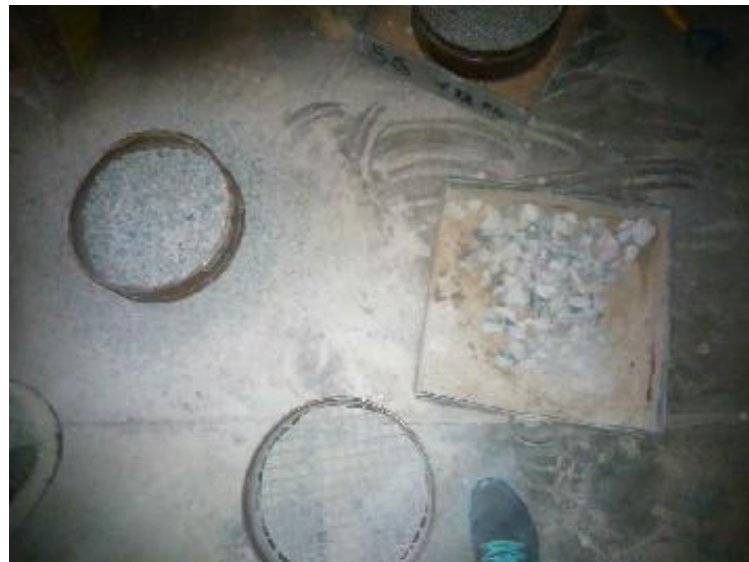
Foto 45: Tamizado de la muestra por malla 3/4'', 3/8'' y N° 4
