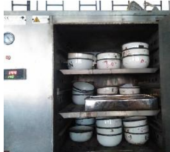
Foto 16: Se toma una pequeña muestra del material húmedo compactado y se coloca al horno a 140°C por 8 horas
