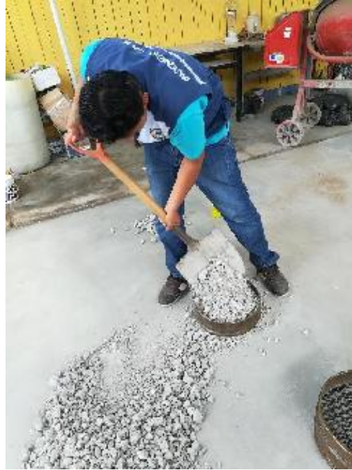
Foto 12: Tamizado de la muestra por malla 3/4'', 3/8'' y N°4
