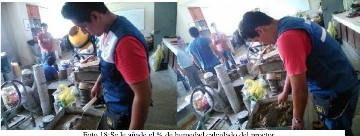
Foto 18:Se le añade el % de humedad calculado del proctor
