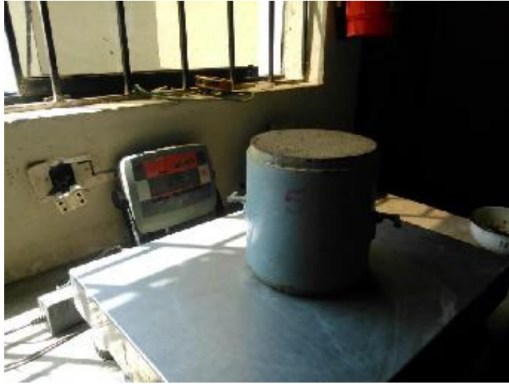
Foto 22: Se toman datos del peso y volumen del molde, También del peso del material húmedo + molde
