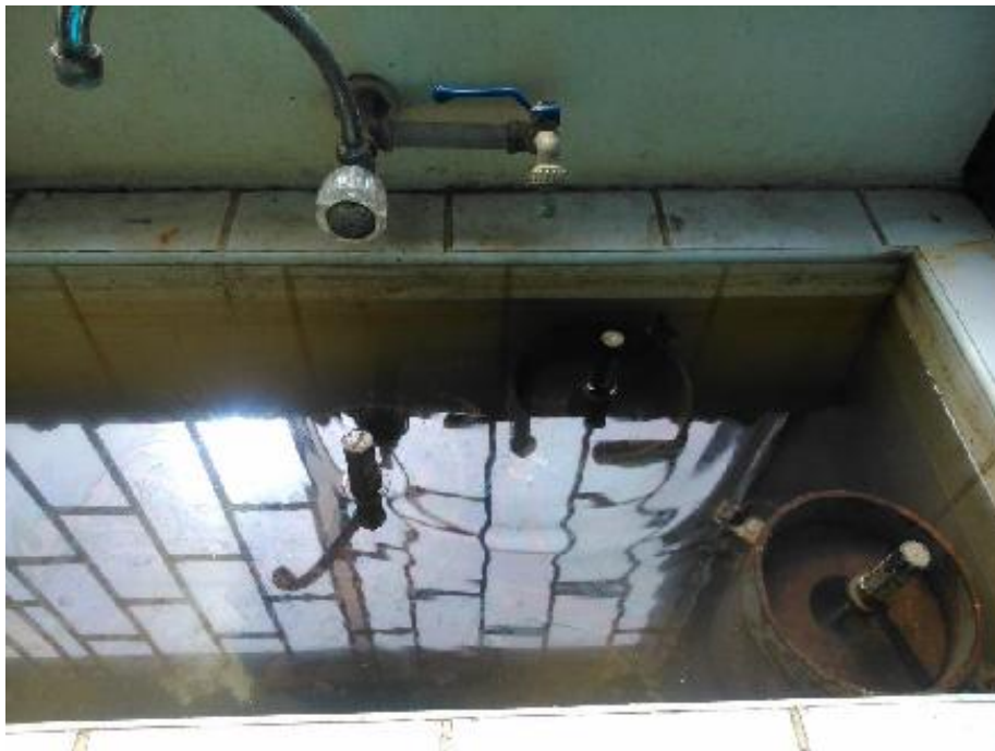
Foto 55: Se sumergen los moldes durante 96 horas.
