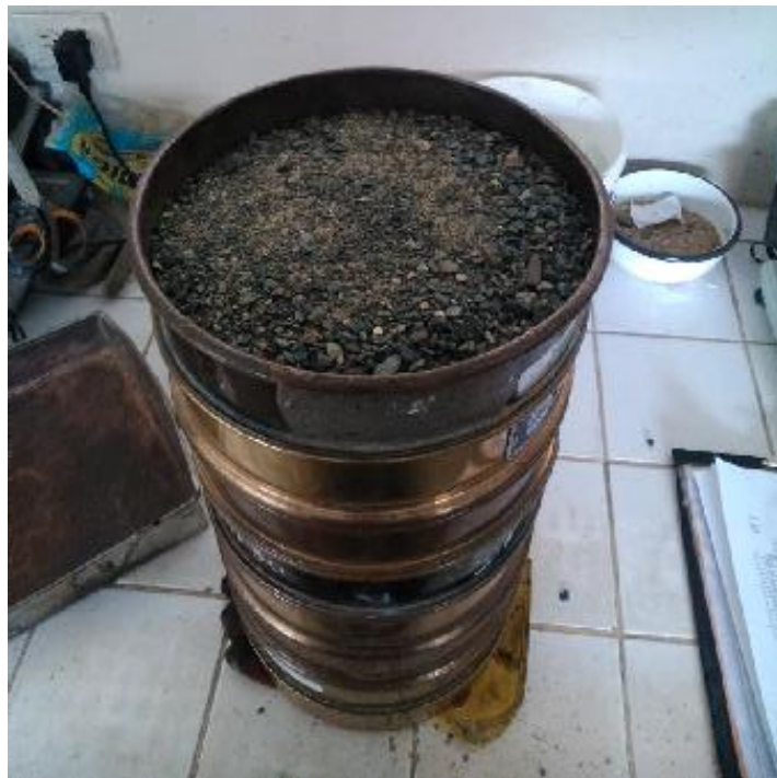
Foto 33: Se tamiza el material seco
