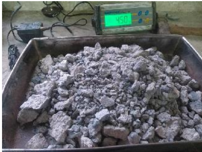
Foto 41:Se pesó 4.50 kg de concreto reciclado, luego se lavó por la malla N°200, y se colocó al horno a secar.
