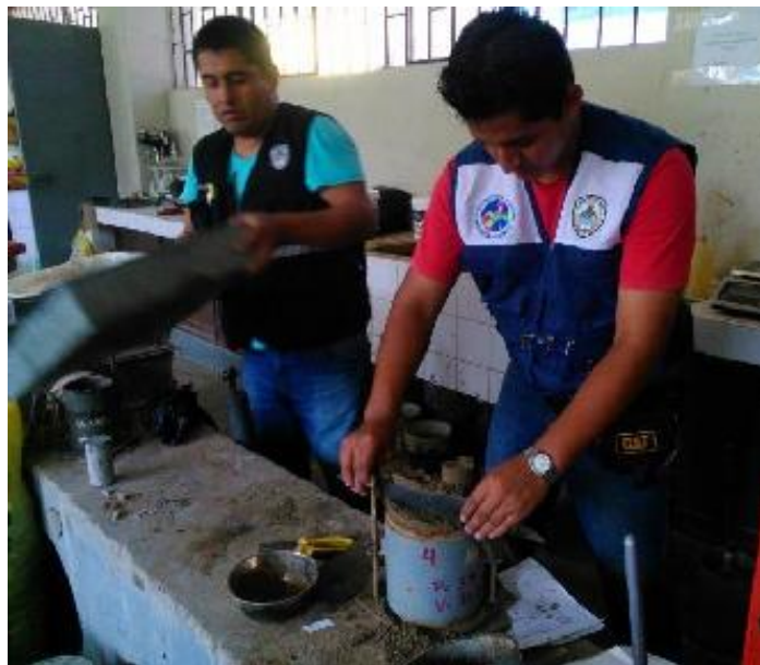
Foto 21:Se retira la corona y se enraza el material al molde mediante un cuchillo para que quede al mismo ras que el cuerpo
