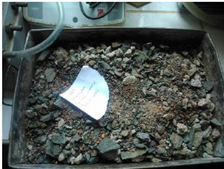
Foto 66: Luego se Seca el material para poder tamizar.
