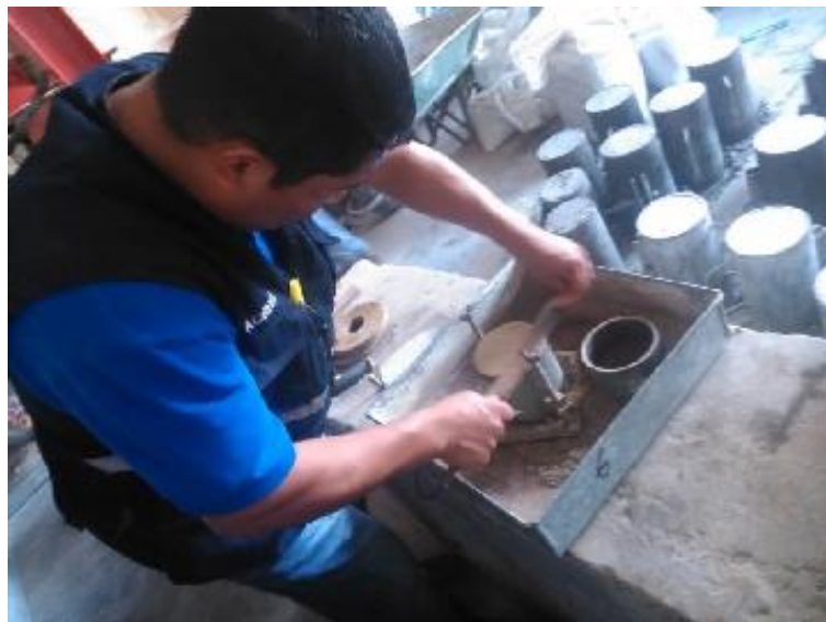
Foto 15: Se enrasa el material al molde mediante un cuchillo para que quede al mismo ras que el cuerpo
