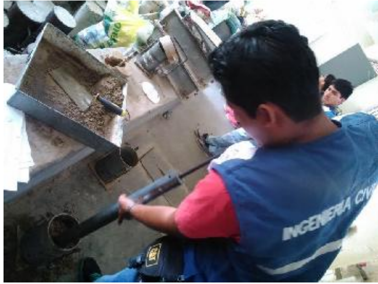
Foto 14: Por cada capa añadida al molde se aplican 56 golpes
