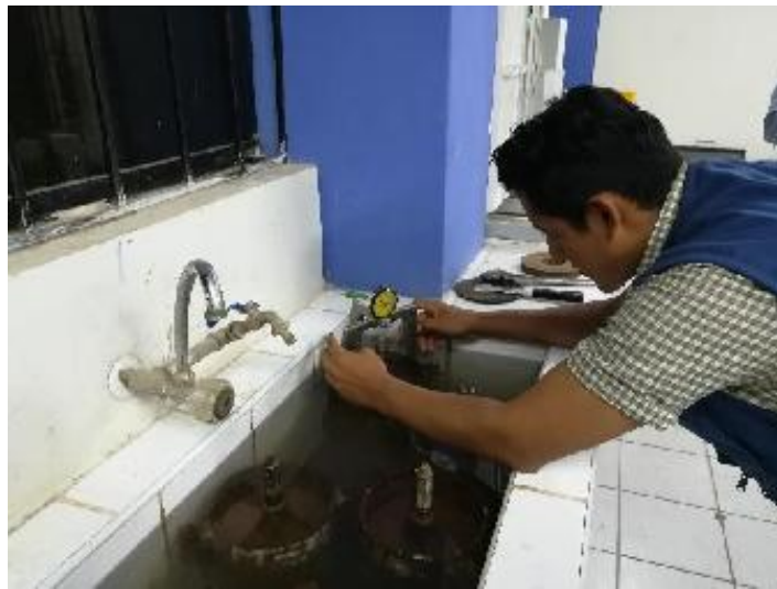
Foto 74: Lecturas de Expansión del Afirmado con el dial
