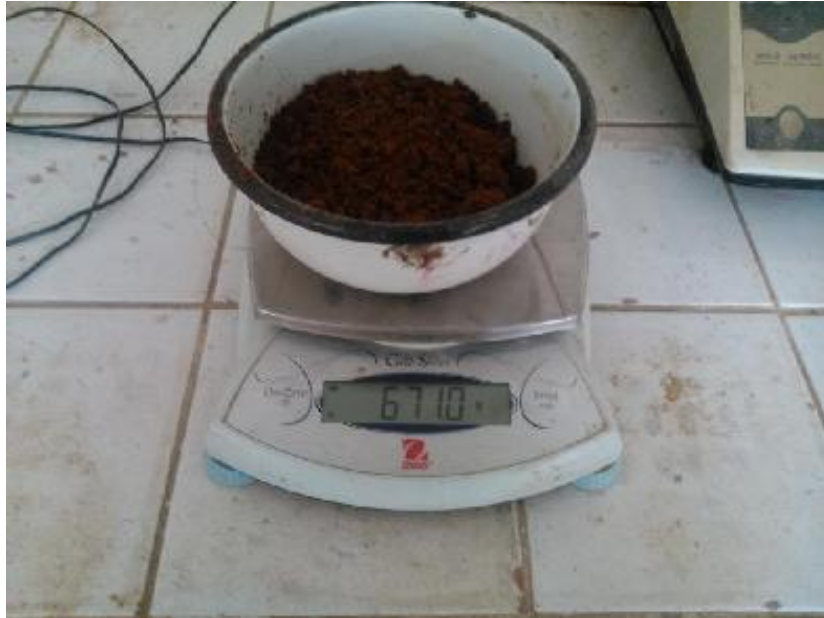
Foto 50: Se extraen pequeñas cantidades de material compactado y se coloca al horno para luego calcular su contenido de humedad
