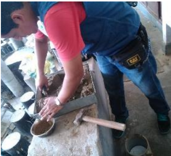
Foto 19:Se divide al material en 5 partes y se le añade al molde
