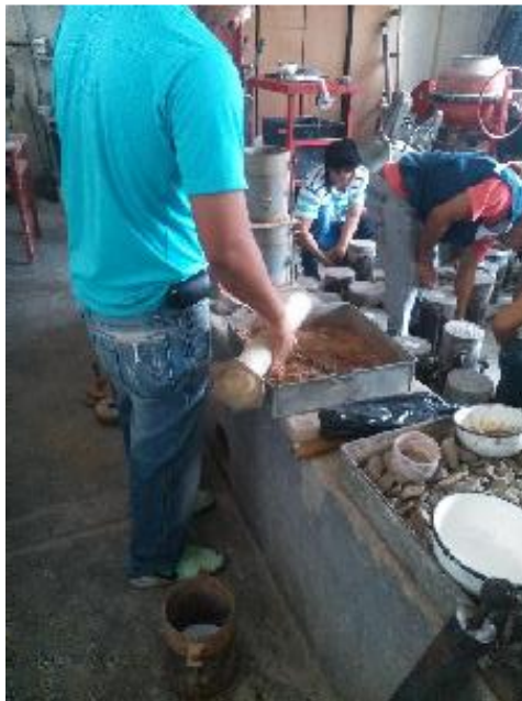
Foto 51: Se adiciona la cantidad de agua obtenido del proctor modificado
