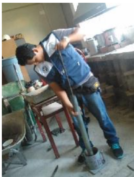
Foto 37: En el primer molde por cada capa se golpea 56 veces, En el segundo molde por cada capa se golpea 25 veces, En el tercer molde por cada capa se golpea 10 veces
