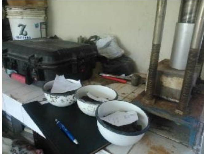
Foto 58: Por cada molde se extrae pequeñas cantidades de material, se pesa el material húmedo, se pone a secar en el horno y se pesa el material seco
