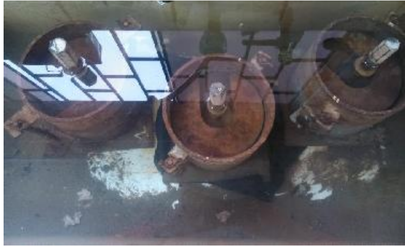
Foto 73: Se sumergen los moldes durante 96 horas
