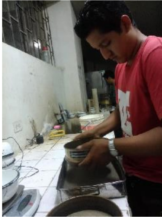
Foto 44: Se tamiza el material de ladrillo triturado
