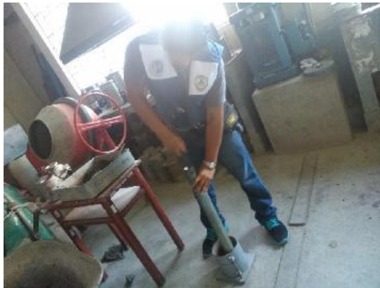
Foto 36: Al material se divide en 5 partes, Por cada capa añadida al molde se aplican 56 golpes
