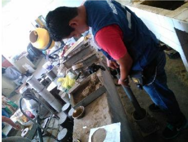
Foto 20:En el primer molde por cada capa se golpea 56 veces, En el segundo molde por cada capa se golpea 25 veces, En el tercer molde por cada capa se golpea 10 veces
