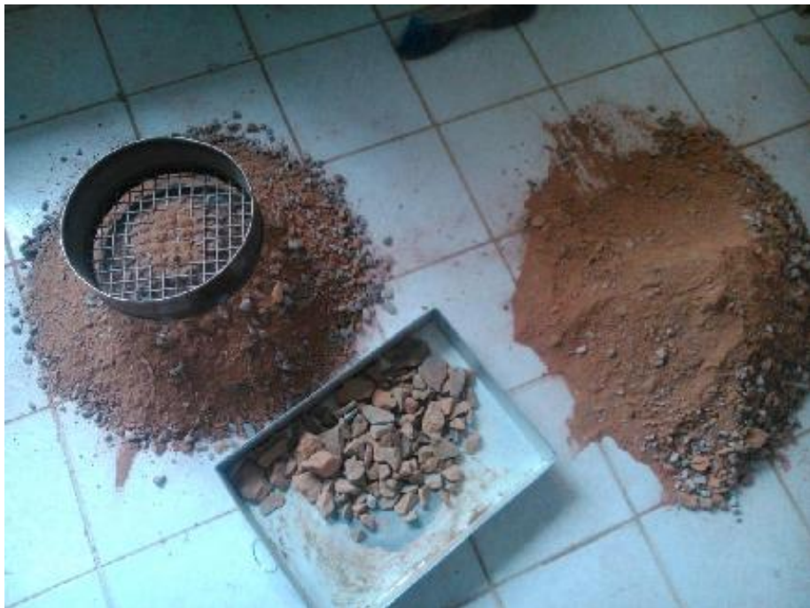
Foto 63: Tamizado de la muestra por malla 3/4'', 3/8'' y N° 4
