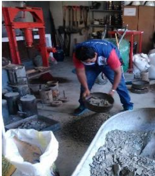
Foto 34: Tamizado de la muestra por malla 3/4'', 3/8'' y N°4
