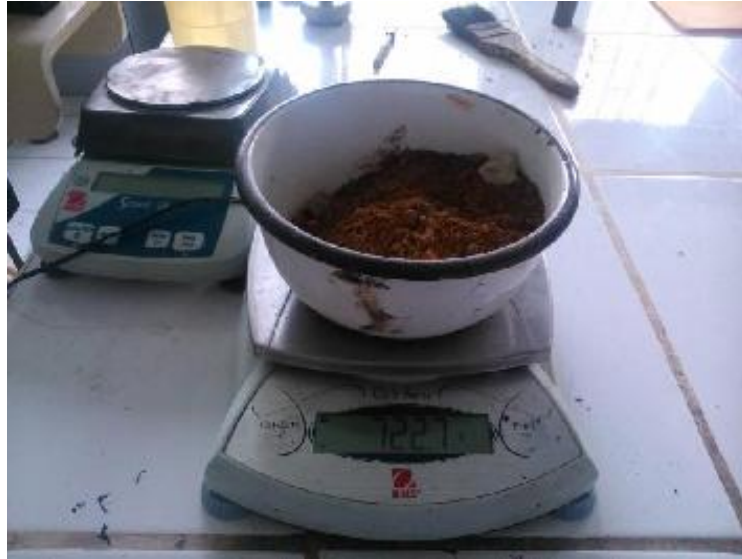
Foto 54: Se extrae una pequeña cantidad del material compactado, se pesa el material húmedo, luego se coloca al horno y se pesa el material seco para determinar su contenido de humedad
