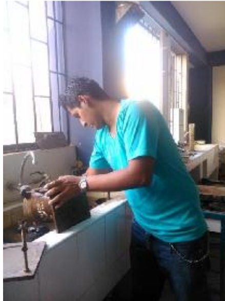
Foto 56:Una vez pasado las 96 horas sumergidas se retiran los moldes para su posterior ensayo de penetración.
