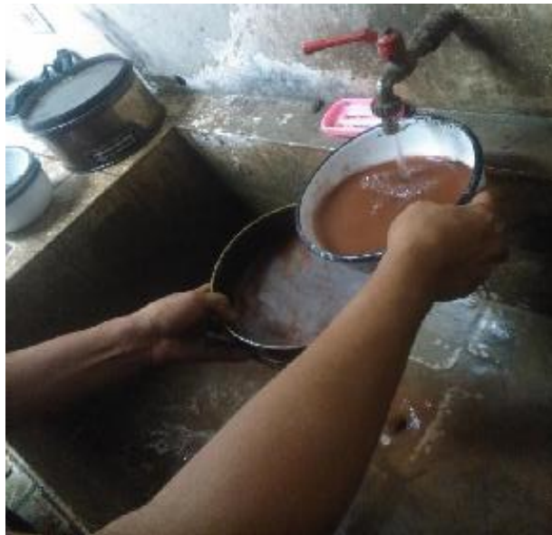
Foto 43:Lavado del ladrillo triturado
