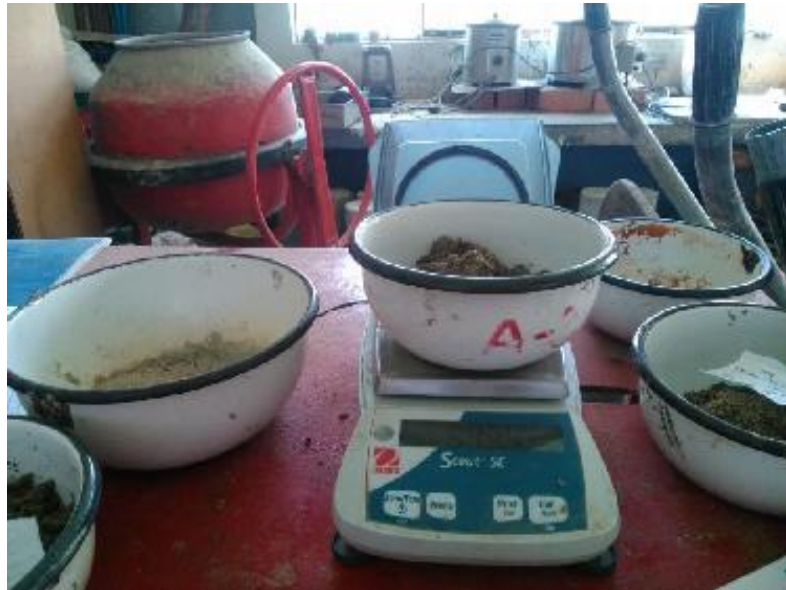
Foto 23: Se toma una pequeña muestra del material húmedo compactado y se coloca al horno a 140^{\circ}\text{C} por 8 horas
