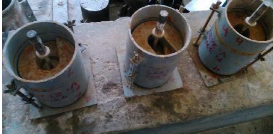
Foto 24:Tres moldes de 56, 25 y 10 golpes correspondientes
