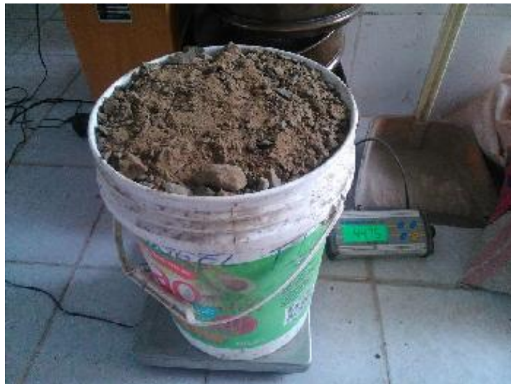
Foto 59: Peso del material granular, sub-base
