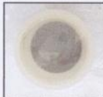
Figura 2. Muestra de ceniza de cáscara de arroz, colocada en el portamuestras
