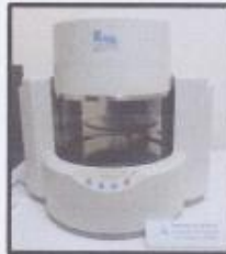
Figura 3. Muestra colocada en el Espectrómetro de Fluorescencia de Rayos X
