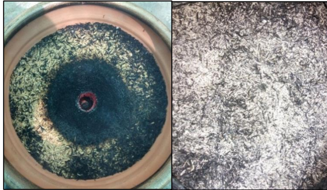
Fig. 08: Muestra de la ceniza obtenida después del proceso de calcinación.
