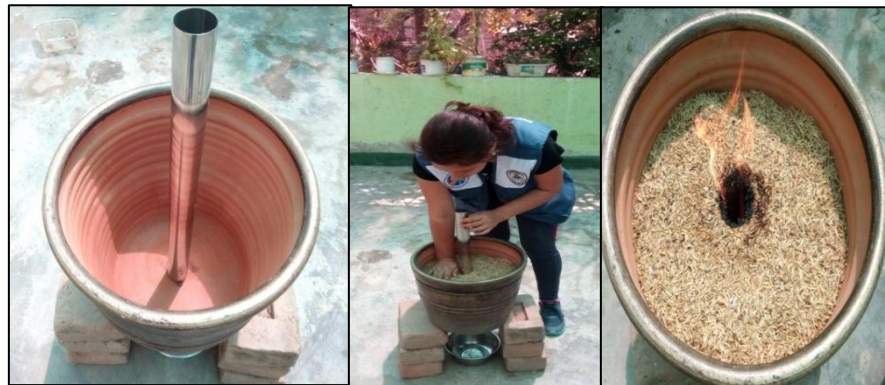
Fig. 07: Calcinación a campo abierto de la cáscara de arroz.
