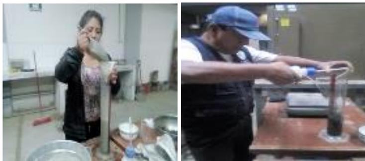
**Fotografía N°09:** Calculando el peso específico de cáscara de huevo y arcilla y porcentajes de sustitución por el método de desplazamiento.
