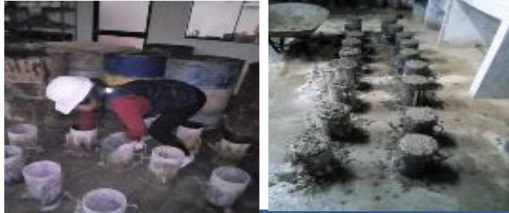
**Fotografía N°10:** Limpiar probetas y engrasar cada una de ellas, listos para el vaciado de concreto.
