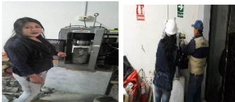
**Fotografía N°13:** Preparación y colocación de las testigos para las roturas correspondientes con la prensa hidráulica
