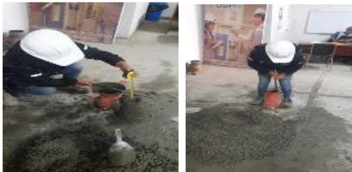
**Fotografía N°08:** Elaboración del slump para la mezcla patrón y experimental.
