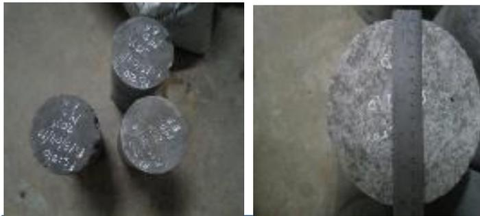
**Fotografía N°12:** Desencofrado y medido cada probeta.
