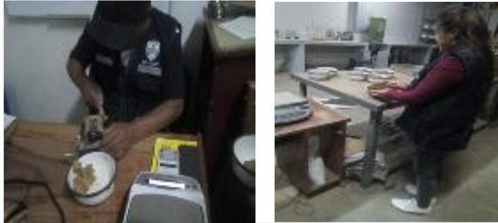
**Fotografía N°05:** Calculando el limite líquido y plástico de la arcilla
