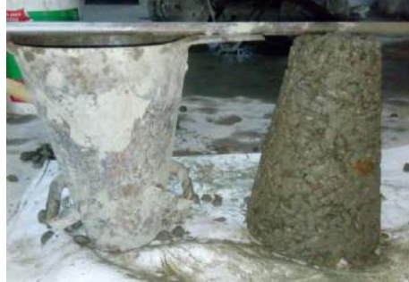
FIGURA 9: Cono de Abrams (Asentamiento del Hormigón Permeable)
