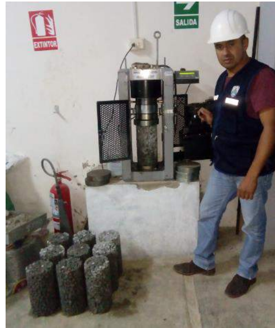
FIGURA 27: Rotura de probetas 28 días.
