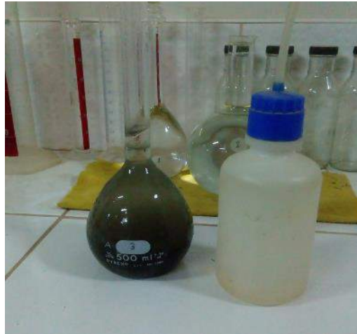
FIGURA 17: Peso específico del agregado fino.
