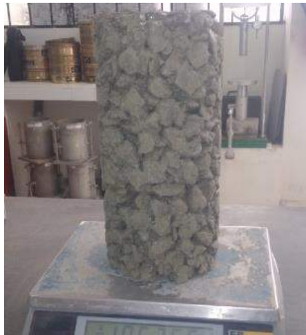
FIGURA 31: Pesado del concreto en estado endurecido.
