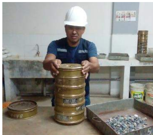
FIGURA 14: Tamizado de los agregados.
