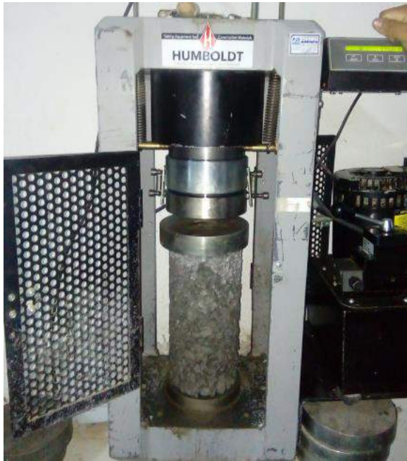
FIGURA 26: Rotura de probetas 7 días.
