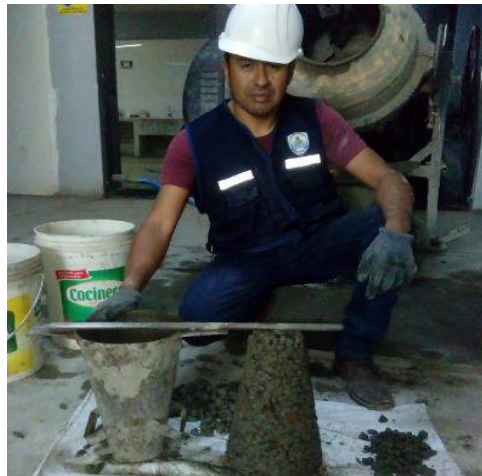
FIGURA 24: Prueba de Slump.
