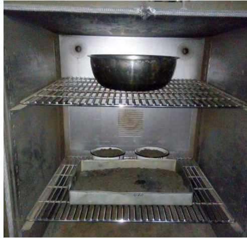
FIGURA 16: Secado en el horno para el contenido de humedad.
