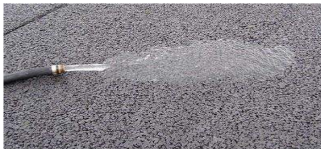
FIGURA 12: Capacidad de filtración del Hormigón Permeable.
