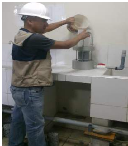
FIGURA 30: Ensayo de Permeabilidad.
