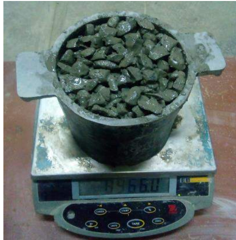
FIGURA 25: Pesado del concreto en estado fresco.
