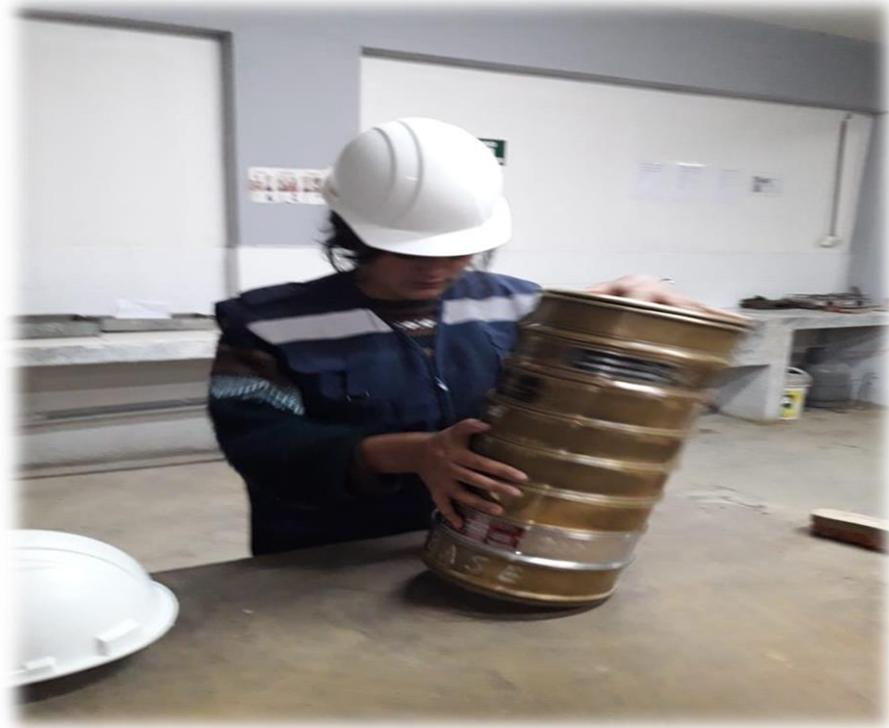
**Fotografía N° 09: tamizado del agregado**
