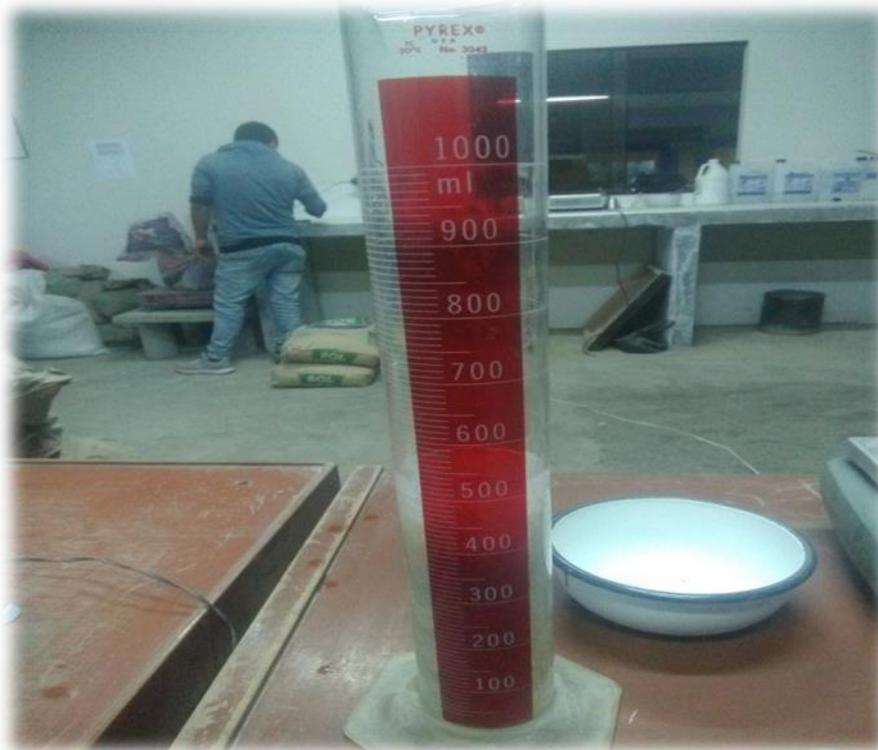
**Fotografía N° 05:** cálculo del peso específico por desplazamiento de la fibra de Nylon
