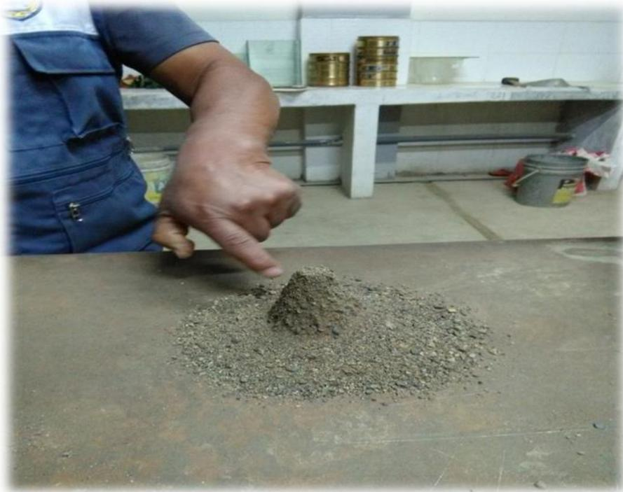
**Fotografía N° 13:** aplicación del cono de absorción
