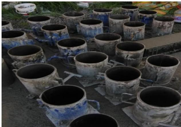
**Figura 1.** Moldes cilíndricos
