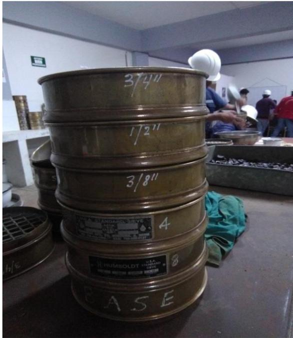
**Figura 4:** Tamices para ensayo granulométrico
