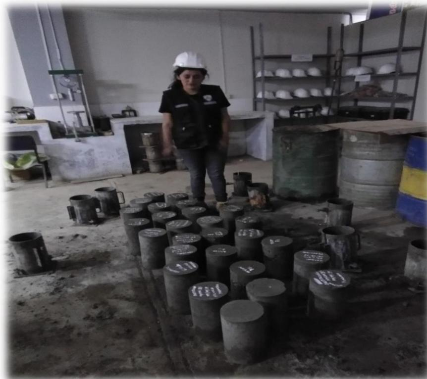
**Fotografía N° 18:** desmolde de testigos cilíndricos
