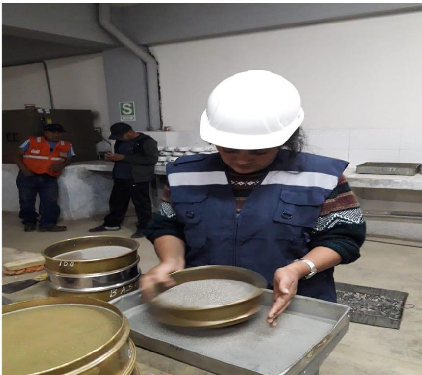
**Fotografía N° 10: Tamizado del agregado fino**
