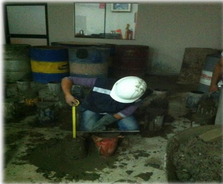
**Fotografía N° 17:** ensayo de asentamiento del concreto
