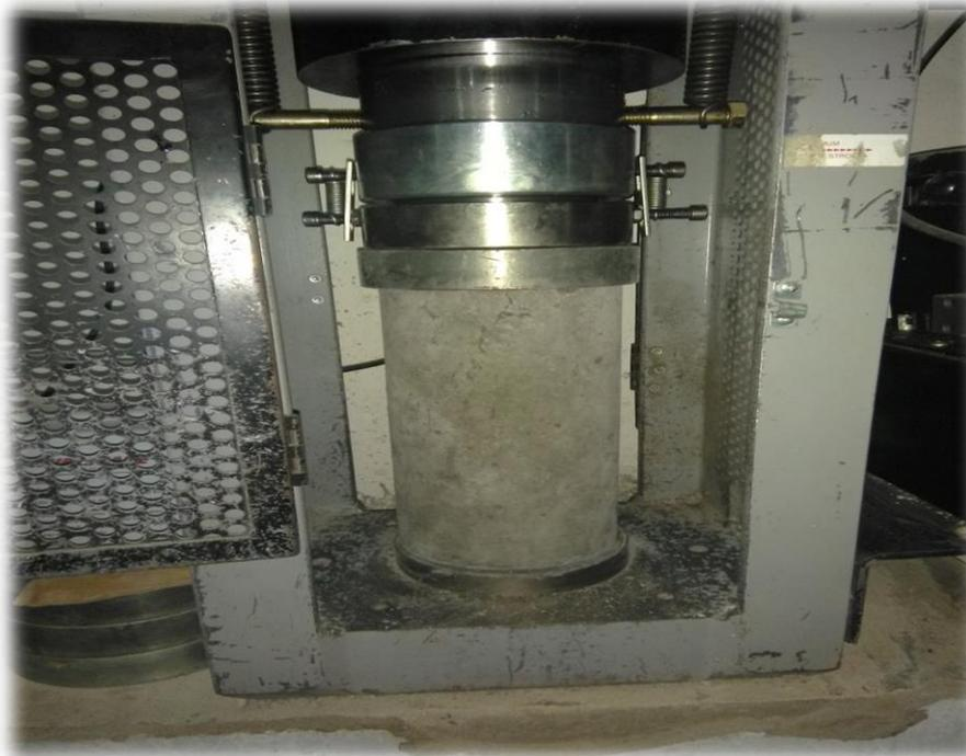
**Fotografía N° 20:** ensayo a compresión del concreto experimental
