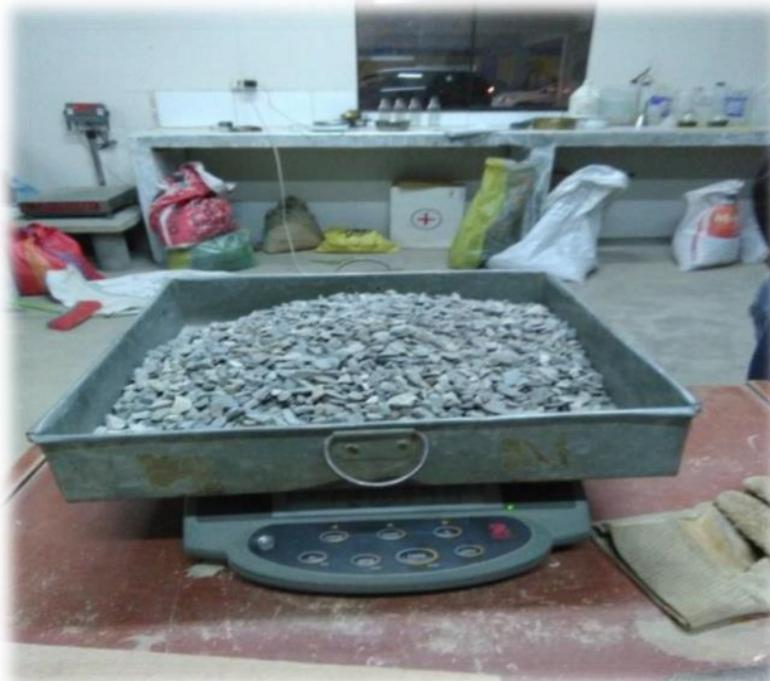
**Fotografía N° 08:** peso del agregado grueso
