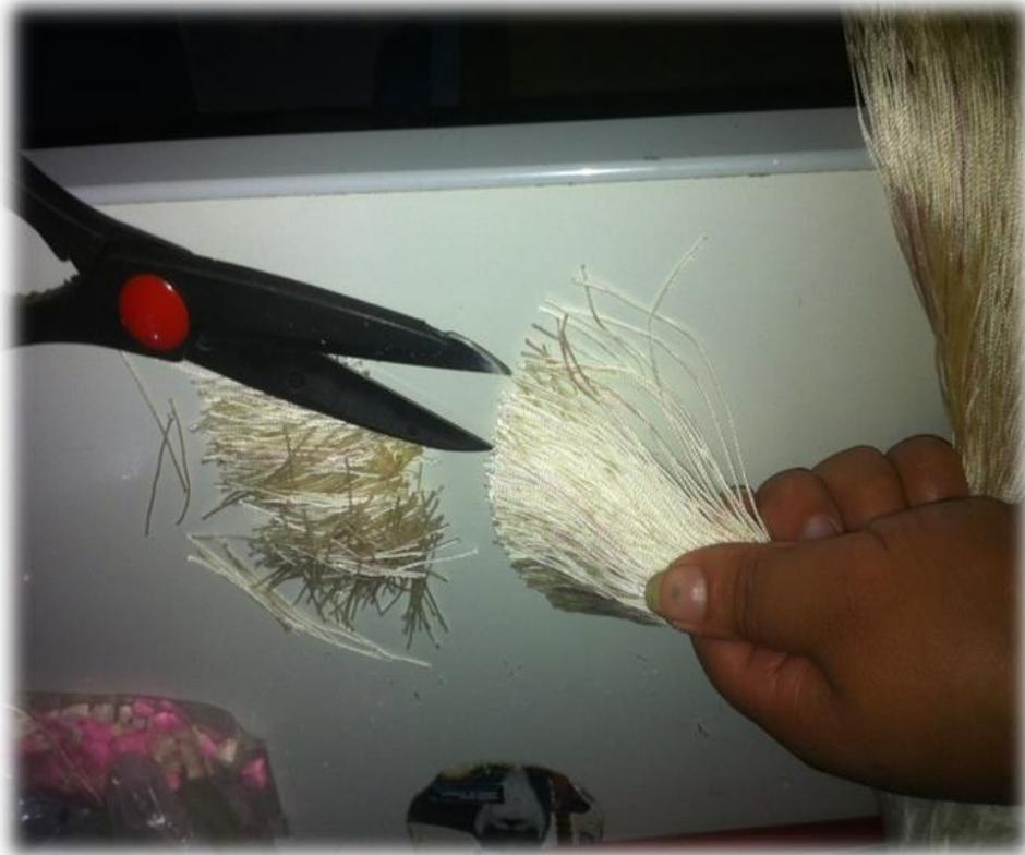
**Fotografía N° 03:** corte manual de la fibra de Nylon.
