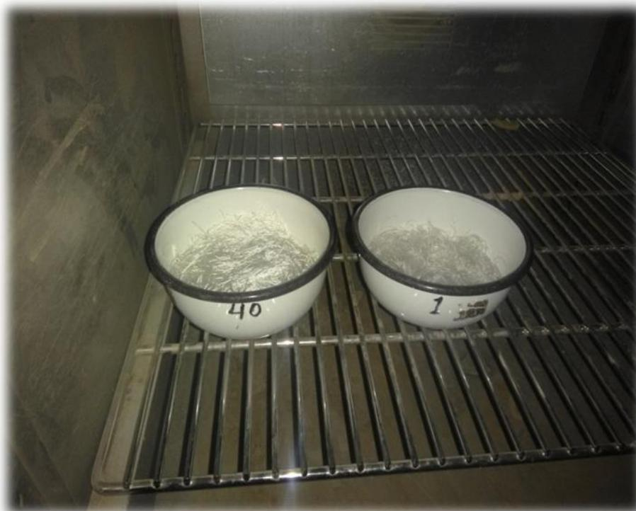
**Fotografía N° 06:** muestras para el contenido de humedad y porcentaje de absorción
