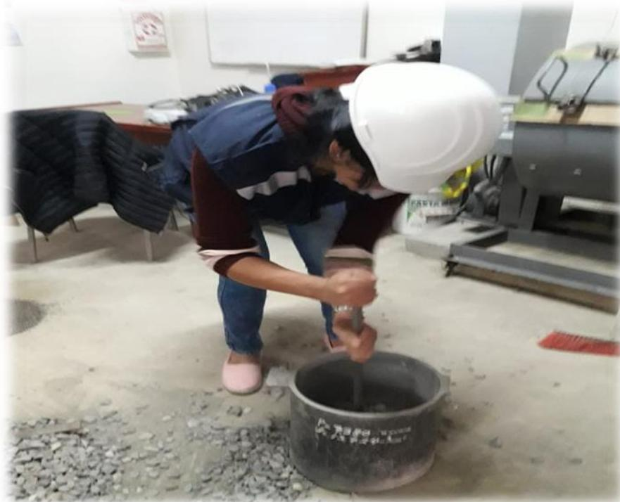
**Fotografía N° 11:** ensayo de peso unitario compactado del agregado grueso
