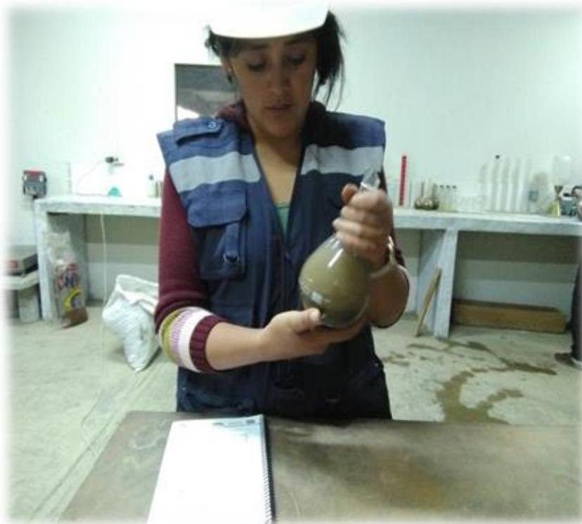
**Fotografía N° 14:** ensayo del peso específico del agregado fino
