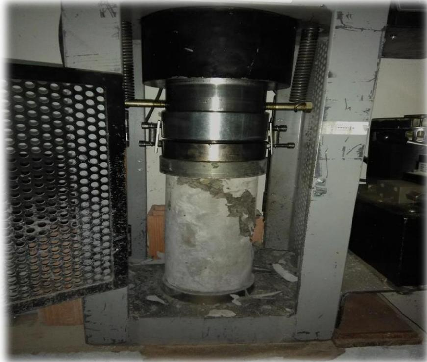
**Fotografía N° 19:** ensayo a compresión del concreto convencional
