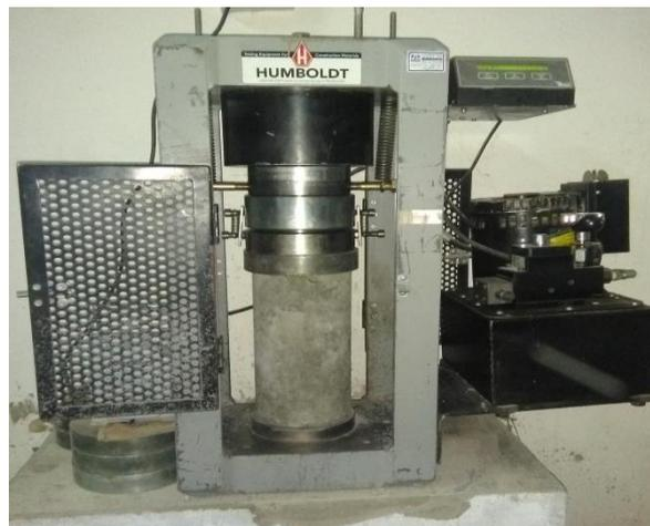
**Figura 2.** Resistencia a la compresión
