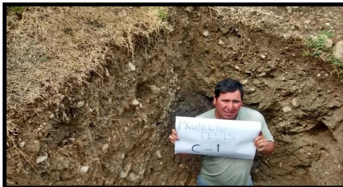
Foto 9: Excavación de calicata N°1
