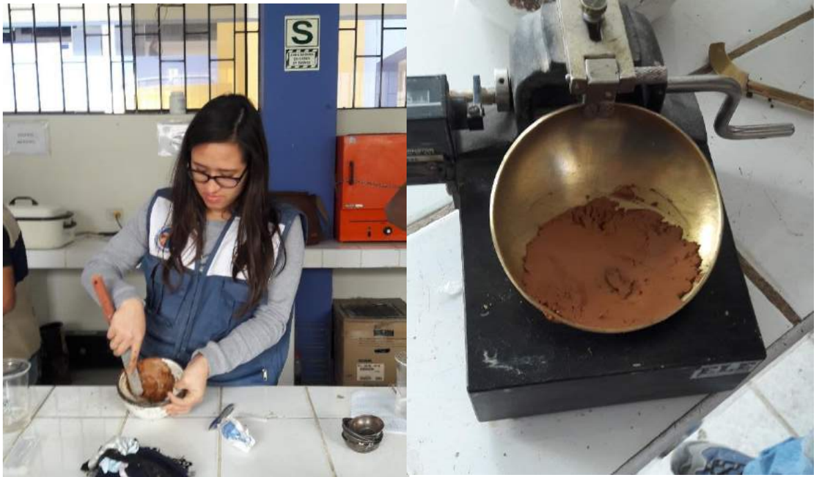
Foto N°8. Se realizaron los límites de atterberg en el laboratorio de mecánica de suelos usp
