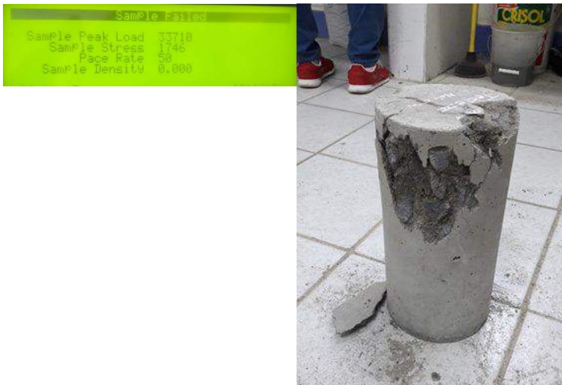
Foto N° 19. Se observa la rotura de la segunda probeta a los 7 días
