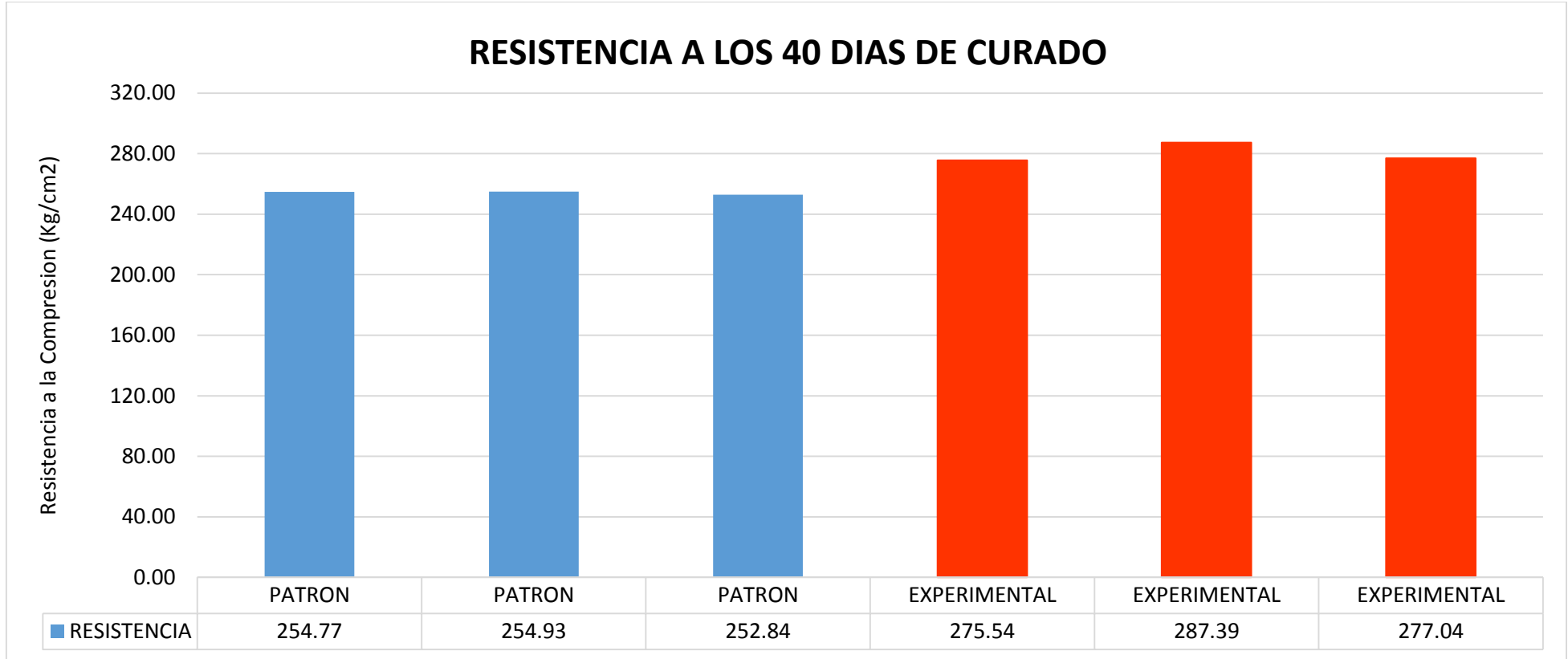
Figura 09. Resistencia a los 40 días de Curado Patrón vs. Experimental
