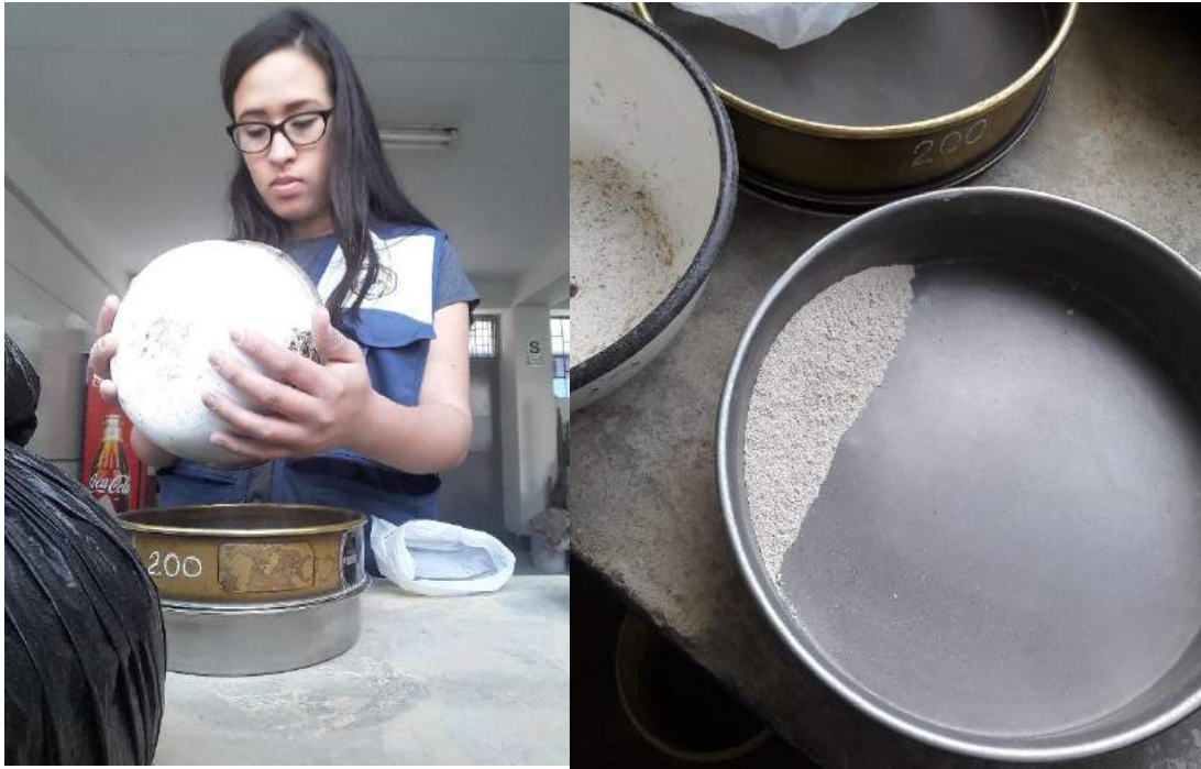
Foto N°4. Concha Pata de Mula limpia siendo tamizada y pasada por la malla n°200
