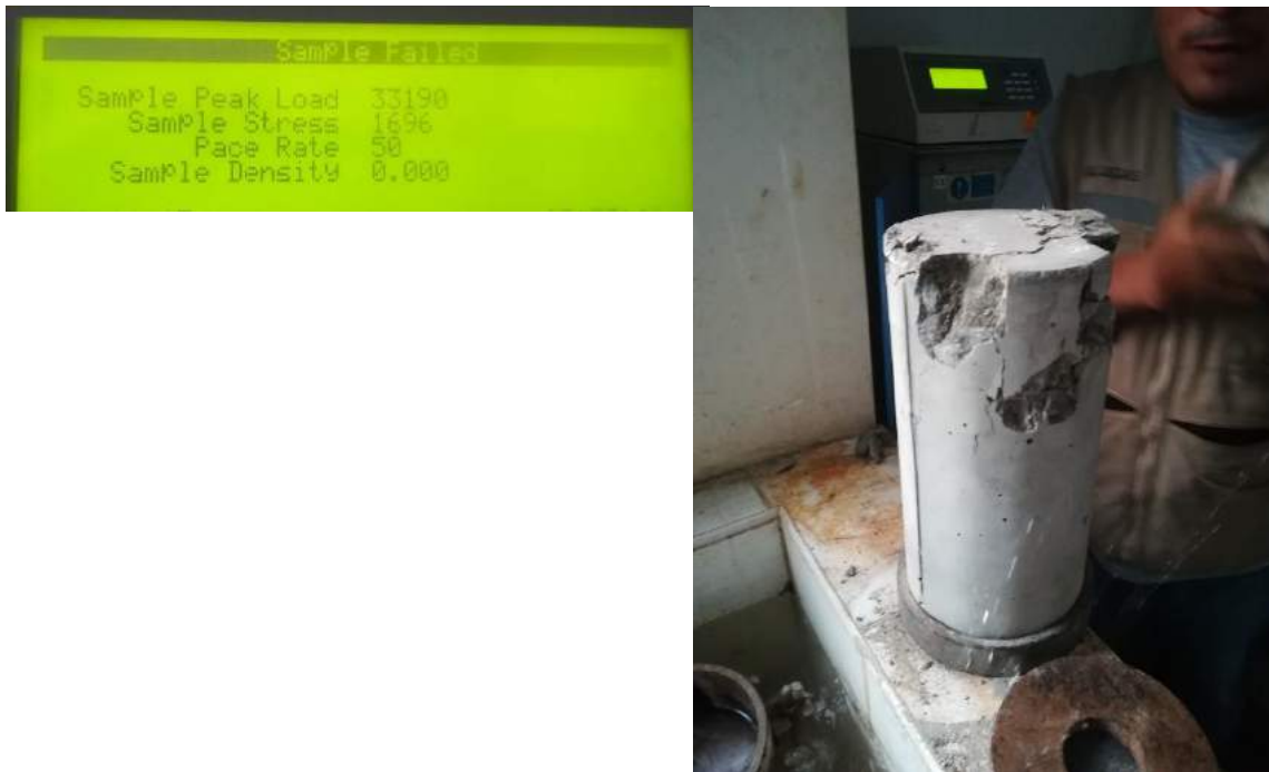
Foto N° 19. Se observa la rotura de la segunda probeta a los 7 días
