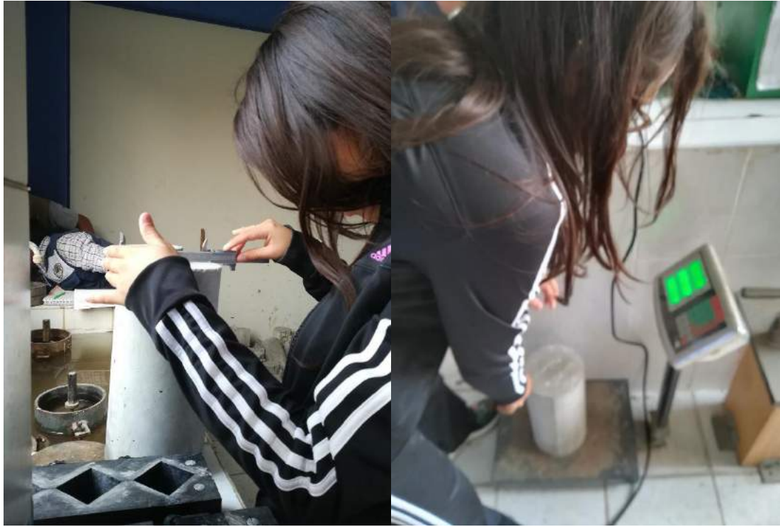
Foto N° 17. Midiendo el diámetro de cada probeta y realizando el pesaje, este procedimiento se realizó antes de curar las probetas y antes de ensayarlas.
