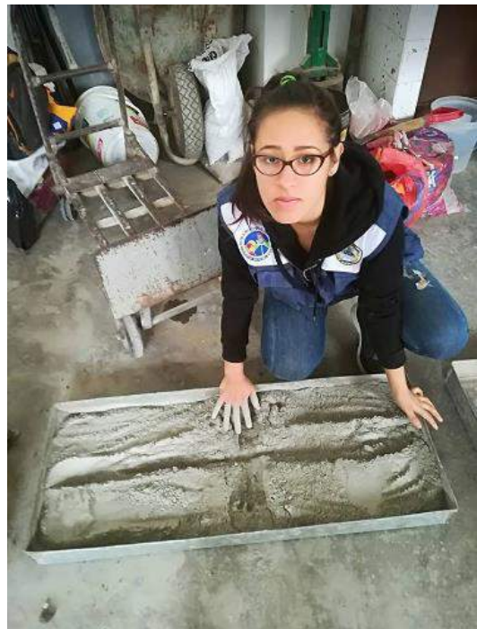
Foto N° 30. Cuarteo de la Concha pata de Mula, la Arcilla y el Cemento para luego ser mezclada
