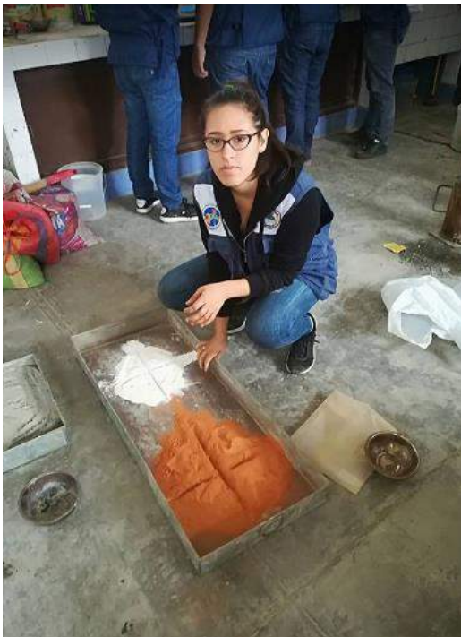
Foto N° 30. Cuarteo de la Concha pata de Mula, la Arcilla y el Cemento para luego ser mezclada
