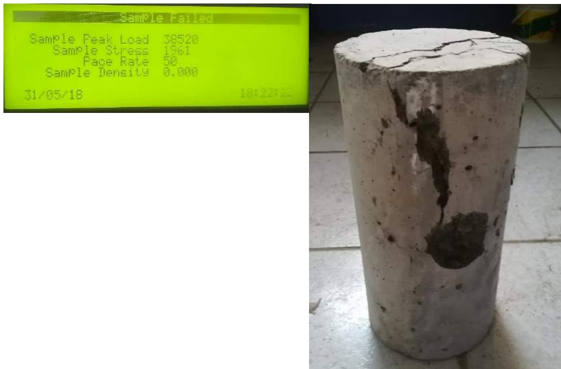
Foto N° 24. Se observa la rotura de la segunda probeta a los 28 días
