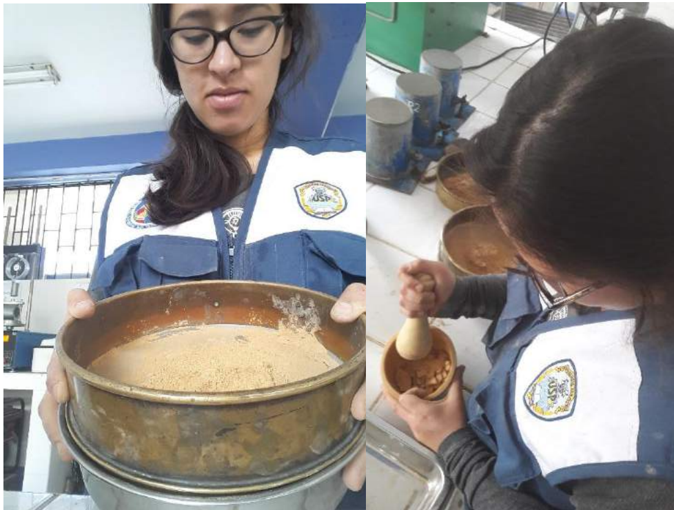
Foto N°7. Realizamos la trituración y tamizado de la arcilla por la malla n°200
