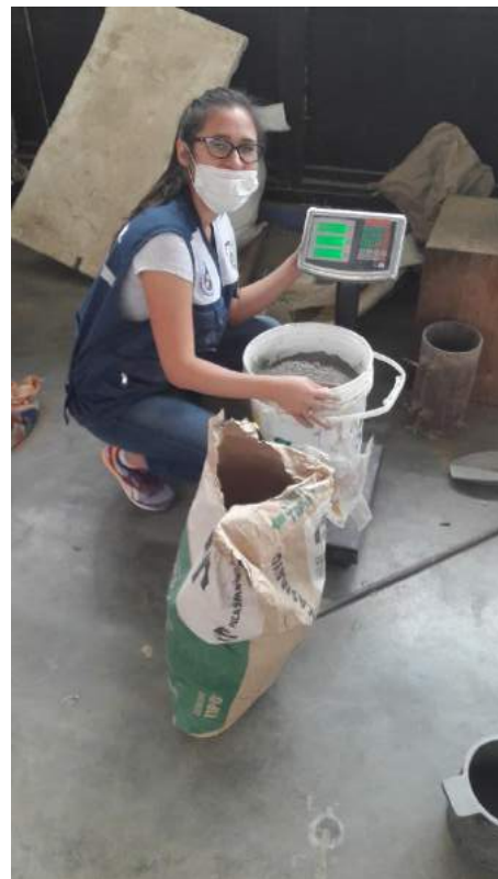
Foto N° 12. Se observa la proporción en peso del cemento
