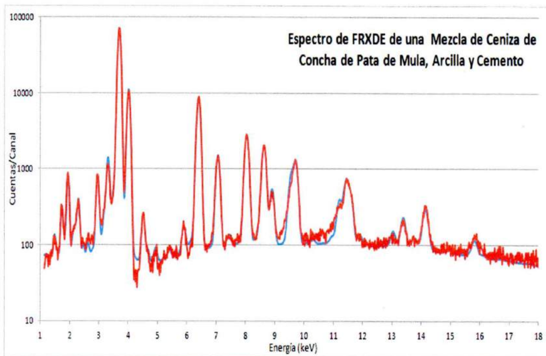
Figura 1. Espectro de FRXDE de una mezcla de ceniza de concha de pata de mula, arcilla y cemento en escala semi logarítmica. Incluye el pico de Ar del aire y los picos de rayos-X de Au dispersados por la muestra. La curva en azul muestra el espectro simulado
