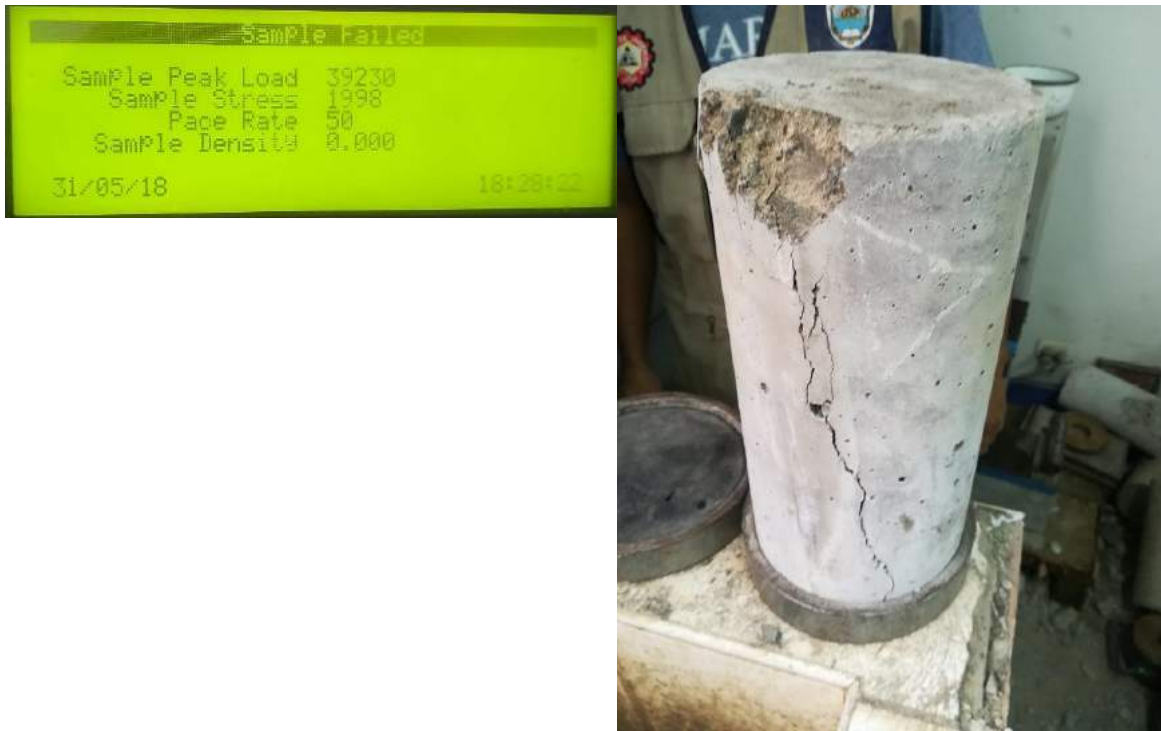
Foto N°23. Se observa la rotura de la primera probeta a los 28 días
