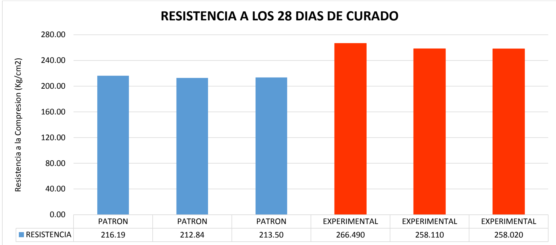
Figura 08. Resistencia a los 28 días de Curado Patrón vs. Experimental
