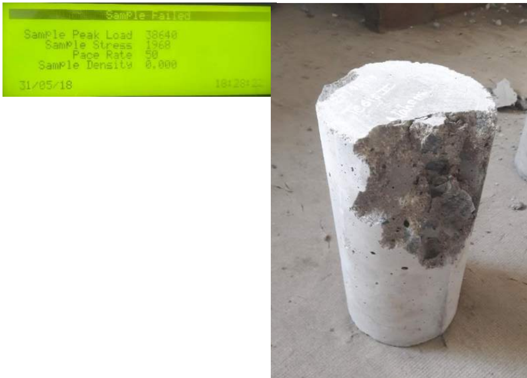
Foto N° 25. Se observa la rotura de la tercera probeta a los 28 días
