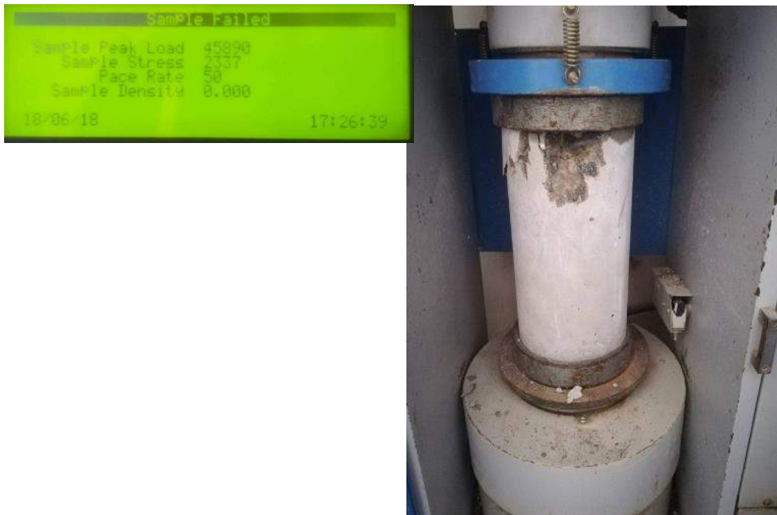
Foto N° 28. Se observa la rotura de la tercera probeta a los 40 días
