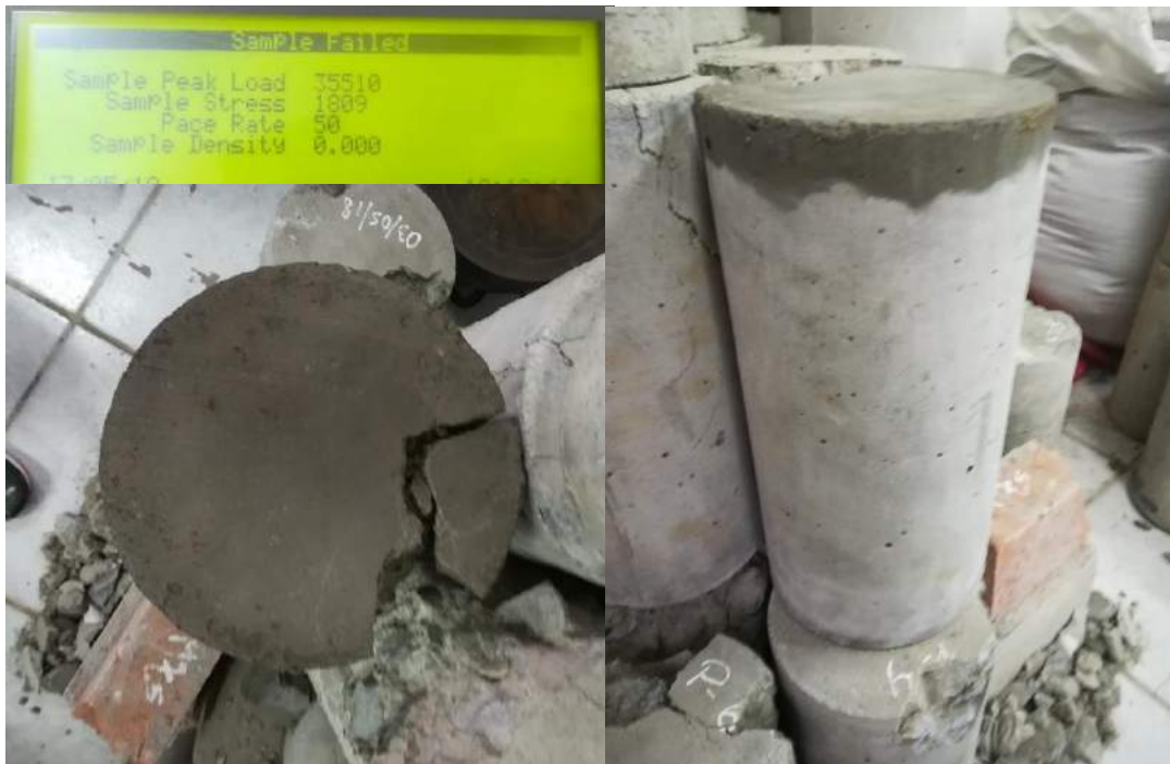
Foto N° 21. Se observa la rotura de la primera probeta a los 14 días
