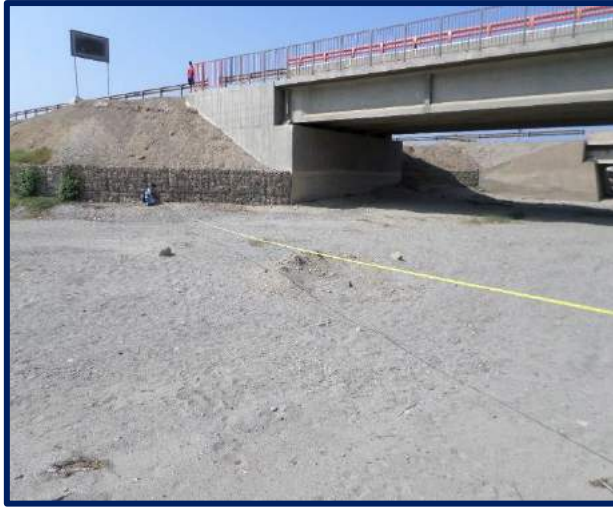
Ilustración 3: En esta imagen se muestra realizando medidas respectivas para poder caracterizar la forma del cauce del río, ya que es un dato muy importante para realizar el modelamiento hidrológico de la cuenca del río Culebras
