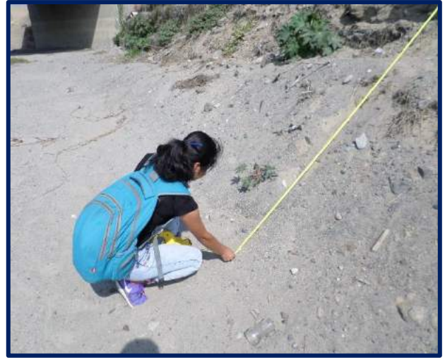
Ilustración 3: En esta imagen se muestra realizando medidas respectivas para poder caracterizar la forma del cauce del río, ya que es un dato muy importante para realizar el modelamiento hidrológico de la cuenca del río Culebras
