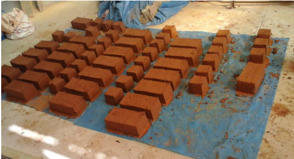
Fotografía 18. Tendido de adobes para su secado.
