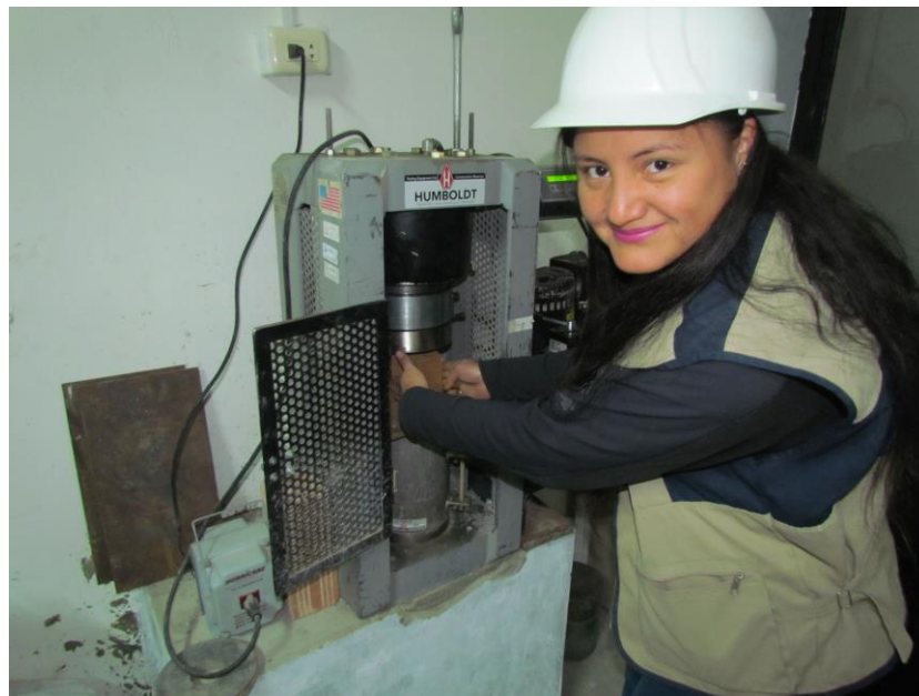
Fotografía 20. Colocación del bloque de adobe.
