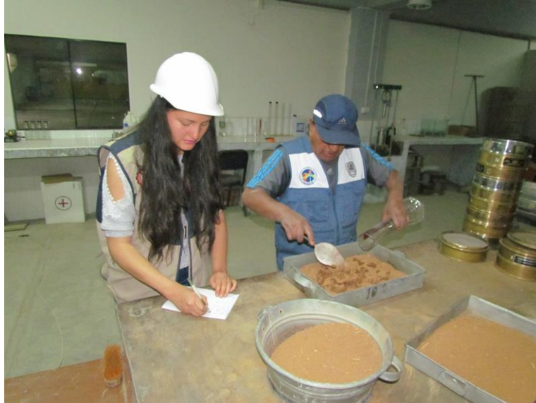
Fotografía 13. Proceso de preparación del material añadiendo agua.
