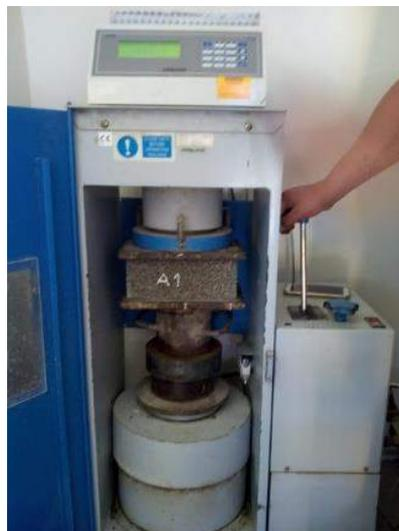
*FOTO 29: Ensayo a la compresión de los ladrillos*
