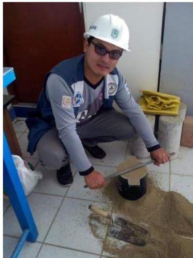
*FOTO 21: nivelado de los agregados*
