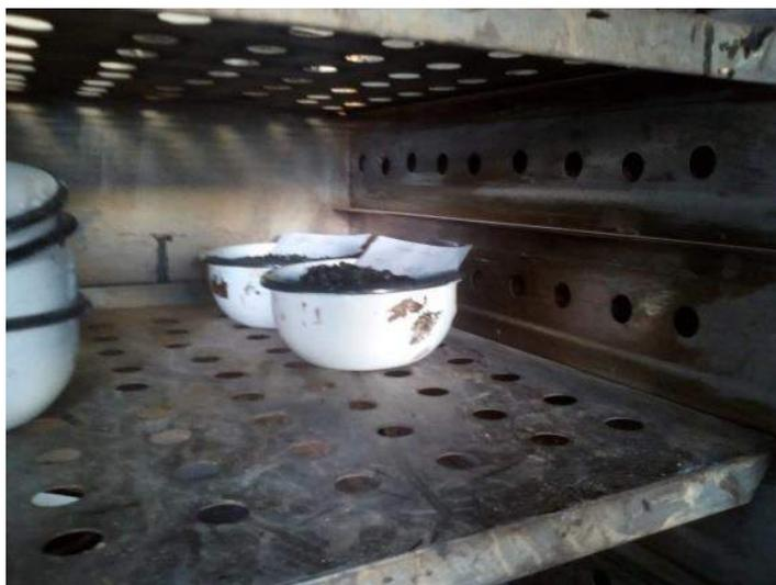
*FOTO 26: agregados en proceso de secado 24 horas*
