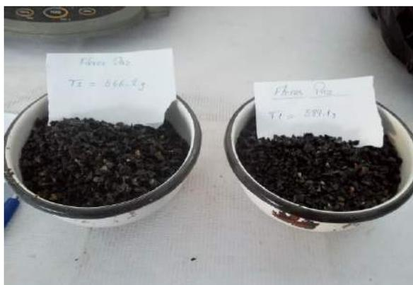
Se tomó el peso sumergido del confitillo para luego ser secado en el horno.
