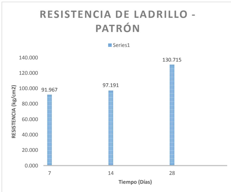
*Grafico 5: Resistencia a la compresión de ladrillos patrón curados sumergido.*
