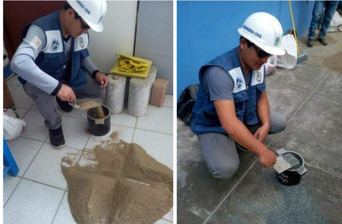
*FOTO 20: colocación del material fino y grueso en el molde cilíndrico*
