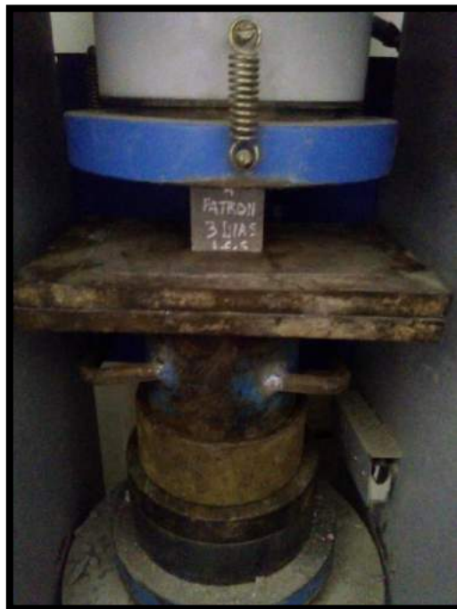
Foto 19: Realizando el ensayo de Resistencia a la compresión
