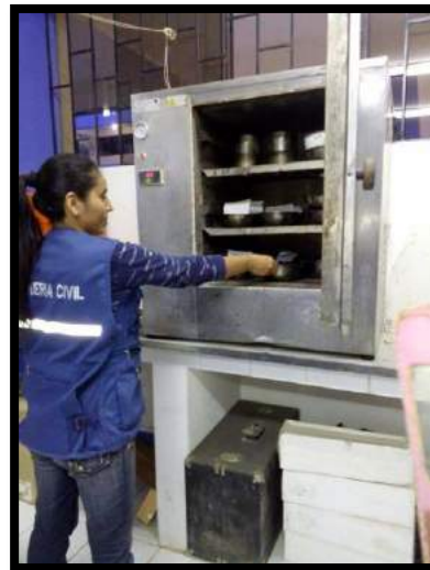
Foto 9: Se observa la introducción de ambas muestras al horno a 110°C por 24 horas.
