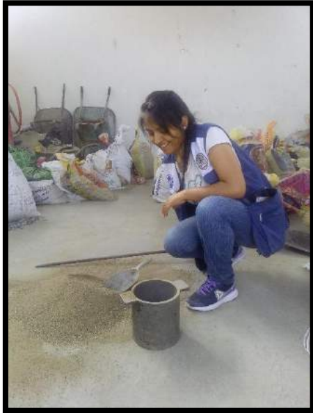
Foto 10: Se muestra el llenado del recipiente con el agregado fino
