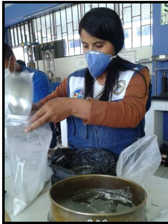
Foto 5: En la imagen se muestra que una vez calcinado el caparazón de caracol se pasa por la malla # 200
