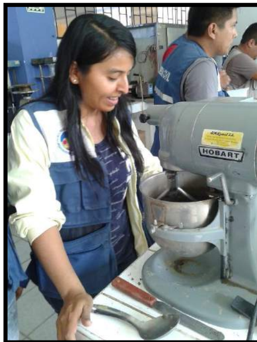
Foto 15: Preparando la Mezcla para el ensayo de Fluidéz.
