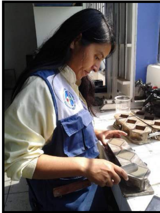
Foto 18: Realizando el enrasado
