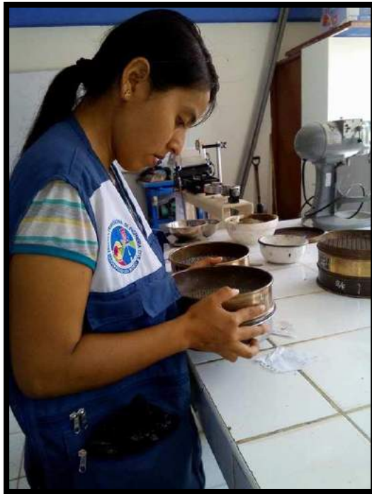
Foto 12: Se está realizando el ensayo de granulometría
