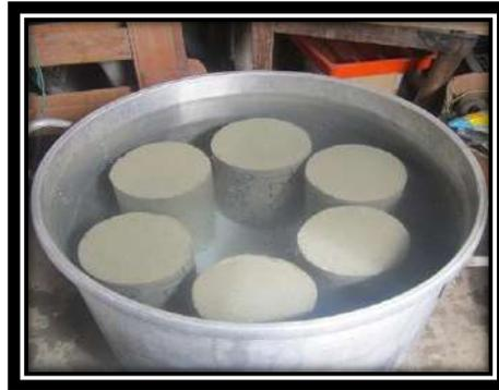
**Foto N° 56:** Se realiza el curado de probetas, para luego hacer la resistencia a la compresión a los 7 y 28 días.
