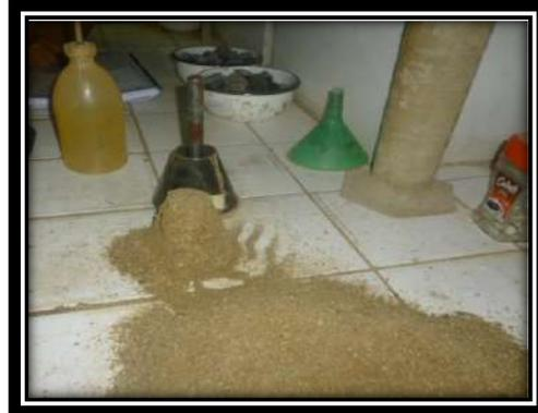
**Foto N° 37:** Arena en óptimas condiciones de humedad.
