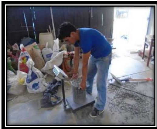
**Foto N° 17:** Pesando el molde + el agregado grueso
