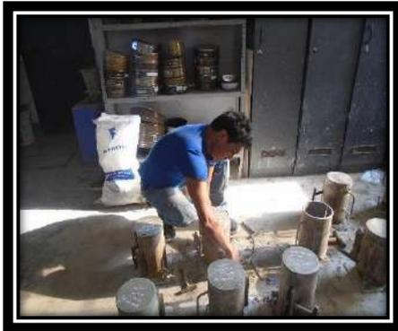
**Foto N° 55:** desencofrando las probetas.
