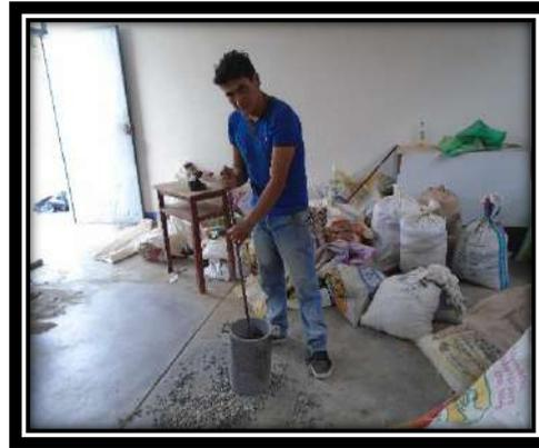
**Foto N° 19:** Después de llenar la primera parte del molde, se chucea 25 veces.
