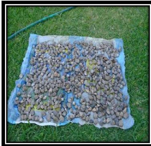
**Foto N° 07:** Secado del agregado grueso de la cantera Santa Rosa
