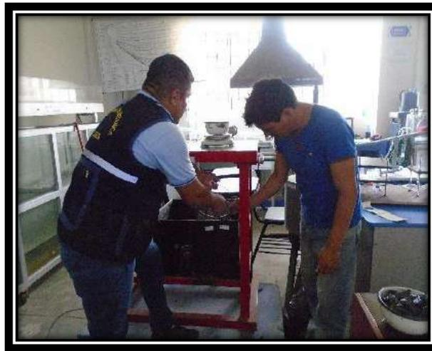
**Foto N° 24:** Tomar el peso de la muestra sumergida en la balanza hidrostática.
