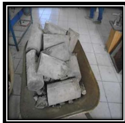
**Foto N° 59:** Ensayos de la resistencia a la compresión a los 7 y 28 días de las probetas patrón.
