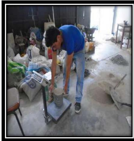
**Foto N° 33:** Procediendo a pesar el molde + muestra.
