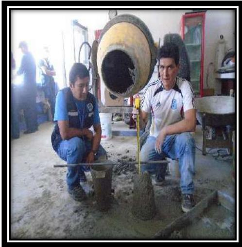
**Foto N° 47:** Haciendo prueba de slump (Cono de Abrams).
