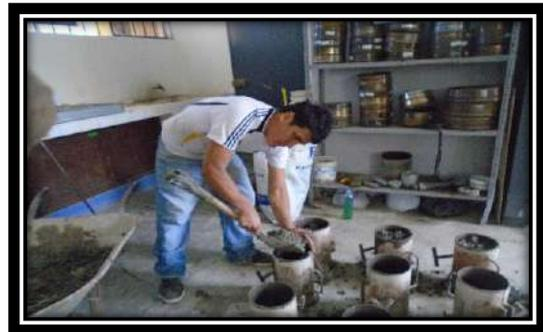
**Foto N° 50:** vaciando la mezcla a las probetas.
