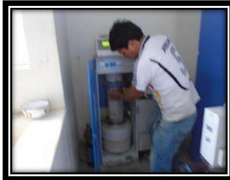
**Foto N° 58:** Ensayos de la resistencia a la compresión a los 7 días de las probetas patrón
