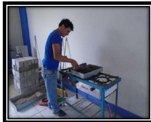
**Foto N° 35:** Se secará la muestra saturada hasta obtener una
