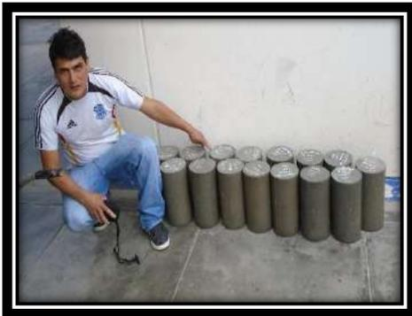
**Foto N° 57:** probetas listas para el ensayo a la compresión.
