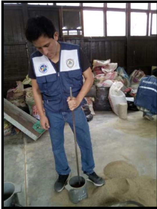
FOTO N° 12. Realizando el Peso Unitario Compactado
