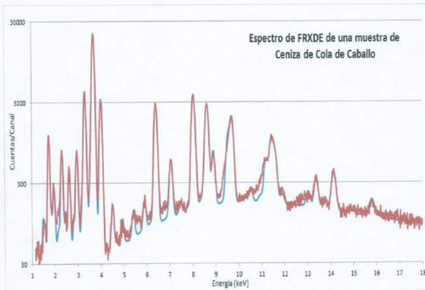
Figura 1. Espectro de FRXDE de una muestra de ceniza de cola de caballo en escala semi logarítmica. Incluye el pico de Ar del aire y los picos de rayos-X de Au dispersados por la muestra. La curva en azul muestra el espectro simulado
