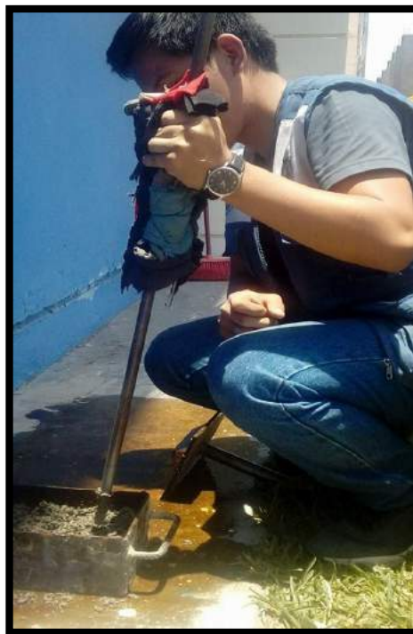
FOTO N° 19. Elaboración sin Mesa Vibratoria, Chuseado de la Mezcla (Dosificación 2)
