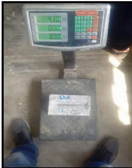
FOTO N° 34. Pesaje de los Ladrillos
