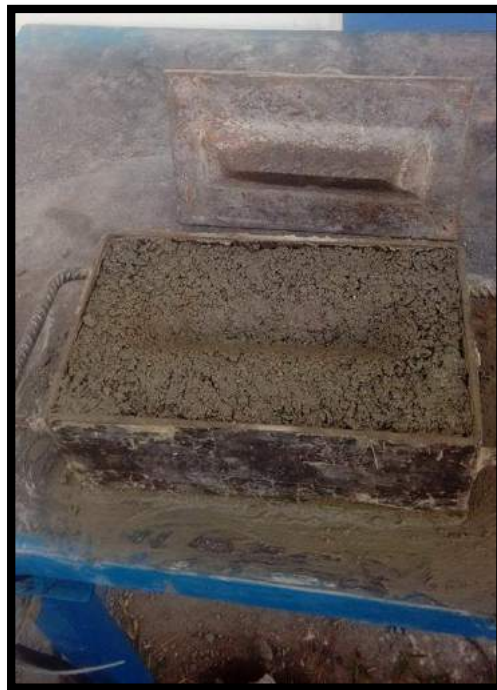
FOTO N° 15. Elaborando Ladrillo en la Mesa Vibratoria
