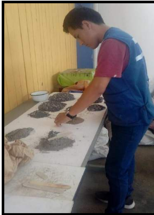
FOTO N° 13. Dosificación de Materiales En diferentes Pesos
