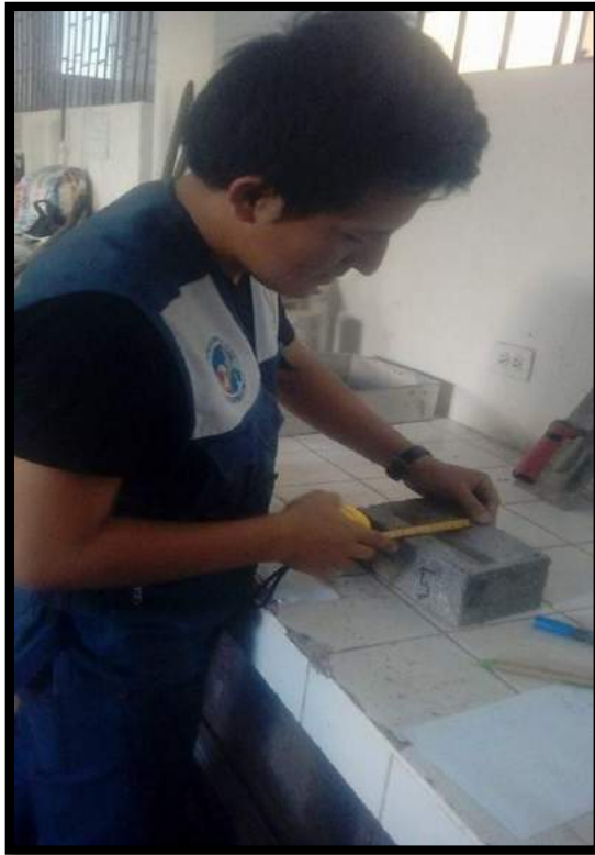
FOTO N° 33. Medición de los Ladrillos
