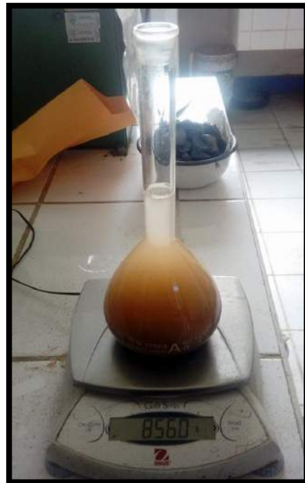
FOTO N° 9. Eliminando Vacíos en la Arena Gruesa
