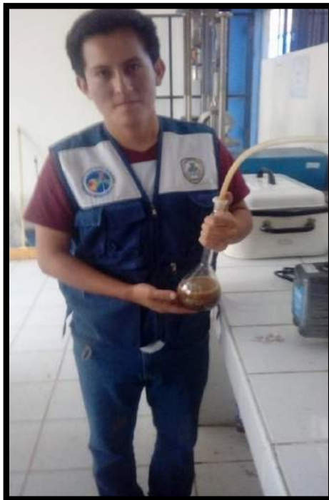
FOTO N° 9. Eliminando Vacíos en la Arena Gruesa
