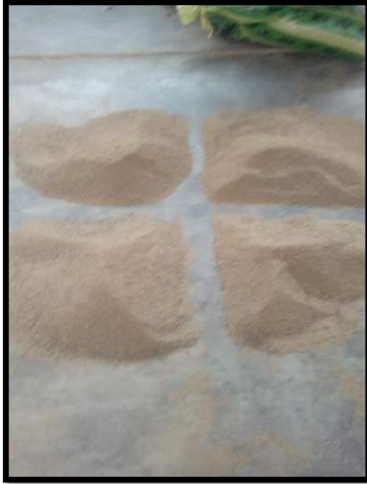
FOTO N° 3. Cuarteo del Agregado Fino (Arena Gruesa)
