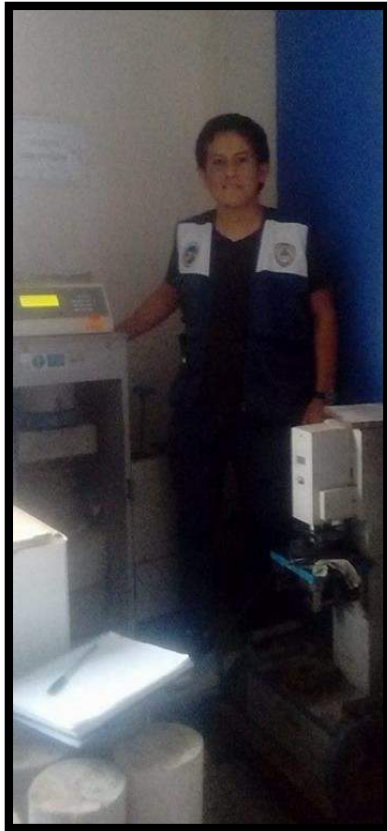
FOTO N° 35. Ensayo a la Compresión de Ladrillos
