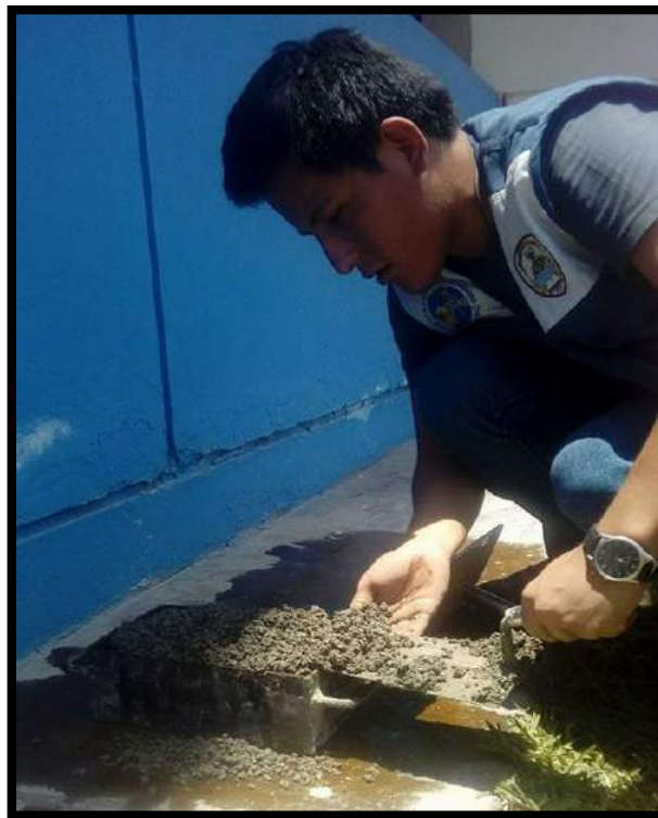
FOTO N° 21. Llenado de la última capa del Ladrillo.
