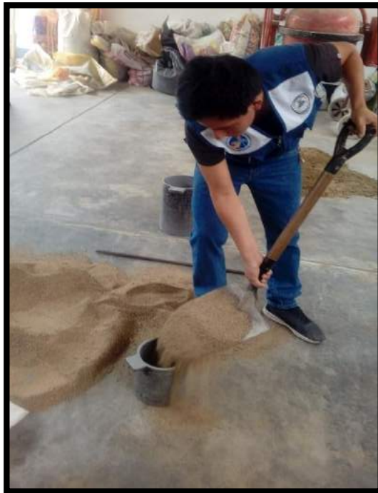
FOTO N° 11. Realizando el Peso Unitario Suelto
