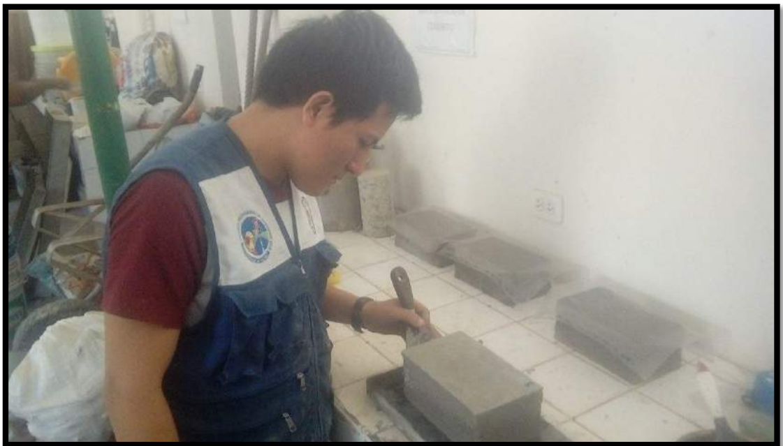
FOTO N° 32. Nivelación y Capping de Yeso-Cemento
