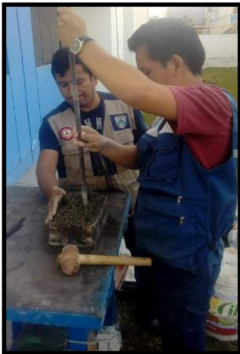
FOTO N° 15. Elaborando Ladrillo en la Mesa Vibratoria
