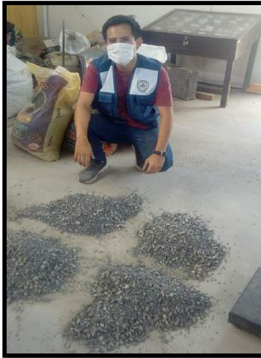
FOTO N° 4. Cuarteo de Agregado Grueso (Confitillo)
