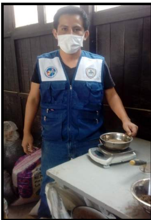
FOTO N° 6. Pesaje de Retenidos en las Mallas
