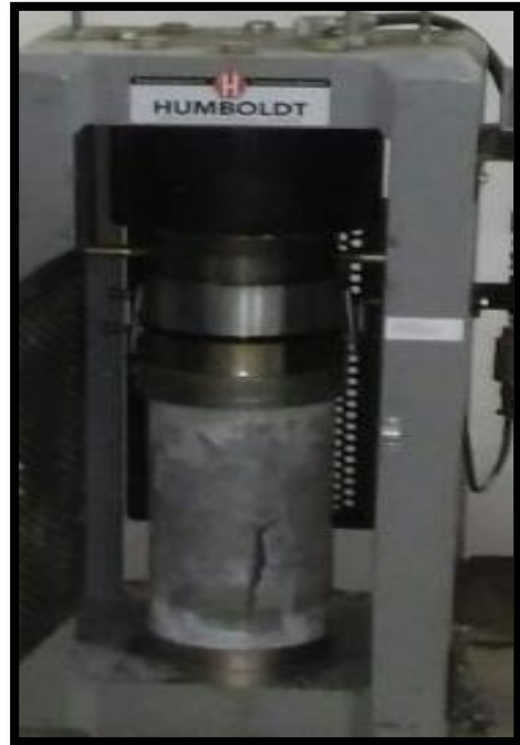
Figura 28: Ensayo a la compresión de probetas cilíndricas.
