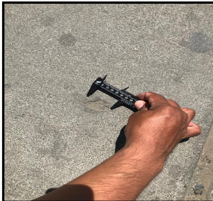
Figura 14: Tomando la dimensión de un vacío en el pavimento.
