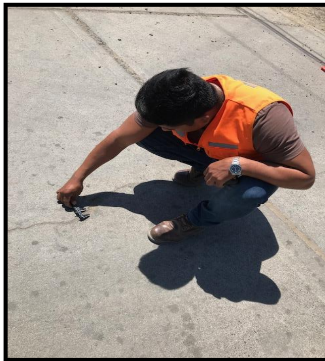
Figura 10: Midiendo las fallas con el vernier
