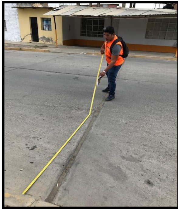
Figura 23: Midiendo la dimensión de la junta de una de las vías.
