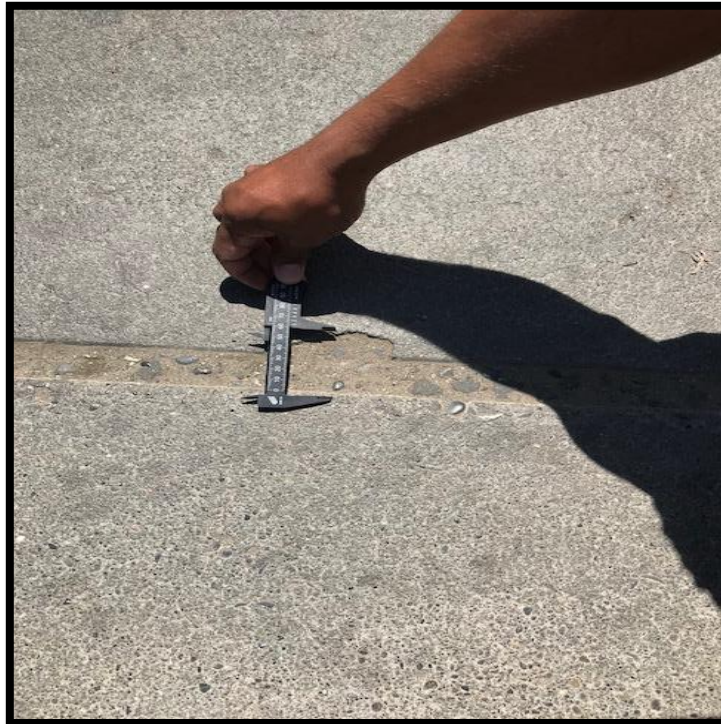
Figura 13: Midiendo la junta con el vernier.
