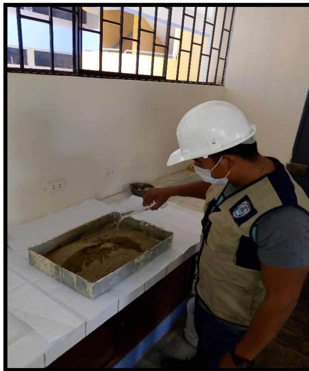
Figura 34: Agregando los diferentes porcentajes de agua a la muestra.
