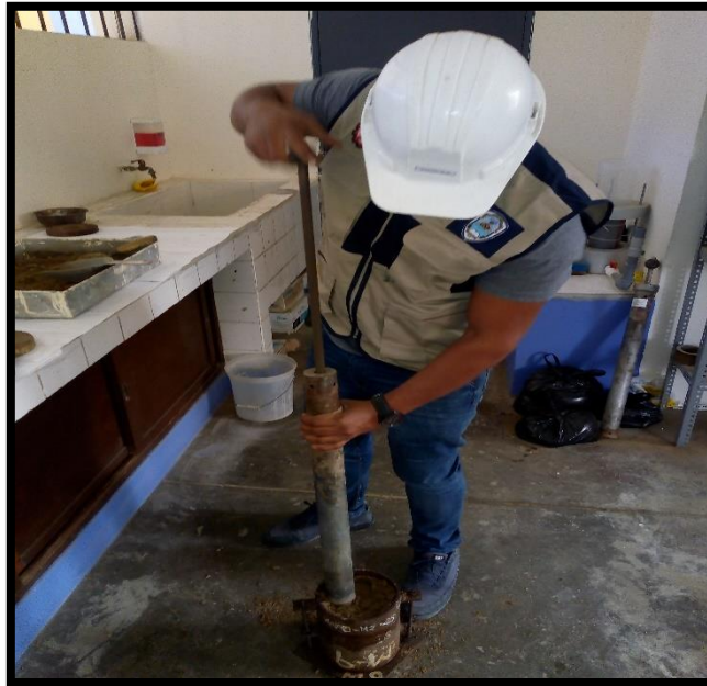
Figura 35: Compactando la muerta en los moldes de CBR.
