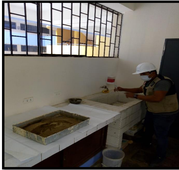
Figura 33: Preparando las muestras para el ensayo de proctor.
