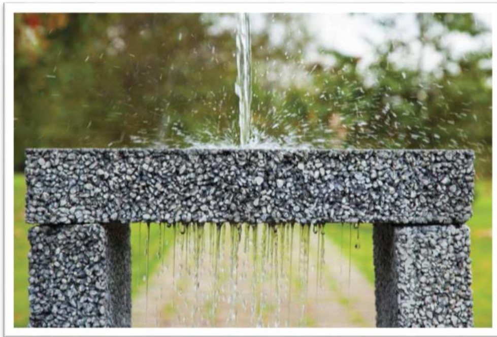
Figura N° 002: Influencia de la precipitación en el pavimento permeable. (www.argos.com.co) octubre 2014. Fuente: Revista ARGOS.
