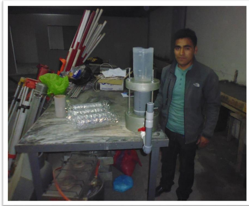
Figura N° 017: Permeámetro de carga variable para medir la permeabilidad. Fuente: Elaboración propia.
