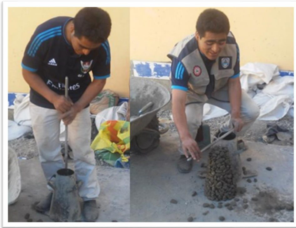
Figura N° 011: Determinación del Slump del concreto permeable. Fuente: Elaboración propia.
