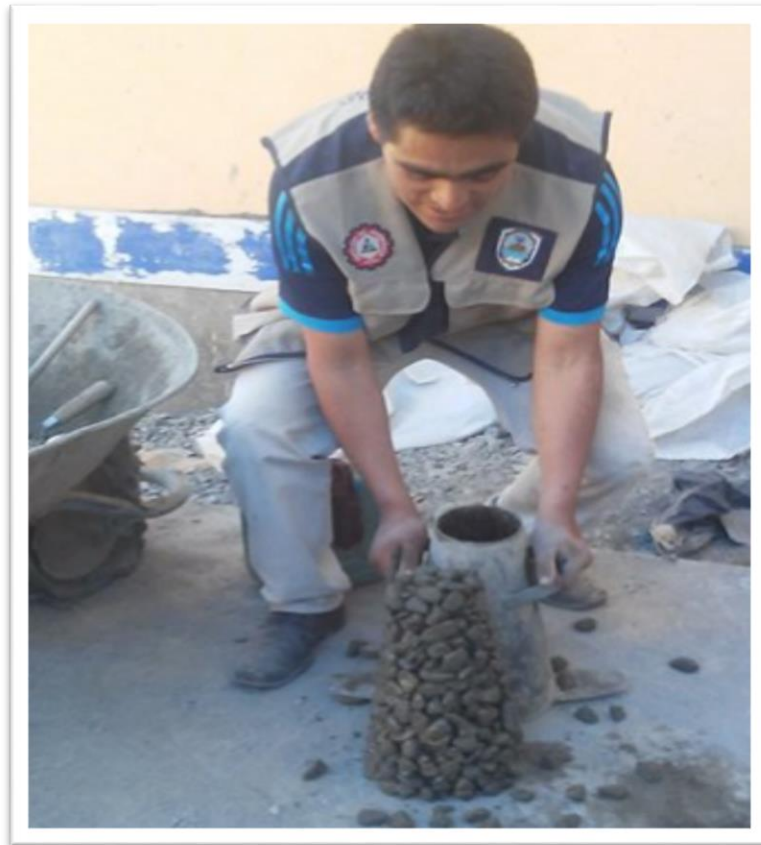
Figura 021: Revenimiento cero de la mezcla de concreto permeable de \frac{3}{4} .
