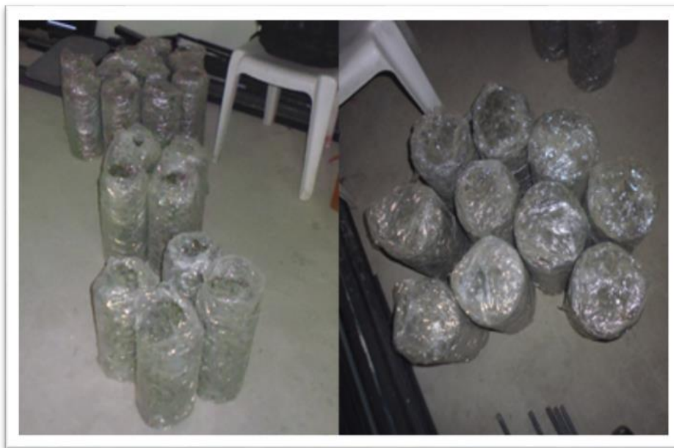
Figura N° 004: Curado de los especímenes de concreto laboratorio mecánica de suelos-USP.
