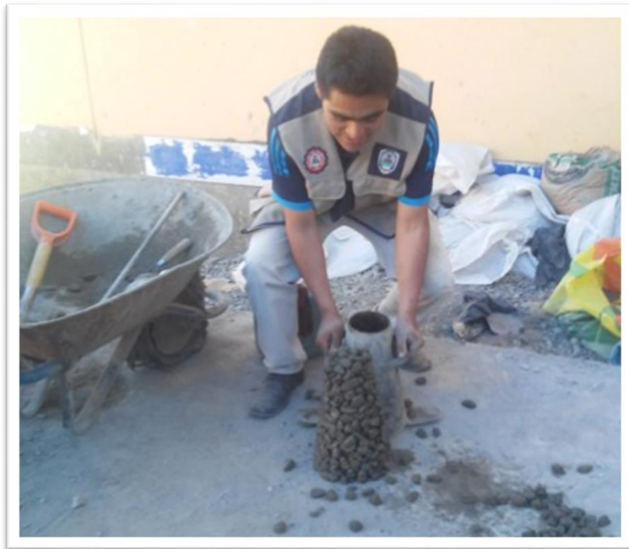
Figura N° 012: Determinación del slump del concreto permeable. Fuente: Elaboración propia.
