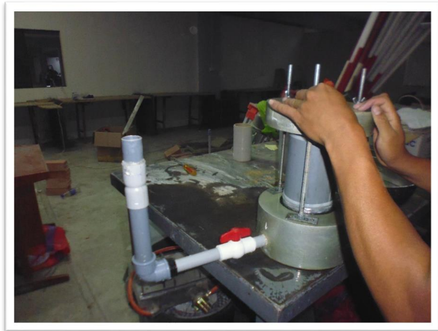
Imagen. 11 Se observa la saturación de la muestra para la prueba de infiltración.
