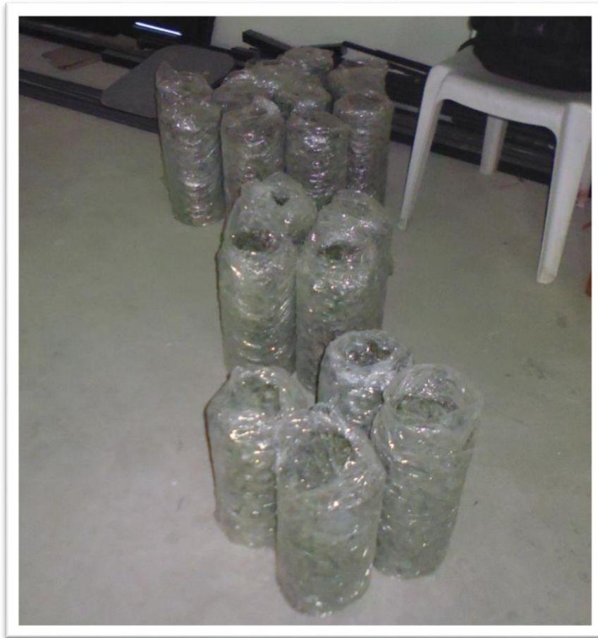
Figura N° 014: Curado de cilíndricas de concreto permeable según Norma (ACI 522, 2006). Fuente: Elaboración propia.
