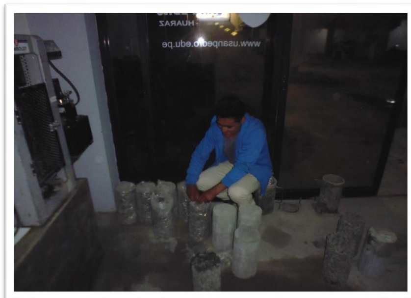
Imagen. 08 Se observa el curado de las muestras de concreto.
