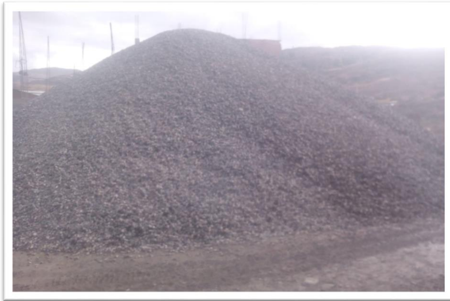
Figura N° 008: Agregado grueso (piedra chancada o triturada). Cantera Quechcap. Fuente: Elaboración propia.
