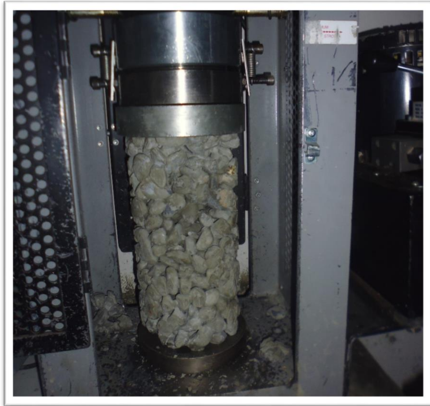
Imagen. 09 Se observa la resistencia a la compresión de probetas.
