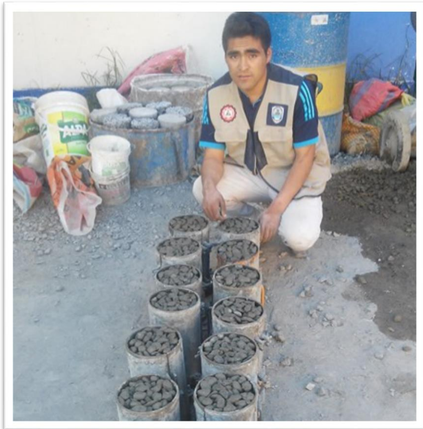
Imagen. 07 Se observa la elaboración de probetas.
