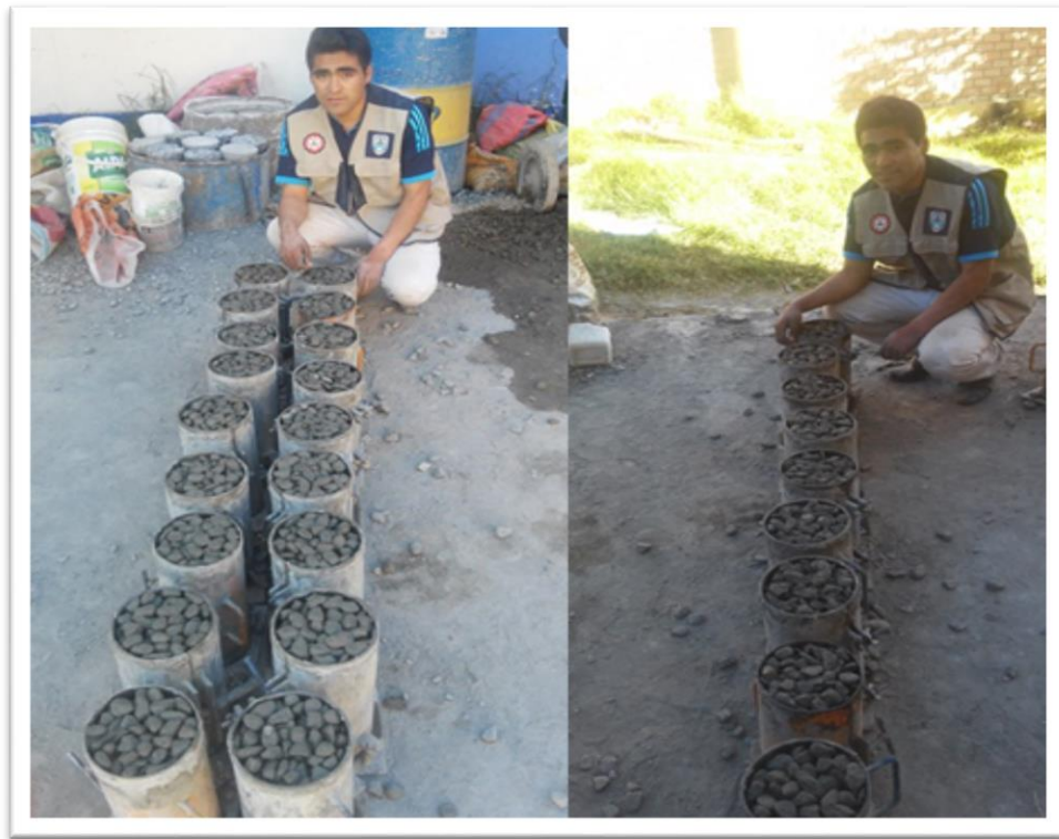
Figura N° 013: Elaboración de probetas cilíndricas de concreto patrón, experimental 01 y experimental 02.
