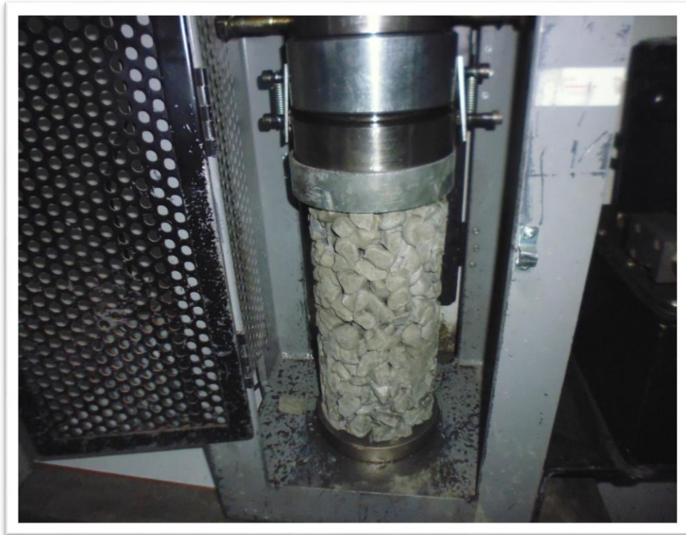
Figura 015: Resistencia a la compresión de un concreto poroso laboratorio de mecánica de suelos -USP.
