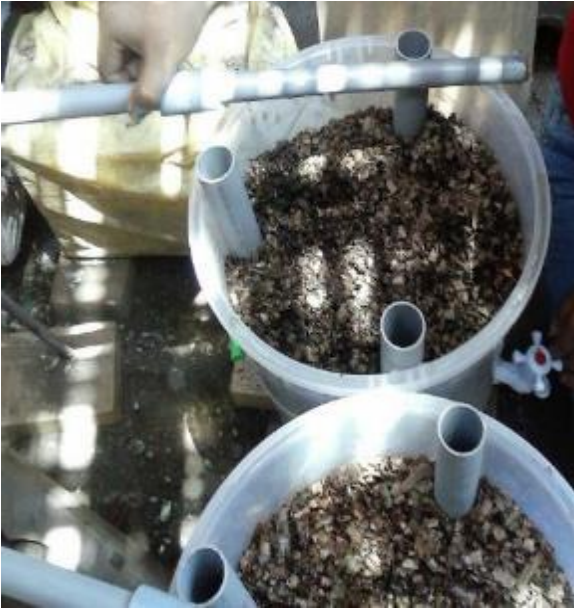
Vista en planta de los biofiltros; notandose los tuyos de ventilacion a los extremos pegados en las paredes, siendo un biofiltro dinamico aeróbico
