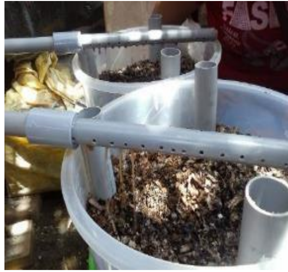
Vista de la alimentacion con agua residual a los dos biofiltros de lombrices
