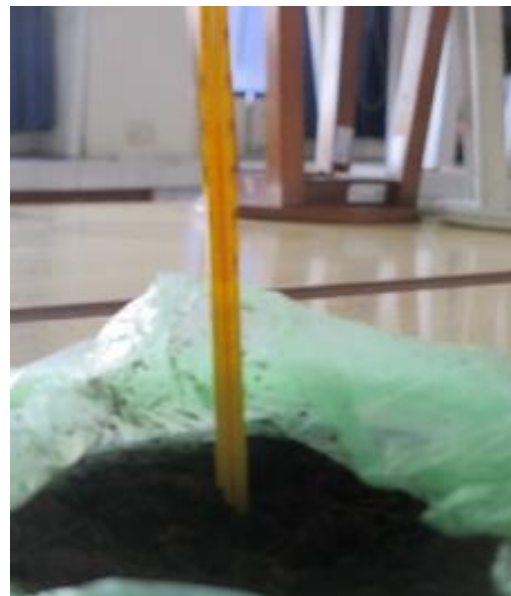
Medicion de temperatura del estiércol vacuno, para ser utilizado como alimento provisional de las lombrices
