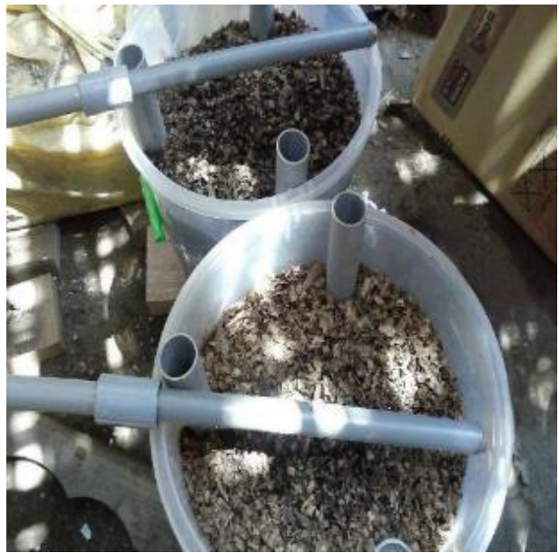
Vista en planta de los biofiltros; notandose los tuyos de ventilacion a los extremos pegados en las paredes, siendo un biofiltro dinamico aeróbico
