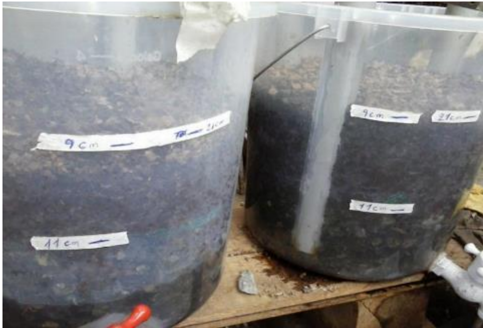
Vista frontal de los biosfiltros de lombrices, notadonse las capas y proceso del tratamiento
