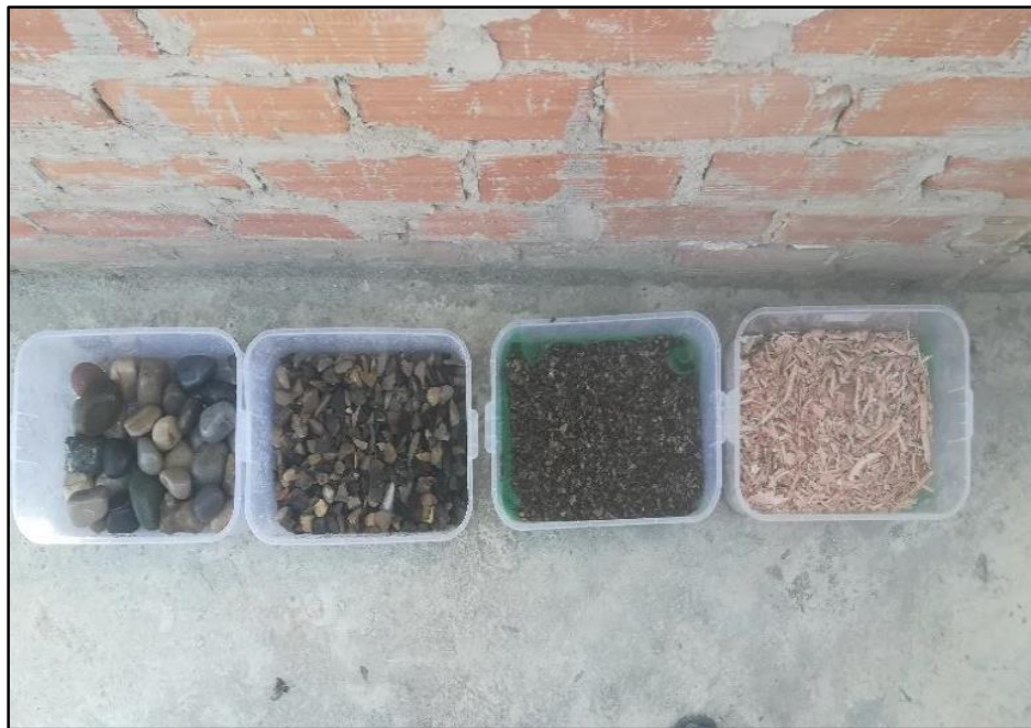
Vista de los materiales que van a conformar las capas del biofiltro
