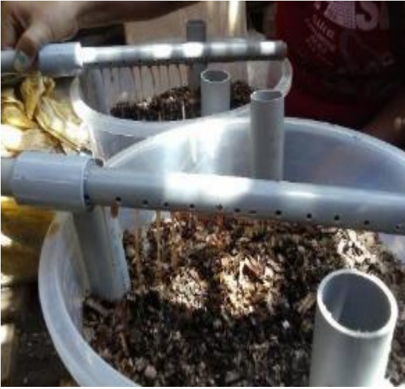
Vista de la alimentacion con agua residual a los dos biofiltros de lombrices
