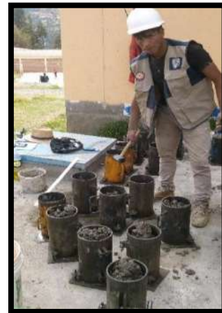
Figura 26: eliminación de los poros con varilla y martillo Fuente: Elaboración propio.
