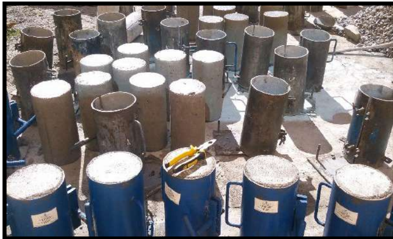
Figura 29: Pasado las 24 horas listo para el desencofrado con sustitución de ceniza y el concreto patrón
