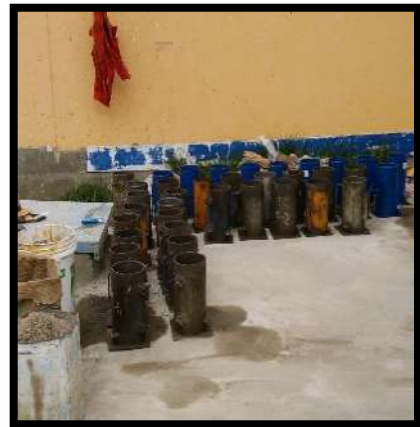
Figura 24: Los moldes bien asegurados y engrasado Fuente: Elaboración propio.
