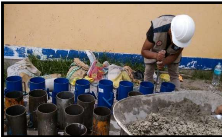
Figura 26: eliminación de los poros con varilla y martillo Fuente: Elaboración propio.
