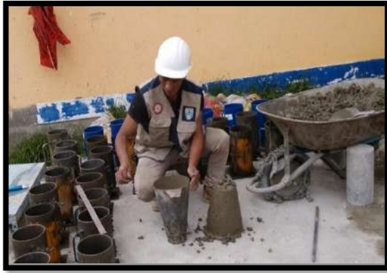
Figura 23: Determinación del revenimiento del concreto Fuente: Elaboración propio.
