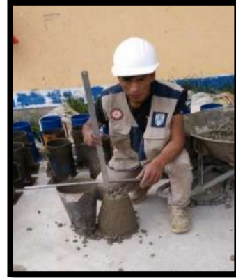
Figura 23: Determinación del revenimiento del concreto Fuente: Elaboración propio.
