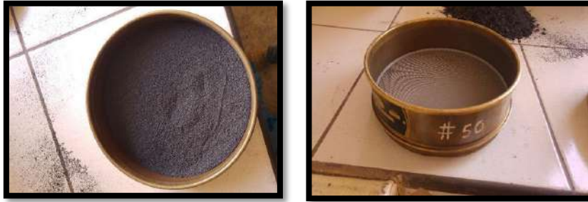
Figura 09: tamizado del material obtenido por la malla N°50 en el laboratorio de Mecánica de Suelos y Ensayos de Tecnología de materiales
