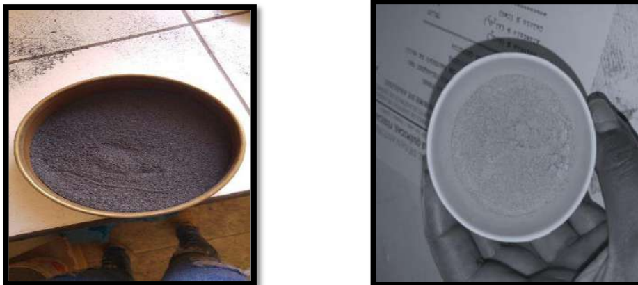
Figura 10: La etapa de quemado de la ceniza de la caña de maíz en el laboratorio de mecánica de suelos y ensayos de materiales universidad san pedro los pinos
