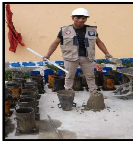
Figura 25: Los moldes bien asegurados y engrasado lugar Shancayan el USP. Fuente: Elaboración propio.
