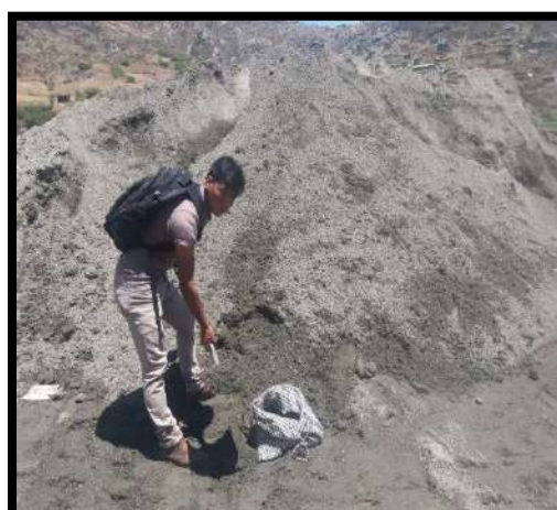
Figura 15: El llenado del agregado fino para el traslado
