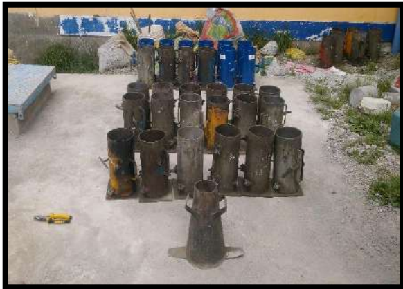
Figura 24: Los moldes bien asegurados y engrasado Fuente: Elaboración propio.
