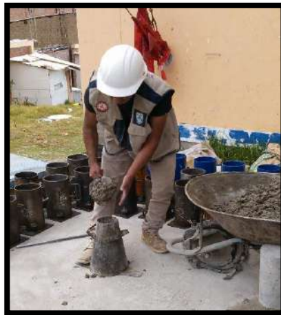
Figura 21: Realización el llenado de la mezcla por capa
