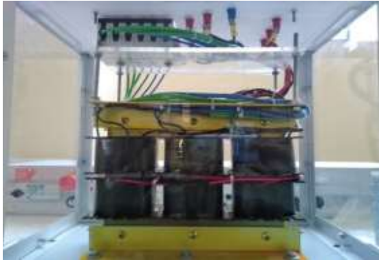
Figura 5. Transformador trifásico .del Laboratorio de Máquinas eléctricas de la UNS. Fotografiado por el autor.
