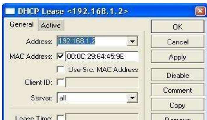
**Figura 28:** Pestaña de asignación de direcciones IP
