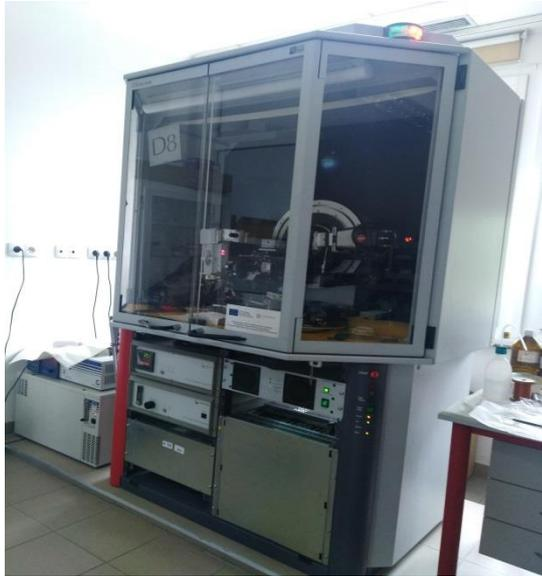
**Figura 23. Análisis de Difracción de rayos X en polvo (PXRD).**
